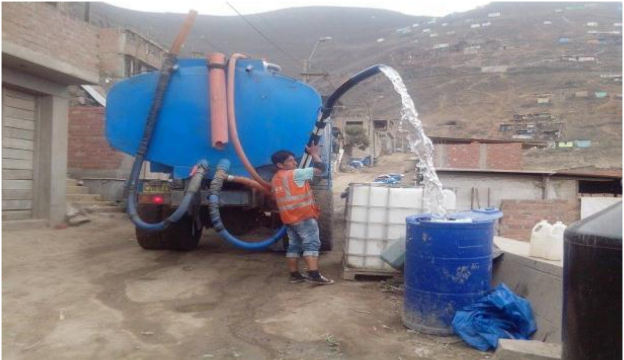
Figura 1.2. Cisterna que abastece agua potable a las viviendas en laderas
