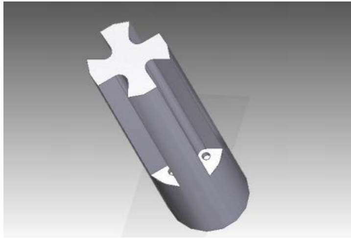
Figura 3.44. Cilindro general del aerogenerador savonius
