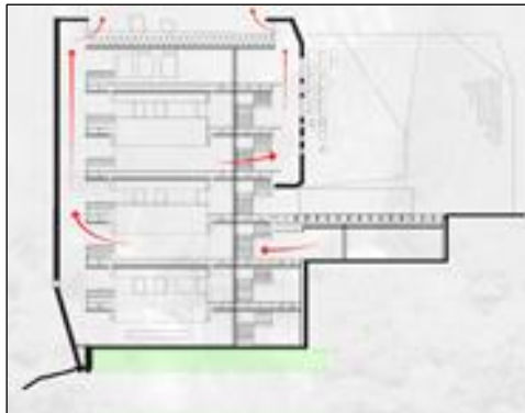
Imagen 073: Ventilación natural en un bloque
