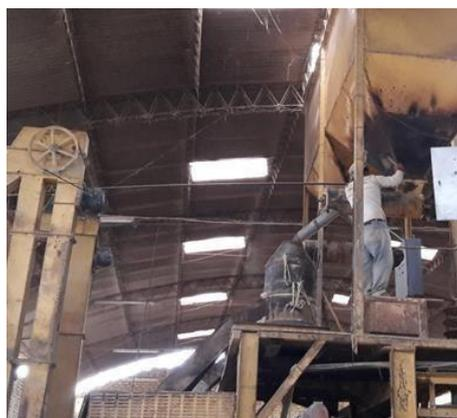
Figura 35: Maquinista ubicado en parte superior maquina peletizadora
