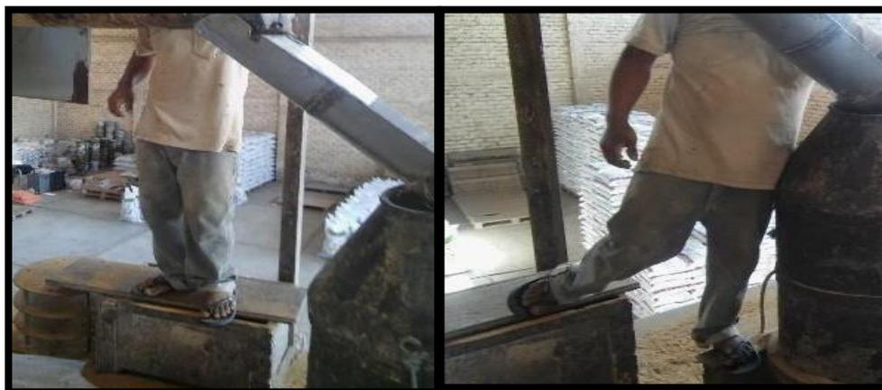
Figura 22: Postura disergonómica del trabajador por falta de plataforma de trabajo
