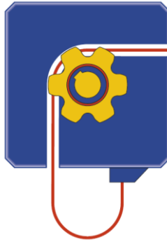
Figura 22. 90° Carcasa con miembros en el extremo. Fuente: Primera edición, revisión B. SERAPID 09-2001
