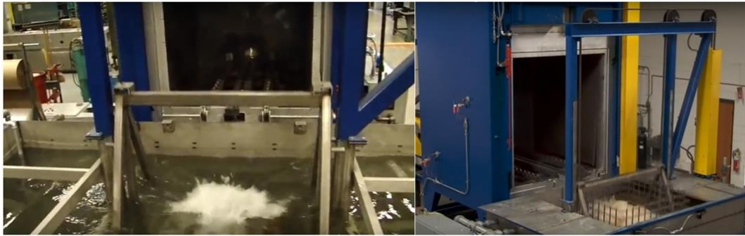
Figura 7. Enfriamiento de piezas en la poza de enfriamiento
