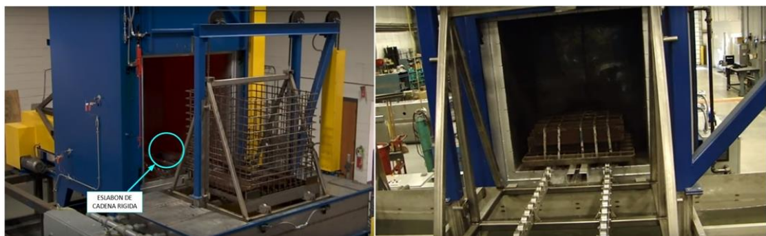
Figura 6. Arrastre de la carga mediante Cadena Rígida
