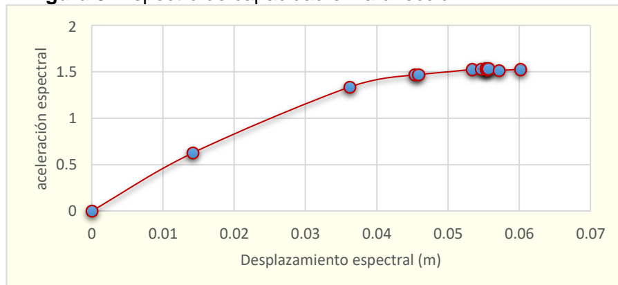
Figura 3: Espectro de capacidad en la dirección X-X
