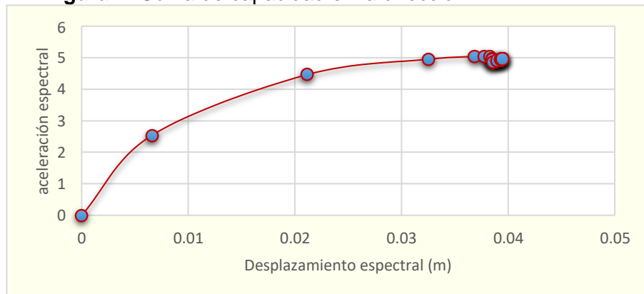
Figura 2: Curva de capacidad en la dirección Y-Y
