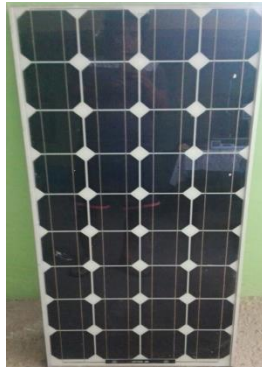
Panel fotovoltaico Monocristalino, marca MP Solar, de 80Wp, 18 Vmp y 5 A Isc.
