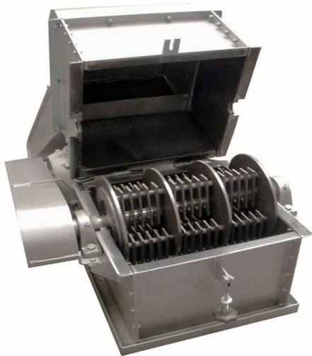
Estructura muy robusta para trabajos pesados, un cuerpo bipartido con bisagras y clamps, tolva de carga con compuerta dosificadora, 20 martillos intercambiables, criba intercambiable, tolva de descarga de producto y portamartillos sobre eje con chumaceras reforzadas. Tienen buena ventilación en su interior y su diseño permite una fácil y rápida limpieza del equipo.
