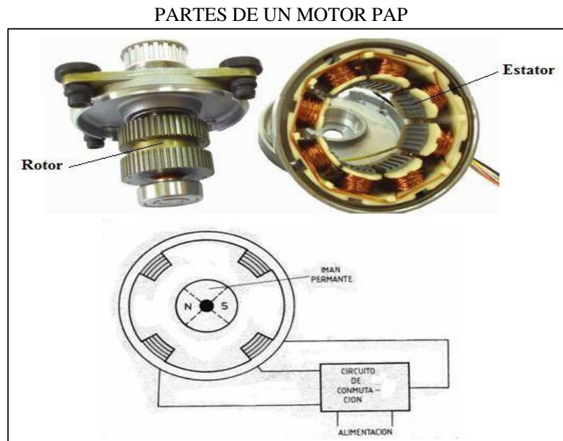
Figura 25: PARTES MOTOR PASO A PASO
