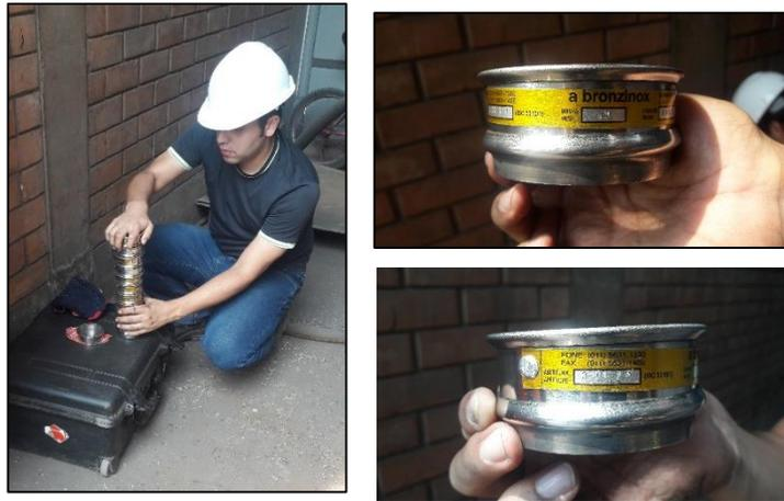
Figura N° 27 Tamizado de Abrasivo.
