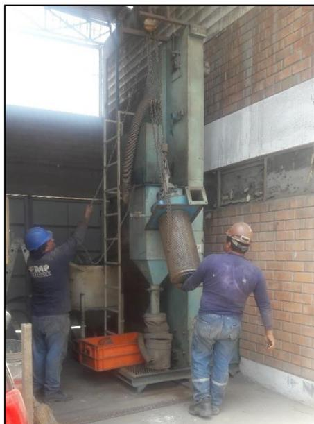
Figura N° 28 Cambio de Filtro de Aire.
