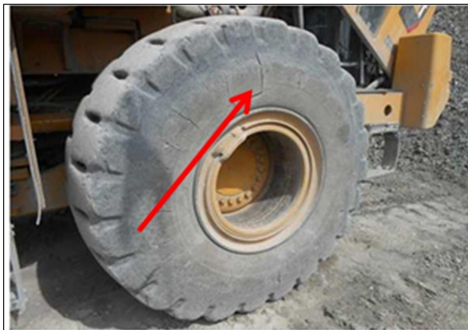
Figura 62. Llanta delantera lado derecho con cortes
