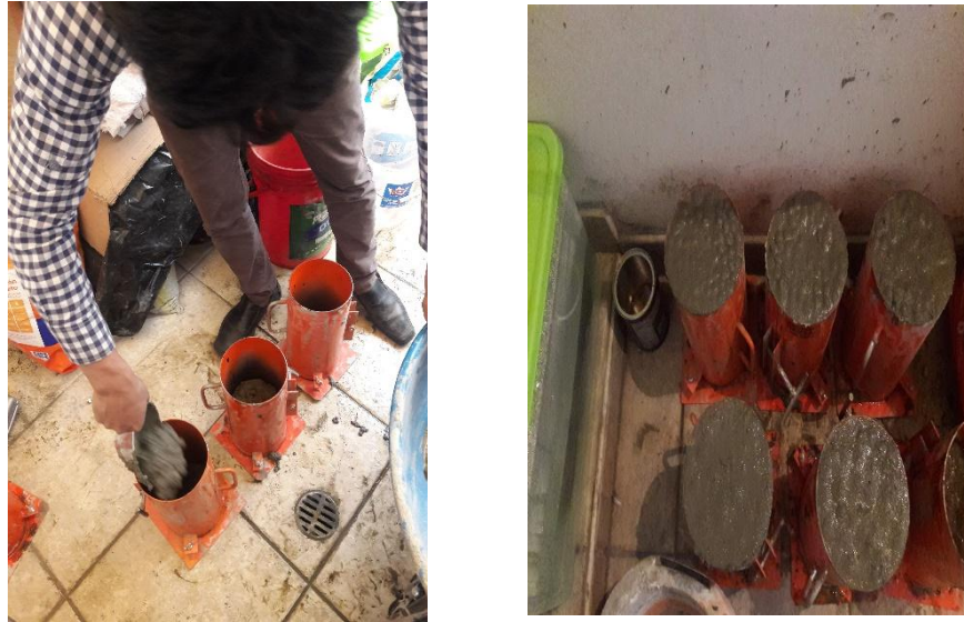
Figura 18. Moldes de probetas enrasadas
