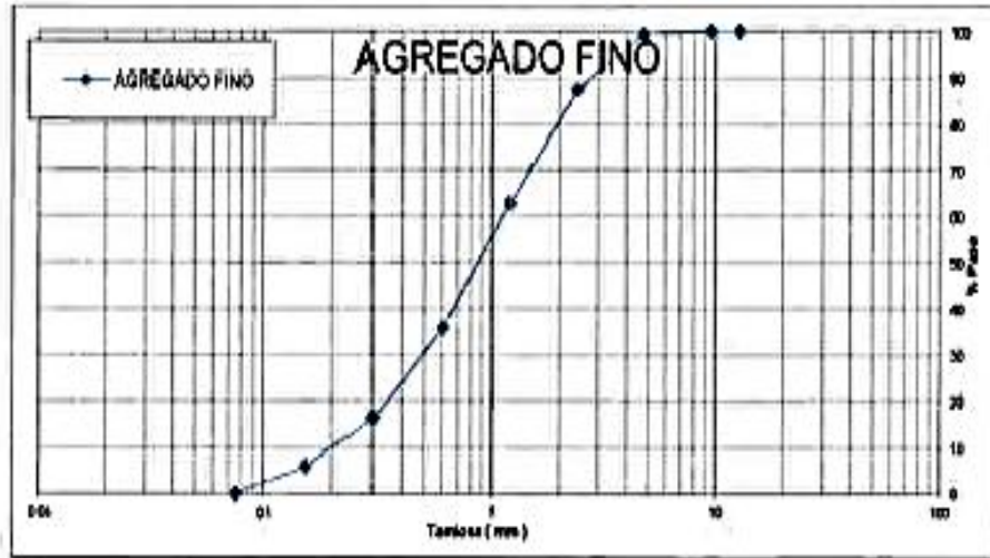
Figura 10. Curva de granulometría del agregado fino
