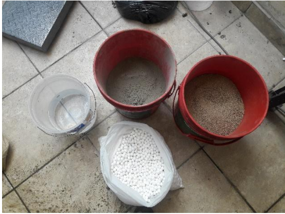
Figura 12. Imágenes de los agregados listos para el mezclado
