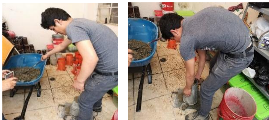
Figura 15. Asentamiento o slump de la mezcla
