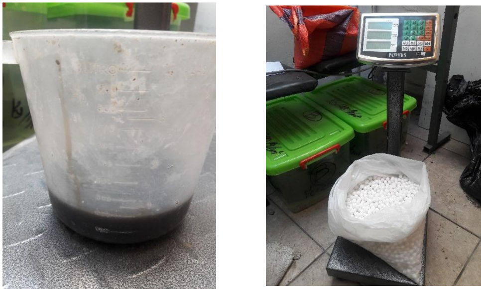
Figura 11. Imágenes del pesado de los agregados y aditivo
