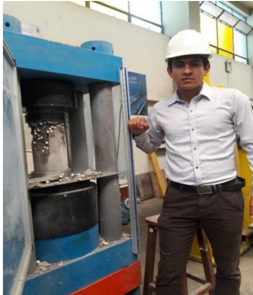
Figura 20. Ensayo de resistencia a la compresion del concreto.
