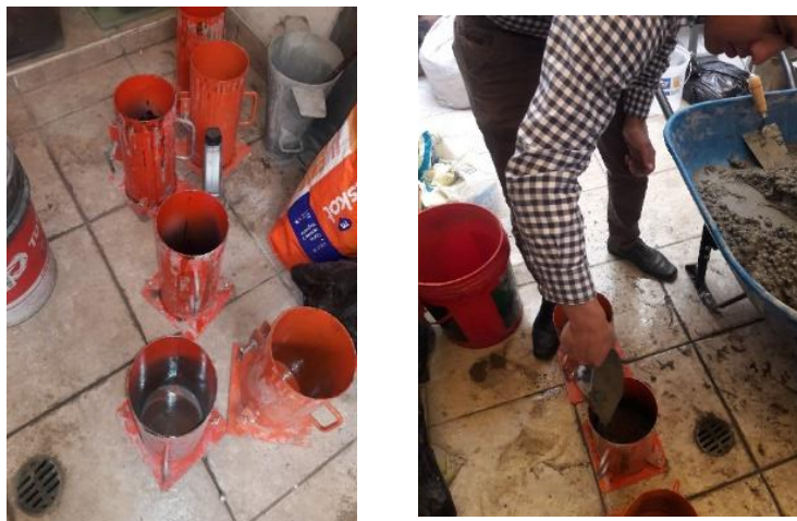
Figura 17. Imágenes del preparado de probetas
