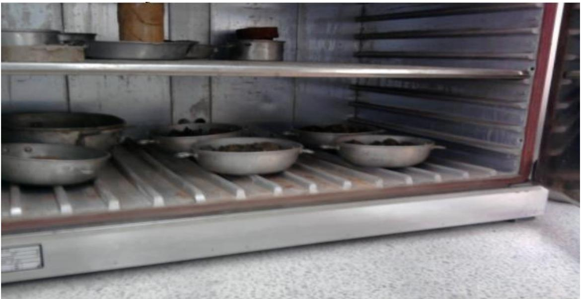
Se puede observar que la muestra húmeda fue colocada en la estufa para luego conocer el suelo en estado seco.
