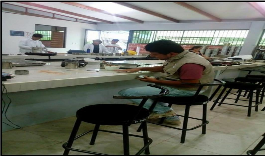
Se realiza la obtención del límite plástico con una masa trabajable, sobre una base de vidrios
