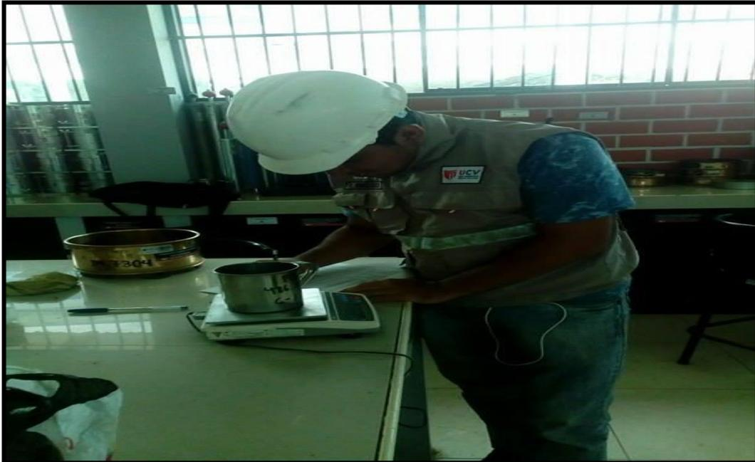
Se puede observar el respectivo peso de la muestra más la lata que luego se pondrá en el horno durante 24 horas.
