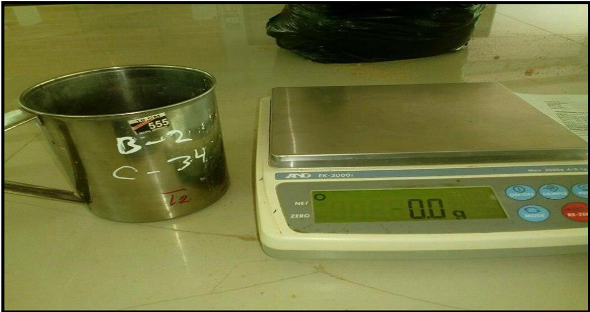
Se coloca la muestra en un tarro para luego ser pesado en una balanza.
