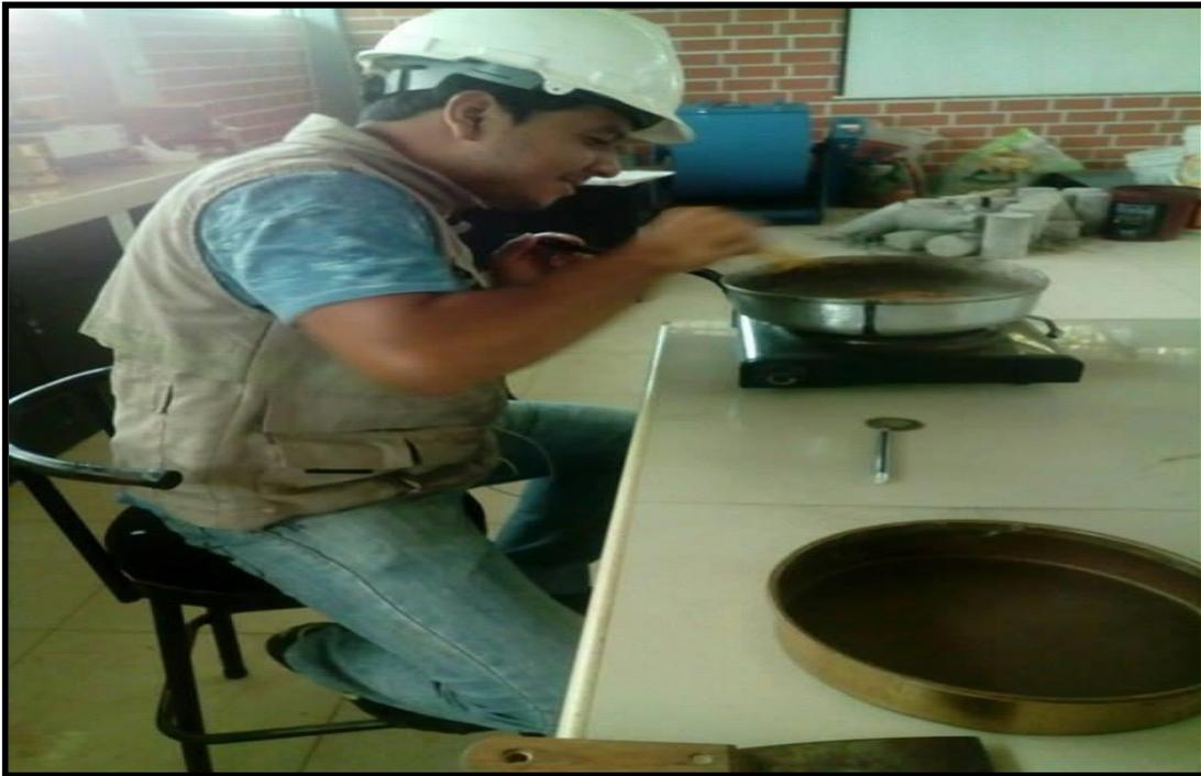
Se puede observar que una vez lavado y pasado la muestra por el tamiz N° 200 se realiza el respectivo secado.
