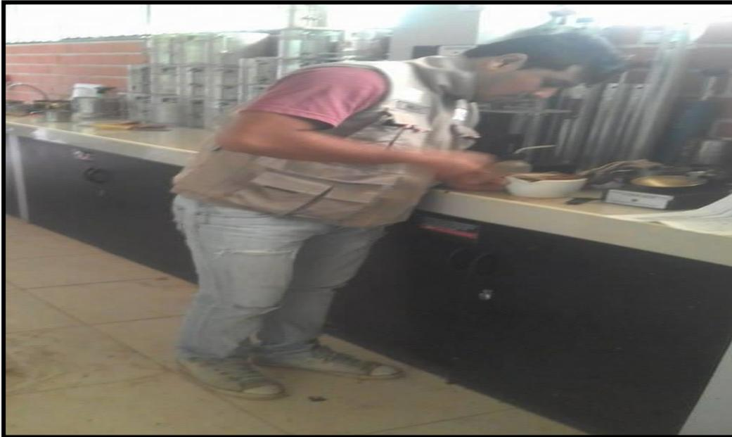
La muestra seca se pasa por el tamiz N° 40 y con el material que pasa la malla se trabaja colocándola en un mortero, se le coloca agua destilada hasta que se haga una masa trabajable y se coloca en la copa de Casagrande.
