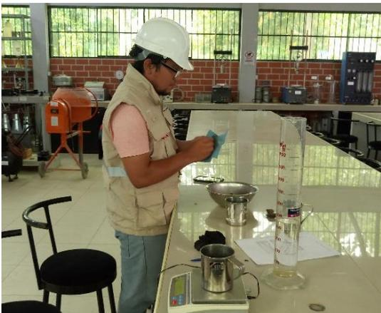
**Elaboración de las probetas de concreto no estructurado.**
