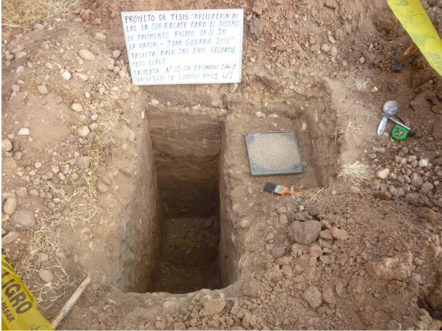
SE OBSERVA EL PERFIL ESTRATIGRAFICO DEL SUELO, CALICATA EXCAVADA N°01 – JR. LA UNION CDRA N°01-L/IZQ.
