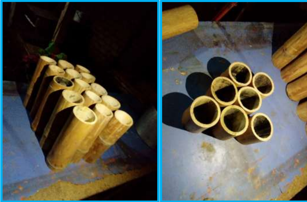
Fotografía 06: Muestras de bambú para los ensayos mecánicos y físicos.
