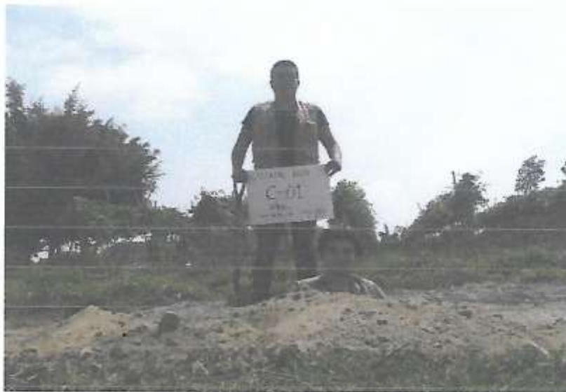
En la imagen se aprecia la realización de la calicata para la toma de muestra a una profundidad de 1.80 m
