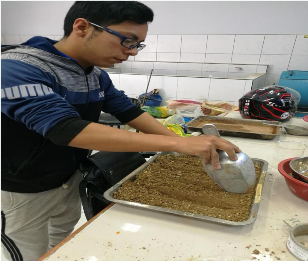
Foto 03: Se cuartea la muestra y se introduce en el molde en 5 capas
