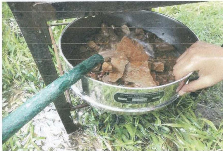
Realizar el lavado y eliminar las impurezas y materiales finos.
