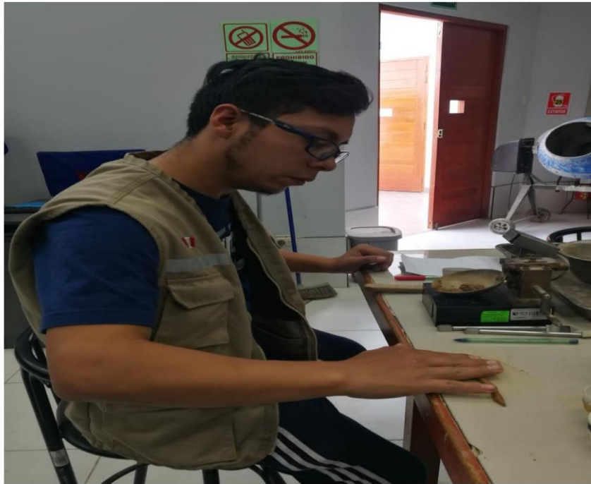
Foto 03: Realizando el limite plástico
