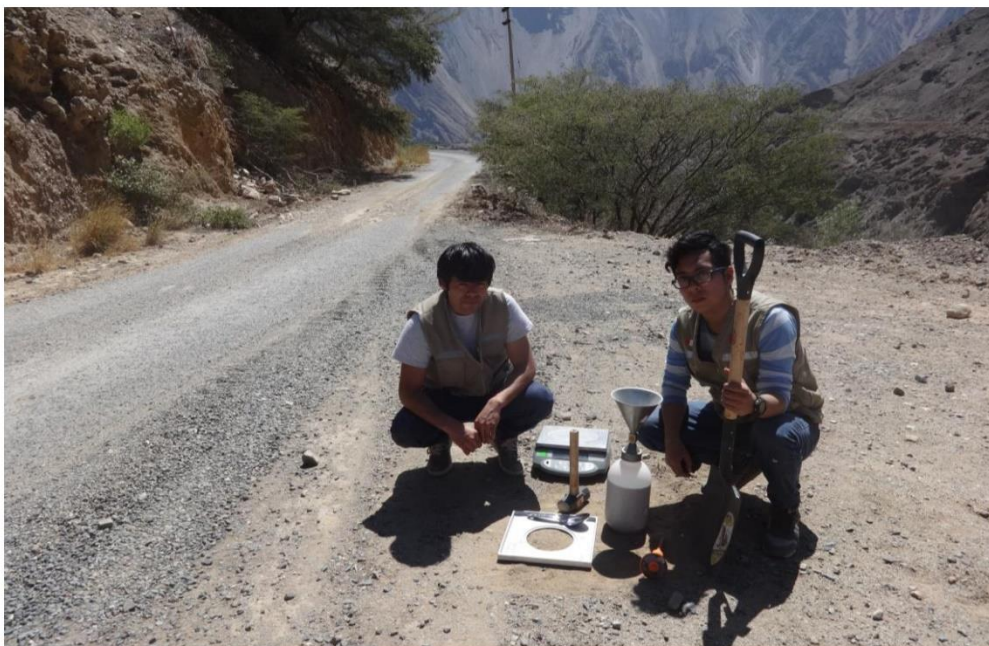
Foto 05: Se realizó el ensayo de densidad de campo
