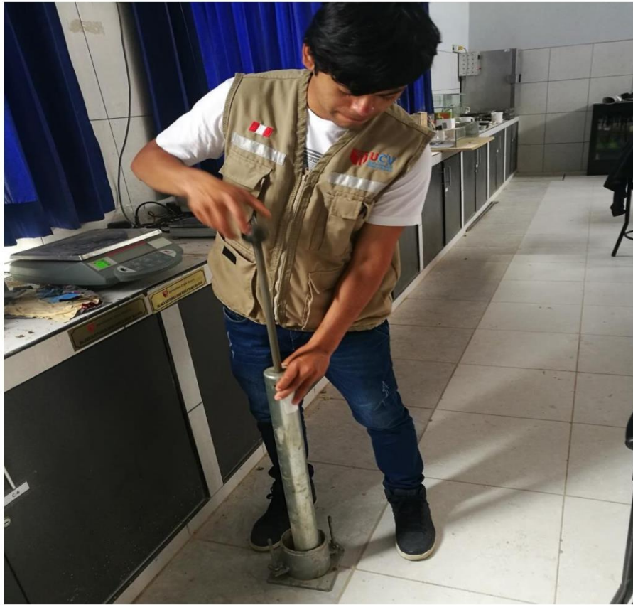
Foto 05: Se le realiza 25 golpes por capa
