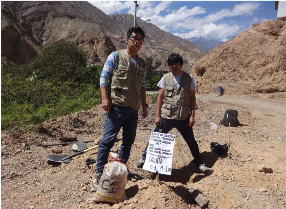
Foto 01: Excavación de calicata C-1 progresiva 0+000
