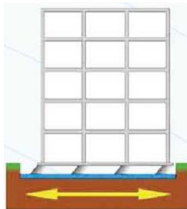
Figura: Estructura aislada sísmicamente
