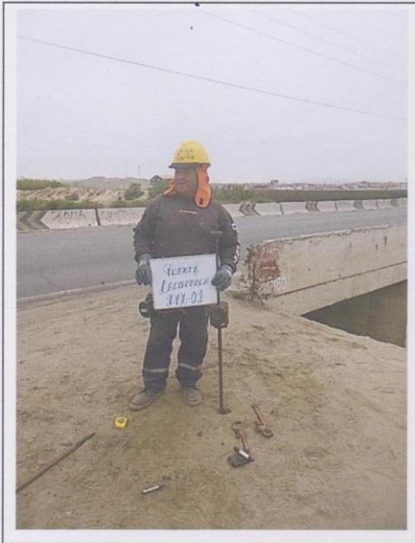
Foto N°03: Vista del DPL-01, De 0.00 a 1.90m de profundidad, presencia de arena mal graduada, con raíces, materia orgánica y bloques de roca. De 1.90m a 3.00m de profundidad presencia de arenas mal graduada (SP), muy suelta, húmeda a saturado de color beige claro a beige oscuro. De 3.00m a 6.40m de profundidad presencia de arenas mal graduada (SP), muy suelta a compacta, saturado de color beige oscuro El nivel freático se registró a los 2.30m de profundidad.
