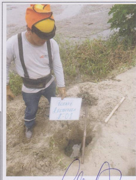
Foto N°02: Vista de la C-01, De 0.00 a 1.90m de profundidad presencia de arena mal graduada, con raíces, materia orgánica y bloques de roca. De 1.90m a 3.00m de profundidad, presencia de arenas mal graduada (SP), muy suelta, húmeda a saturado de color beige claro a beige oscuro. El nivel freático se registró a los 2.30m de profundidad.
