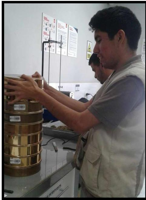
Figura 52. Colocación del material y empezar a zarandear.
