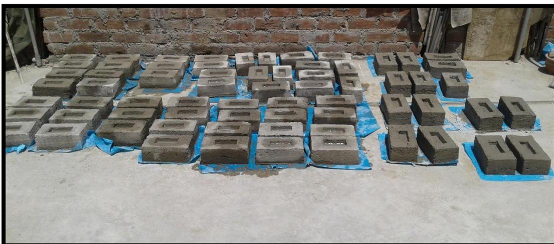
Figura 114. Ladrillos elaborados con 10% de CA y CCA y curado de los ladrillos de 0% y 5% de CA y CCA.
