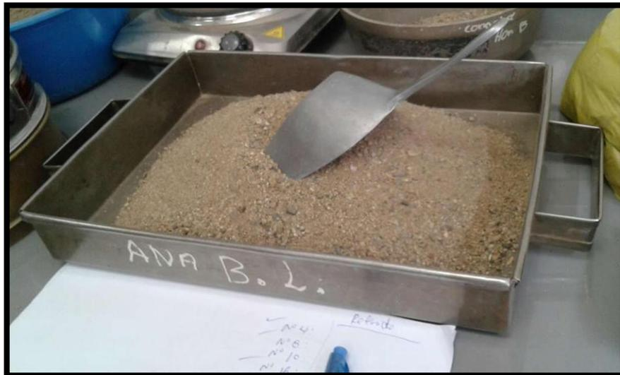
Figura 50. Colocamos el material sacado del horno a enfriar.
