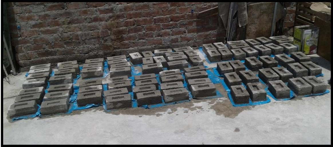
Figura 116. Curado de los ladrillos de 0%, 5%, 10% y 15% de CA y CCA.
