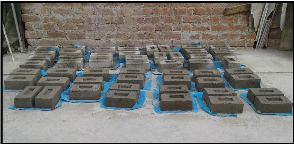
Figura 113. Ladrillos elaborados con 5% de CA y CCA y curado de los ladrillos de 0% de CA y CCA.
