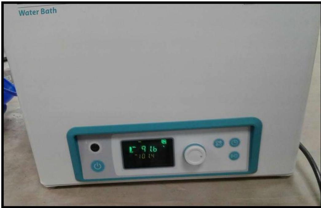
Figura 82. El baño no debe llegar a su temperatura mínima y se debe sacar las fiolas.
