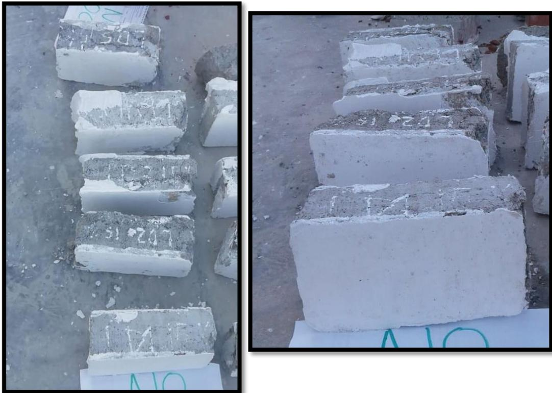
Figura 132. Ladrillos de 15% de CA y CCA después de haber sido ensayado a Compresión.
