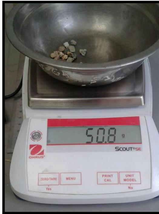
Figura 53. Se hace el pesaje del material retenido por tamiz.
