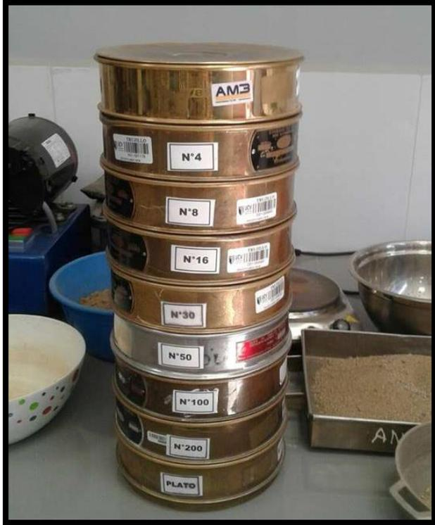
Figura 51. Colocación de los tamices.
