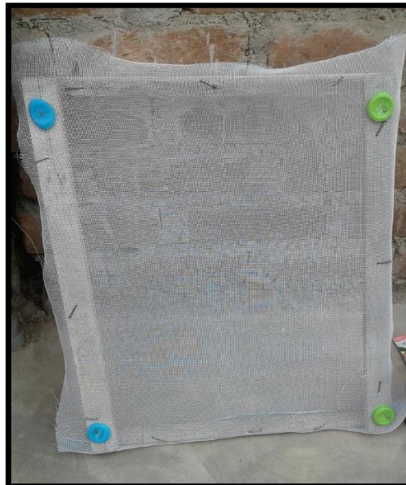
Figura 97. Malla utilizado para zarandear el agregado.
