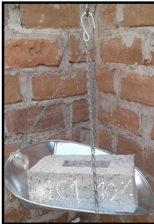
Figura 136. Ensayo de Peso de los ladrillos de 10% de CA y CCA.
