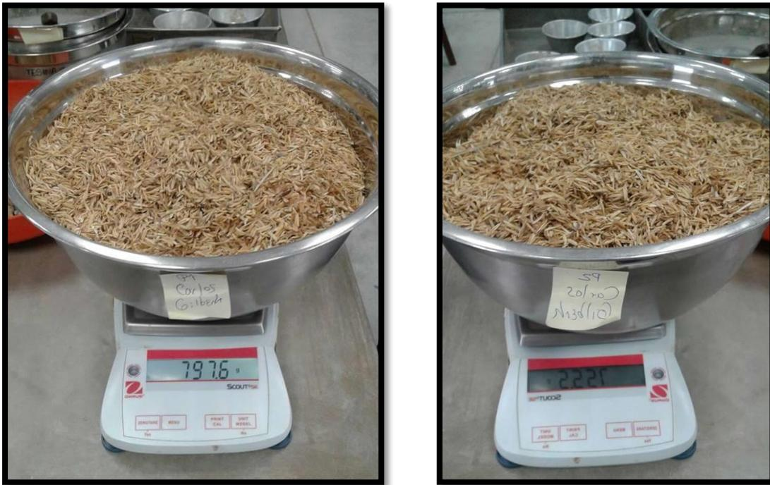
Figura 90. Pesado de la CCA sacado del horno.
