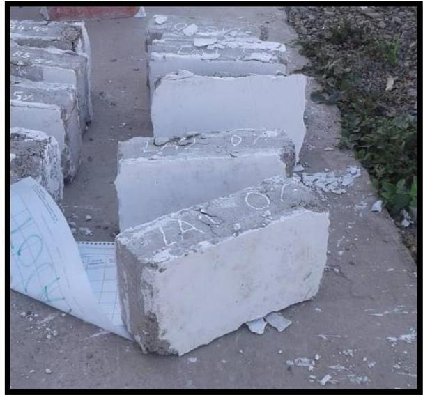
Figura 129. Ladrillos de 0% de CA y CCA después de haber sido ensayado a Compresión.
