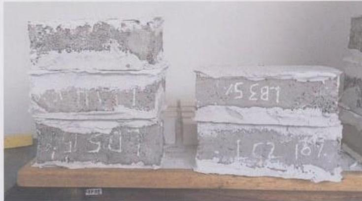
Figura: Bloques de concreto macizo capeados con yeso.
