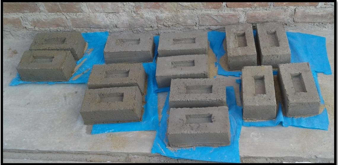
Figura 112. Ladrillos elaborados con 0% de Cáscara de Arroz y Ceniza de la Cáscara de Arroz.
