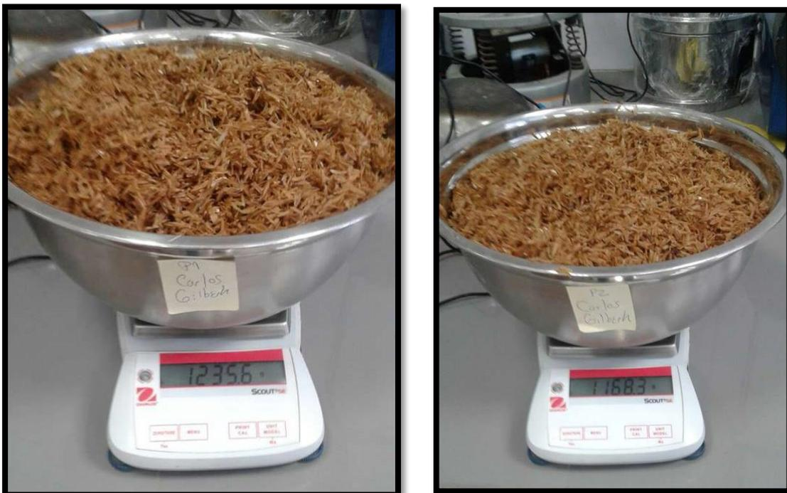
Figura 89. Pesado de la CCA (Secado superficial) y se coloca en el horno.
