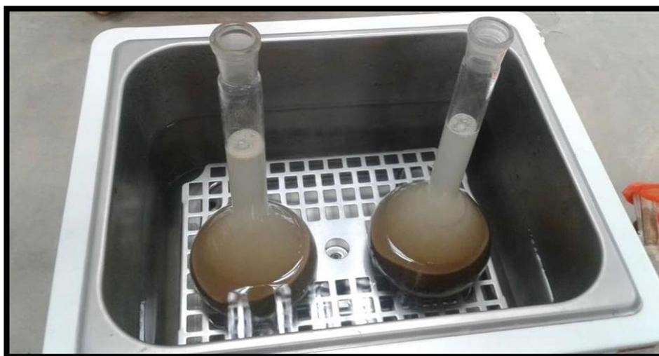
Figura 81. Se coloca las fiolas dentro del baño maría hasta eliminar vacíos.
