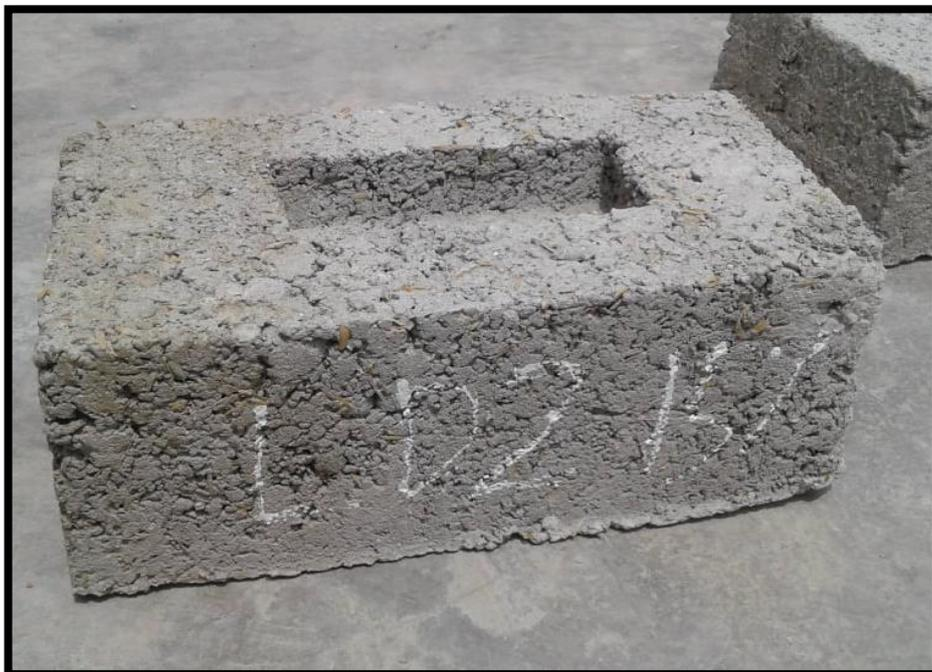
Figura 142. Ensayo de Eflorescencia de los ladrillos de 15% de CA y CCA.
