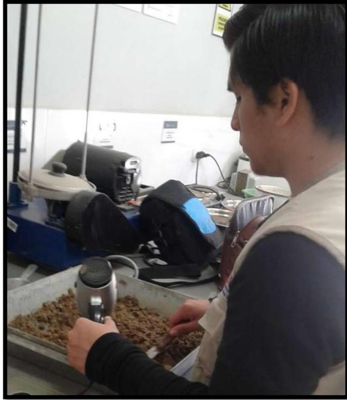
Figura 74. Secado del material saturado (Secado superficial).
