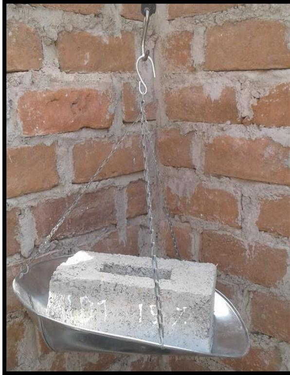
Figura 137. Ensayo de Peso de los ladrillos de 15% de CA y CCA.
