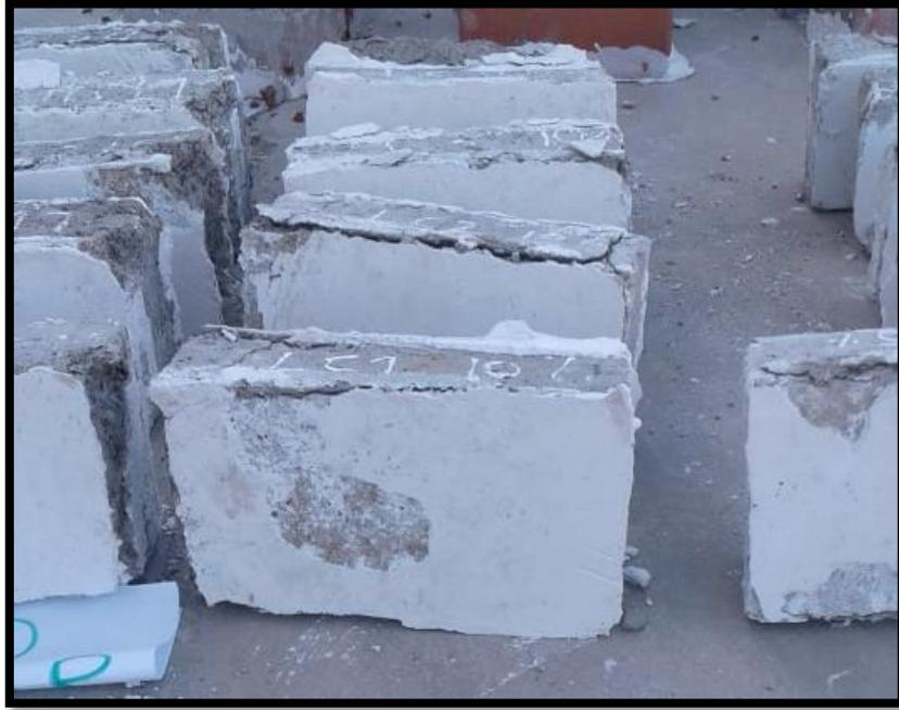
Figura 131. Ladrillos de 10% de CA y CCA después de haber sido ensayado a Compresión.
