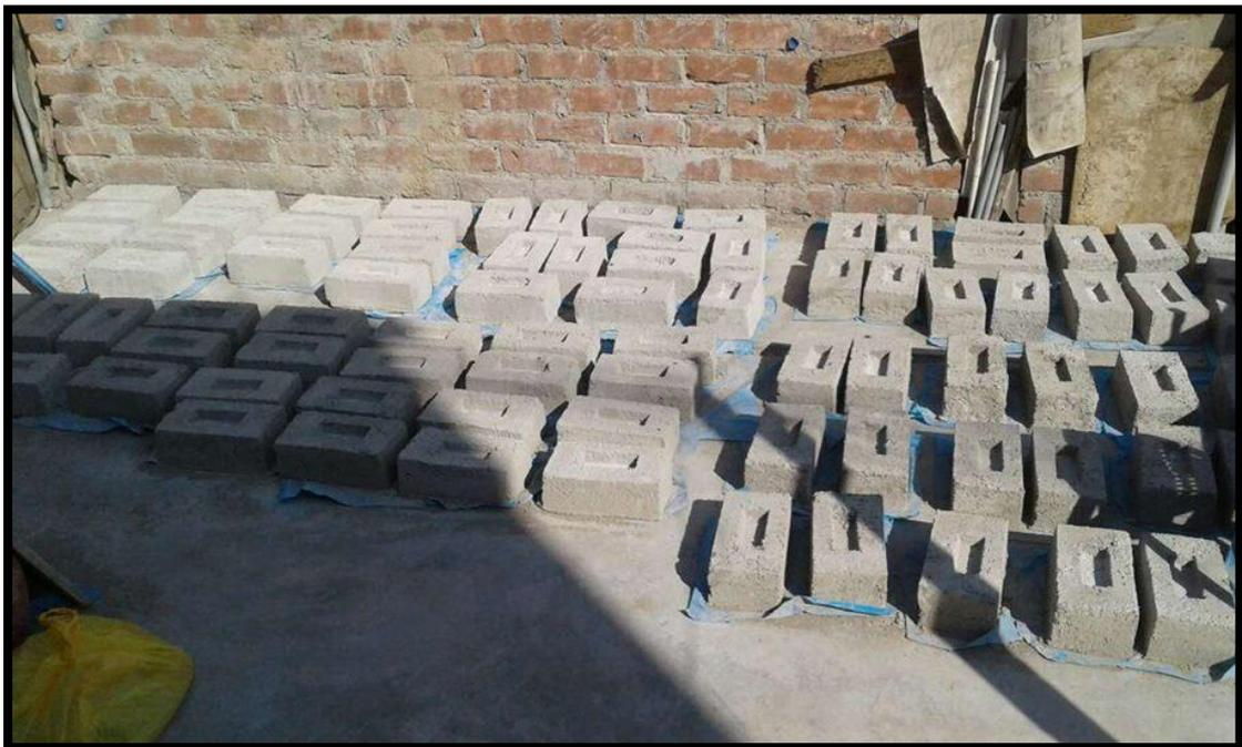
Figura 117. Secado de los ladrillos de 0%, 5%, 10% y 15% de CA y CCA.
