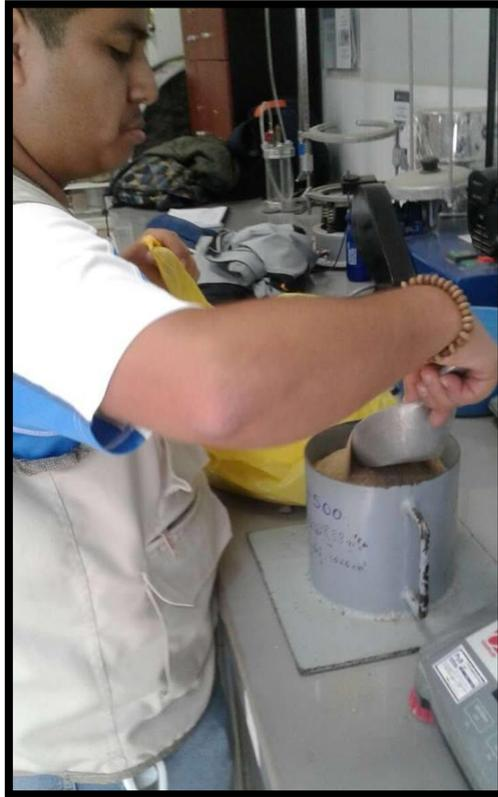
Figura 55. Llenado del recipiente con el agregado (Peso Unitario Suelto).
