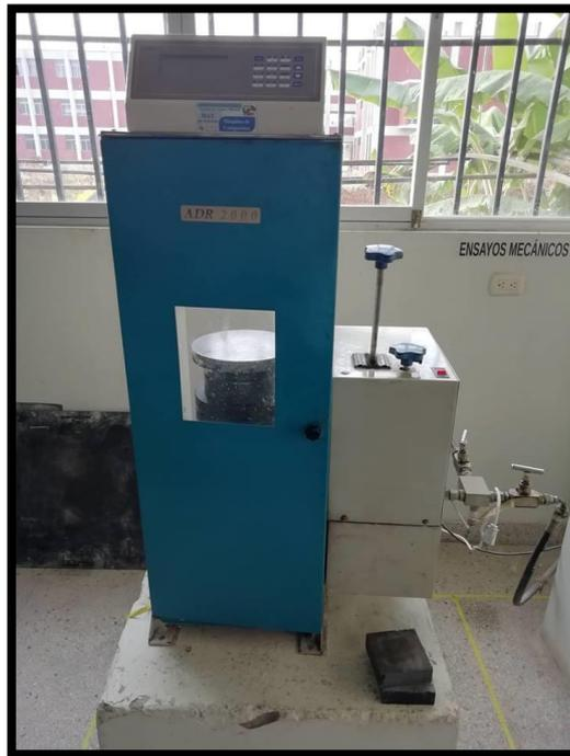
Figura 121. Prensa donde se ensayarán los ladrillos a compresión.
