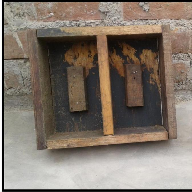
Figura 94. Molde de madera que utilizó para los ladrillos.
