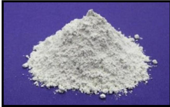
Figura 8. Cal hidratada o hidróxido de calcio.
