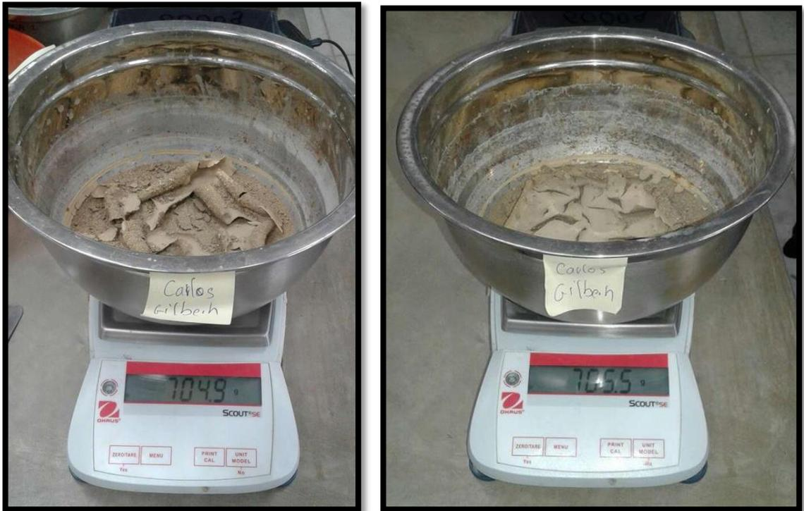
Figura 86. Pesado del material sacado del horno.
