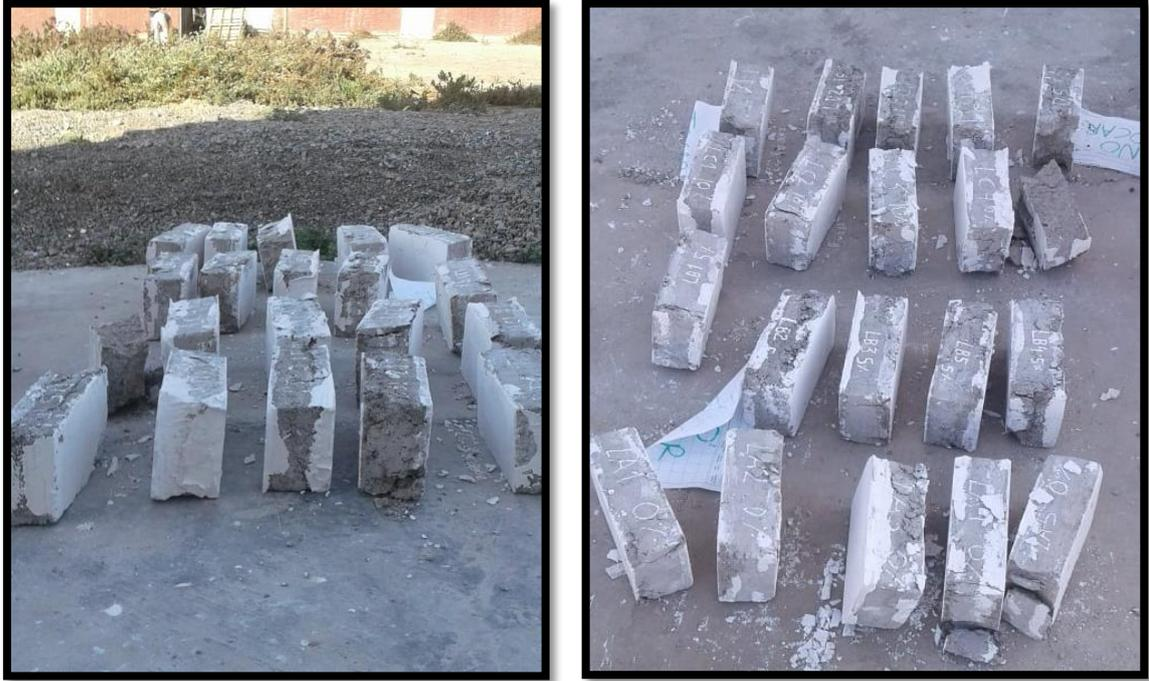
Figura 133. Los ladrillos después de haber sido ensayado a Compresión.
