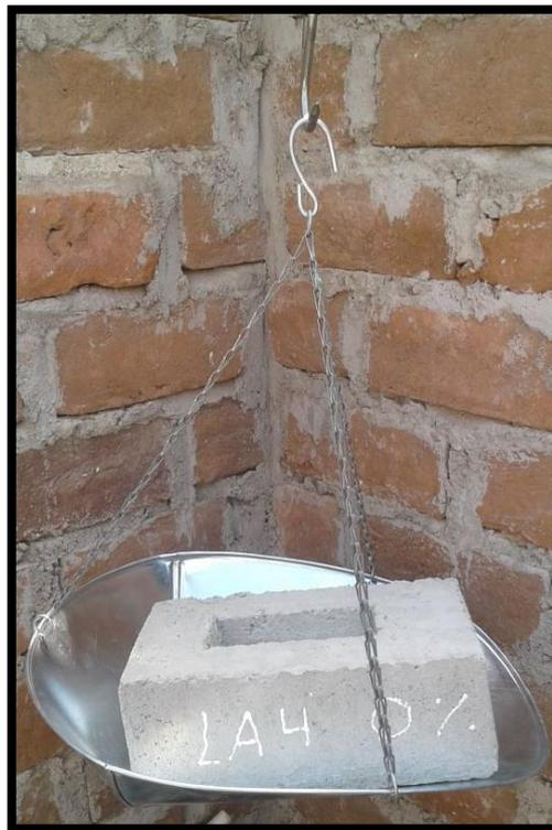
Figura 134. Ensayo de Peso de los ladrillos de 0% de CA y CCA.
