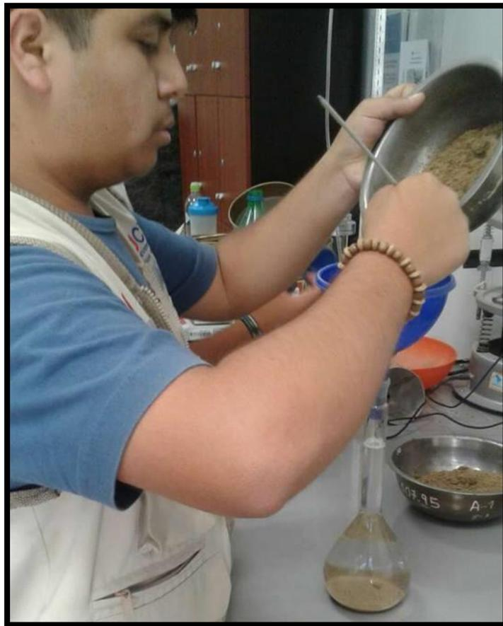
Figura 79. Se introduce el material dentro de la fiola + agua.
