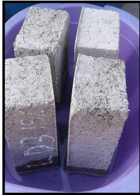
Figura 138. Ensayo de Eflorescencia de los ladrillos de concreto.
