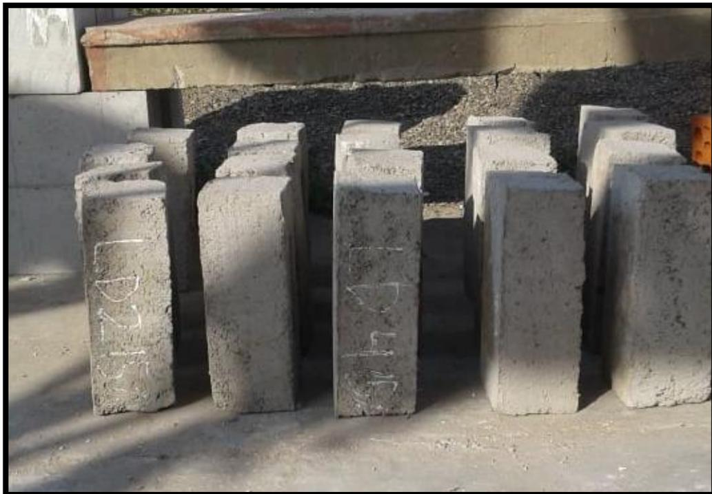
Figura 128. Ladrillos después del ensayo de Absorción.
