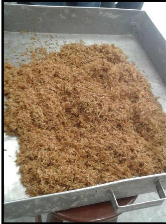
Figura 88. Secado de la CA saturado (Secado superficial).
