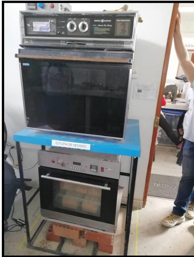
Figura 125. Estufa de secado donde se colocarán los ladrillos antes de realizar el ensayo de absorción.
