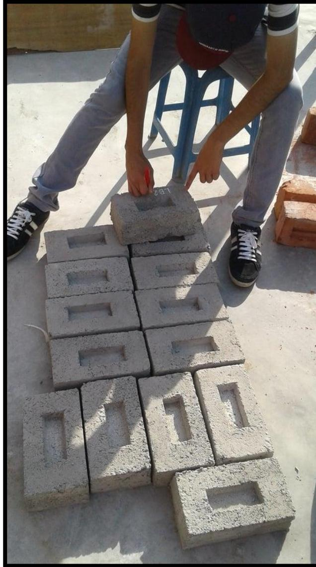
Figura 120. Codificación de los ladrillos de 10% y 15% de CA y CCA.
