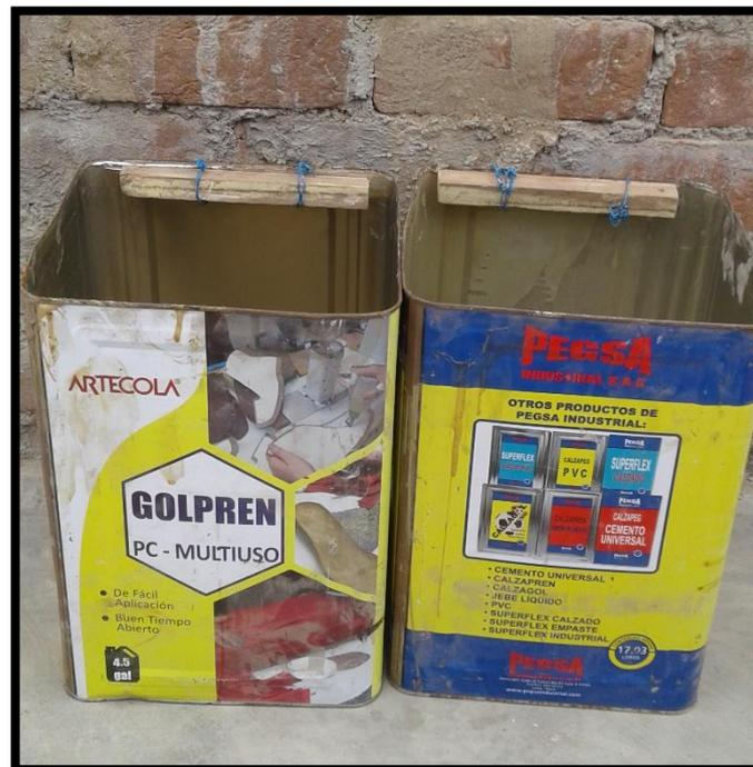
Figura 93. Latas utilizadas para proporcionar los agregados.
