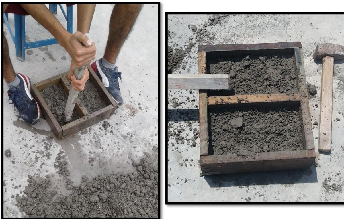
Figura 110. Colocación de la mezcla en el molde por capas para que quede más compacto.
