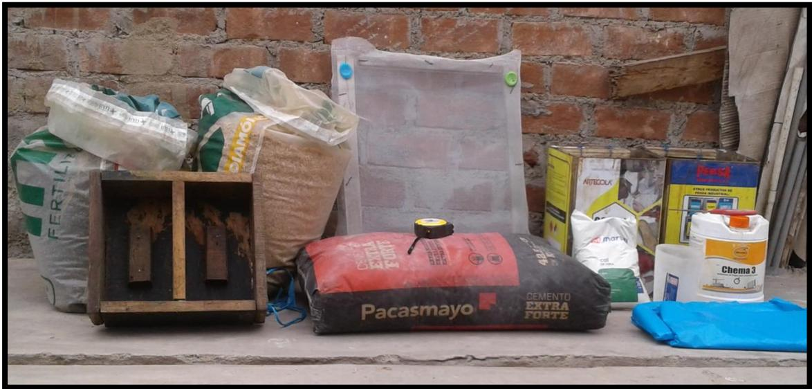
Figura 92. Materiales utilizados en la elaboración de los ladrillos de concreto.
