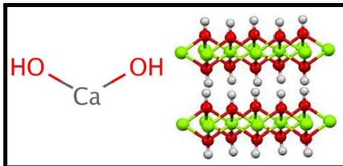
Figura 9. Estructura del hidróxido de calcio.
