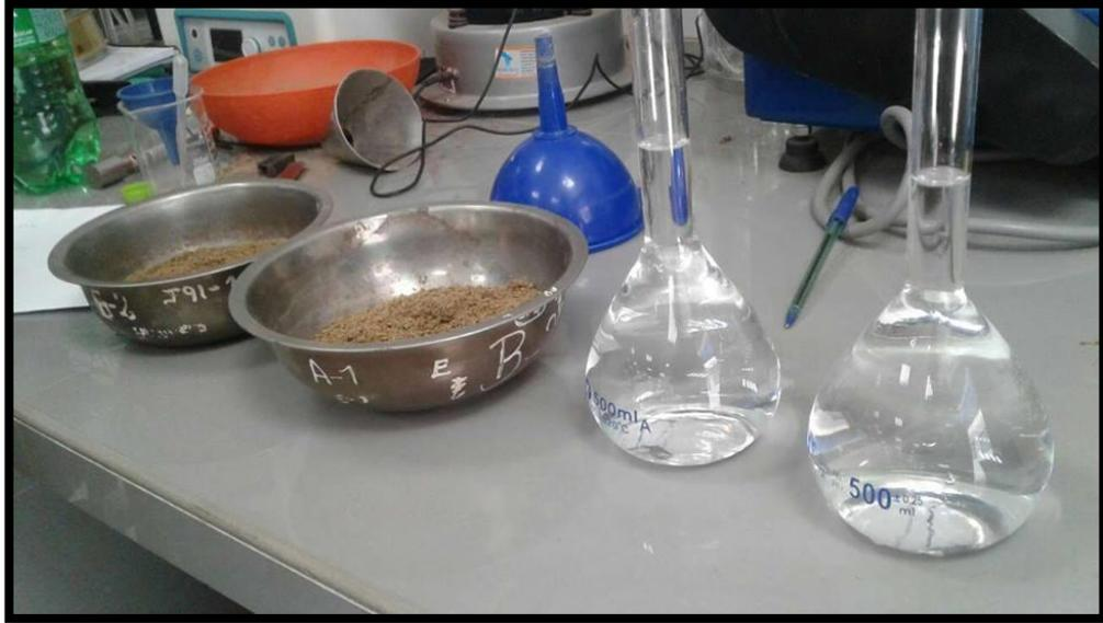
Figura 78. Se pesa 500 gr de material para introducir en las fiolas + agua.
