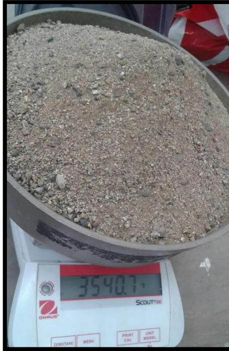
Figura 72. Pesado del material sacado del horno.
