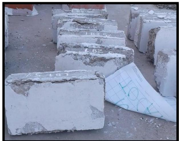
Figura 130. Ladrillos de 5% de CA y CCA después de haber sido ensayado a Compresión.
