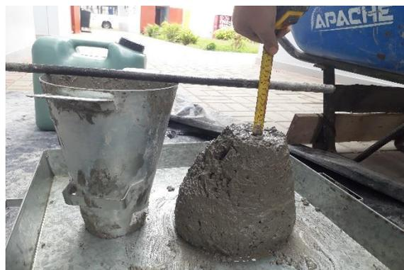
Figura 14. Medición del asentamiento del concreto en estado fresco
