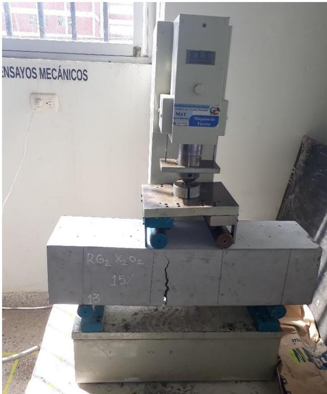
Resistencia a la flexión de especímenes de concreto con adición de fibras de acero y polipropileno en proporción del 15% ensayados a 14 y 28 días de edad, el ensayo se realizó en el laboratorio de concreto y reciclado-Universidad Nacional de Trujillo
