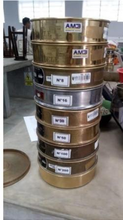
Figura 3. Tamices ordenados de manera descendente desde el N.º 3/8” hasta N.º 200, incluyendo el plato. Granulometría agregado fino.
