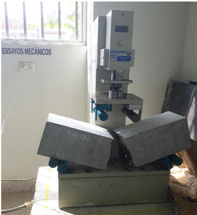
Resistencia a la flexión de especímenes de concreto patrón ensayados a 14 y 28 días de edad, el ensayo se realizó en el laboratorio de concreto y reciclado-Universidad Nacional de Trujillo
