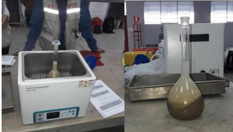
Figura 5. Determinación del peso específico del agregado fino.
