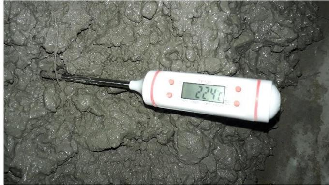
Figura 13. Toma de temperatura del concreto
