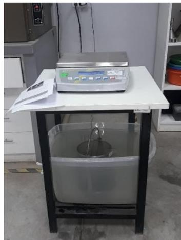
Figura 10. Peso específico y absorción del agregado grueso
