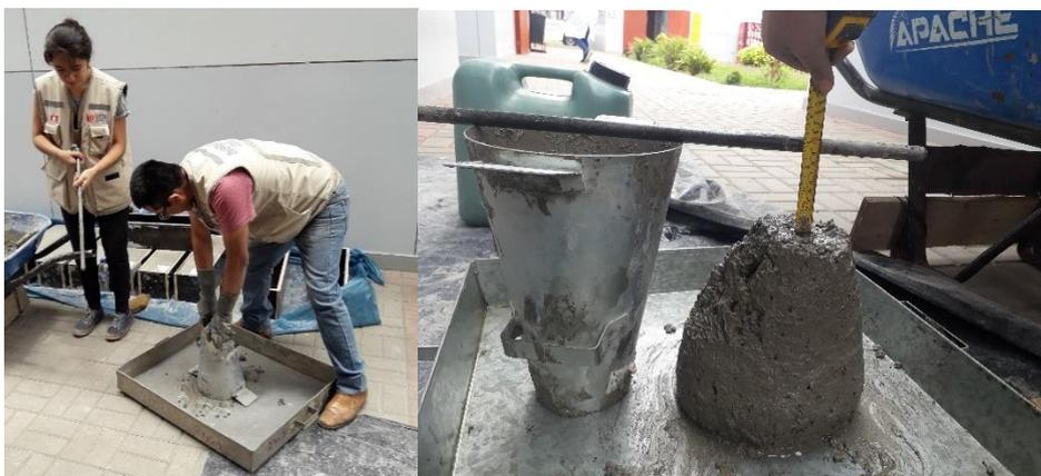
Medición del asentamiento de la mezcla de diseño, obteniéndose 3.75 pulg para mezcla patrón y 3.5 pulg para mezcla con adición de fibras de acero y polipropileno, el ensayo se realizó en el laboratorio de de mecánica de suelos de la Universidad César Vallejo – Campus Moche
