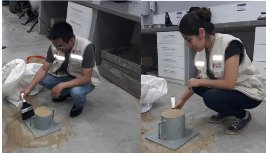
Figura 4. Cálculo del peso unitario del agregado fino.
