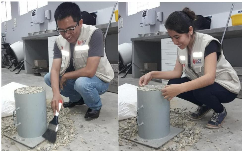
Figura 9. Peso unitario suelto y compactado del agregado grueso.
