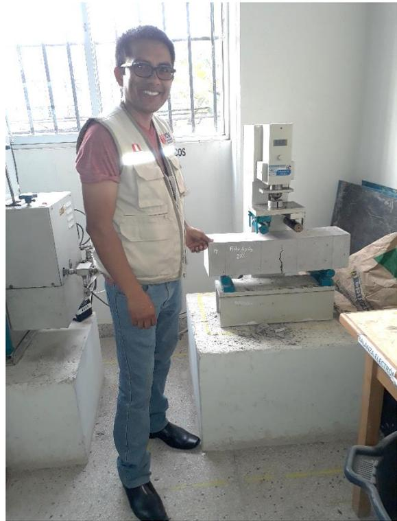
Prueba de resistencia a la flexión a cuatro puntos de vigas (150mm x 150mm x 600mm) diseñadas y evaluadas por los investigadores. Realizados en el laboratorio de concreto y reciclado-Universidad Nacional de Trujillo.
