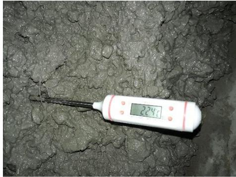
Medición de la temperatura del concreto fresco, se obtuvo una temperatura de 22.4°C, el ensayo se realizó en el laboratorio de mecánica de suelos de la Universidad César Vallejo – Campus Moche
