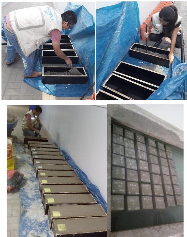
Elaboración y curado de especímenes para ensayos de resistencia a la flexión del concreto, se realizaron en el laboratorio de mecánica de suelos de la Universidad César Vallejo – Campus Moche
