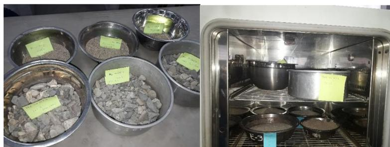
Figura 11. Muestra de agregado grueso secada al horno
