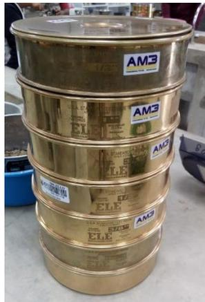
Figura 8. Tamices ordenados de manera descendente N.º 2" hasta N.º 4 y el plato. Granulometría agregado grueso.
