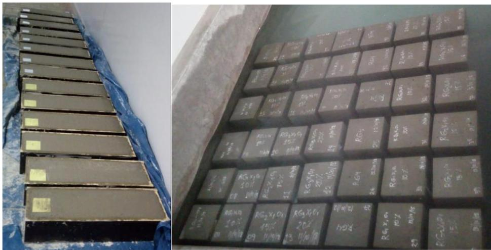
Figura 12. Elaboración y curado de especímenes
