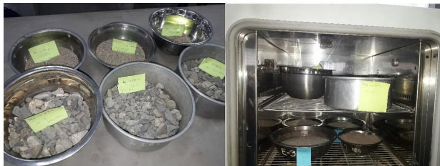
Figura 6. Muestra de agregado fino secada al horno
