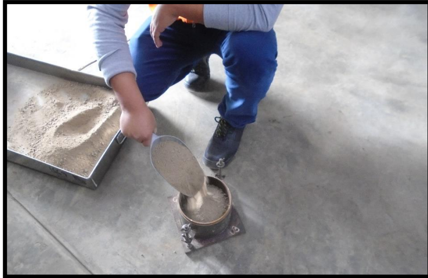
Fotografía N° 05: Vista del proceso del ensayo para encontrar el peso unitario, la muestra se coloca en la olla y se enrasa, para luego pesarlo y hacer un simple cálculo matemático.
