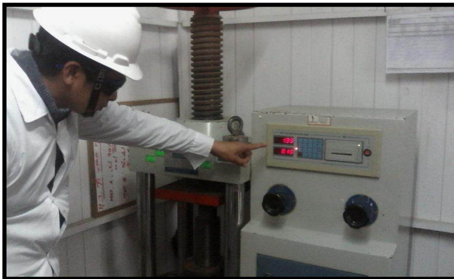
Fotografía N° 08: Vista del ensayo de compresión de la muestra, se observa la maquina universal ensayando con una velocidad controlada hasta alcanzar la rotura de la muestra registrando los valores en KN que luego será convertido a kg/cm 2 .
