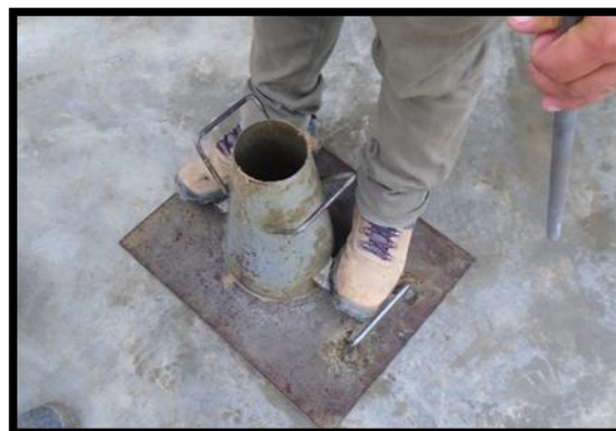
Figura 5. Cono de Abrams para medir el slump del mortero.
