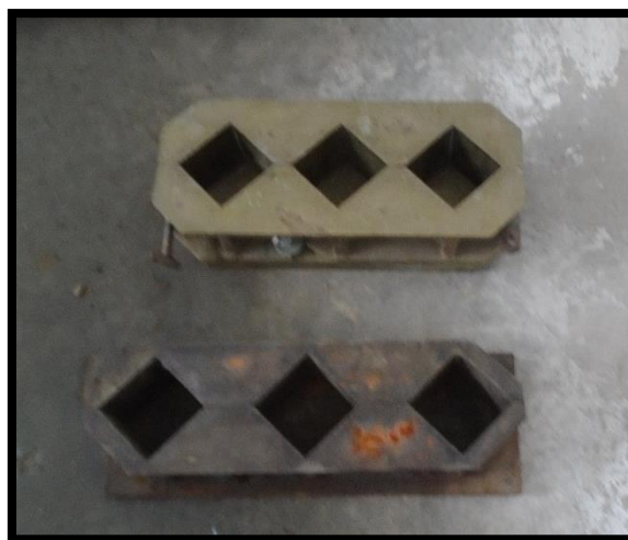
Figura 6. Probetas cubicas de 2"x 2" para muestra de morteros.
