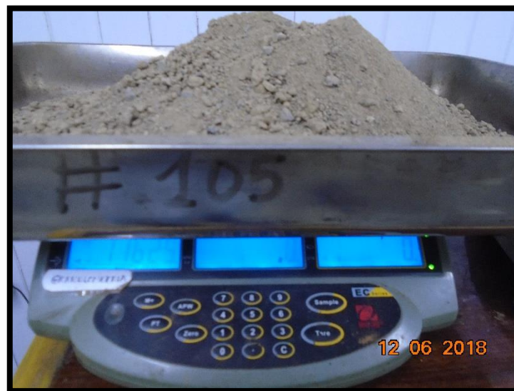
Fotografía N°06: Vista del material propio, utilizando la balanza electrónica de precisión 1 gr, obteniendo el peso para preparar la mezcla de los diseños requeridos, se pesó varias muestras de material propio para obtener la tanda para la mezcla.
