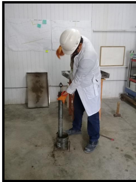
Fotografía N° 04: Vista de la compactación en el molde de acero 6'', con el pistón de 10.5 lbs se levanta una altura de 18'' y se suelta en caída libre se repite la operación 25 golpes.
