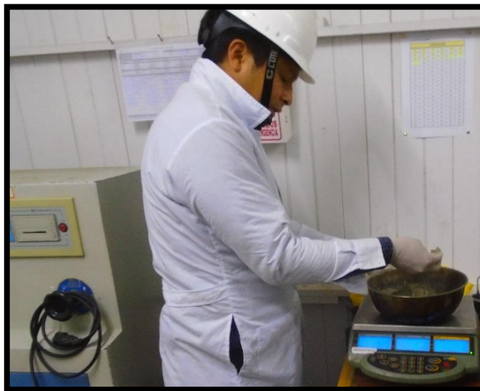
Fotografía N° 04: Vista pesando la muestra para el ensayo del peso específico, la medición se hace en una balanza electrónica de precisión de 1g.
