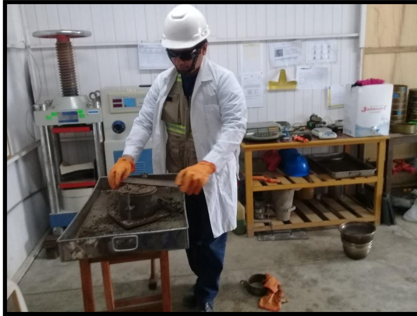
Fotografía N° 05: Vista del enrasamiento del molde con la regla metálica, sacamos el exceso de material para proceder a pesarlo en la balanza electrónica de precisión de 0.1g.
