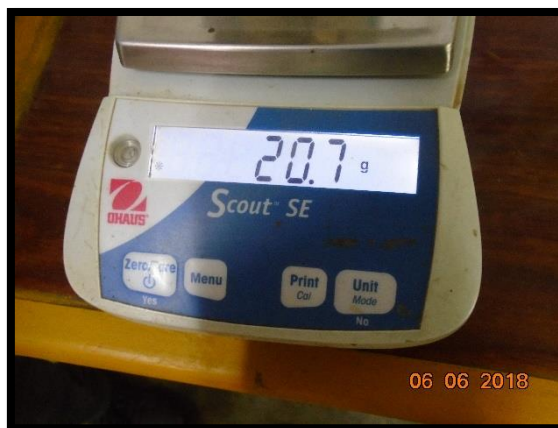
Figura 3. Balanza electrónica, precisión de 0.1gr.
