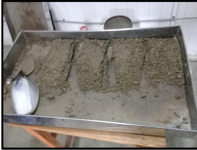
Fotografía N° 03: Vista del material humedecido y dividido en 5 partes para colocar en el molde de 6''
