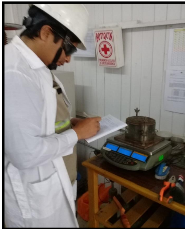
Fotografía N° 06: Vista pesando el molde con el material compactado, se obtiene datos para procesar en gabinete para calcular la humedad óptima de compactación.
