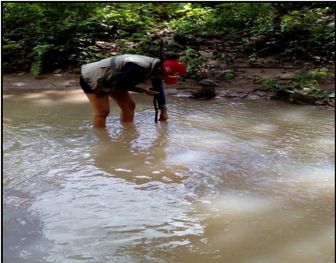
FOTO N° 04 Se visualiza la medición de la profundidad de la fuente en la parte final del tramo del aforo, con la ayuda de una vara de madera, debido a que la wincha es flexible y se dobla con la corriente del agua.
