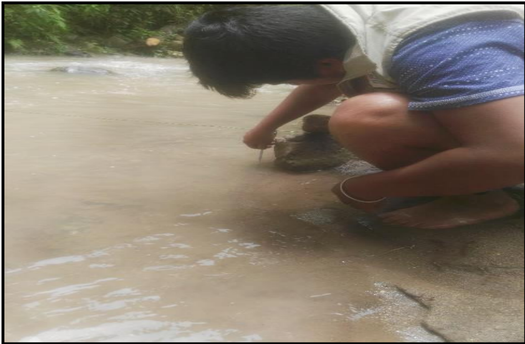
FOTO N° 04 Se visualiza la medición de la profundidad de la fuente en la parte final del tramo del aforo, con la ayuda de una vara de madera, debido a que la wincha es flexible y se dobla con la corriente del agua.
