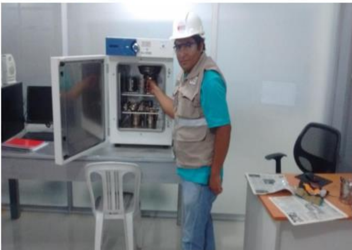
Foto 4: Colocación de muestra en el horno.
