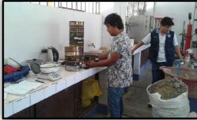
FOTOGRAFÍA N°6: En la imagen se observa tamizando los agregados para obtener las proporciones correctas.
