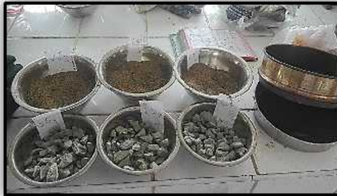
FOTOGRAFÍA N°7: En la imagen se observa las proporciones de agregado fino y agregado grueso para ser mezclado.
