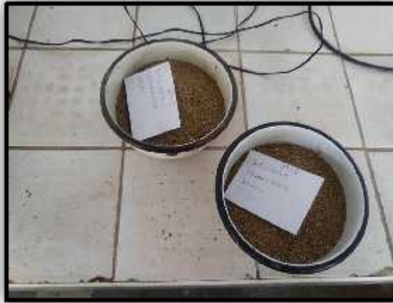
FOTOGRAFÍA N°3: En la imagen se observa las muestras del agregado fino para luego ser puesta al horno a una temperatura de 100°C.
