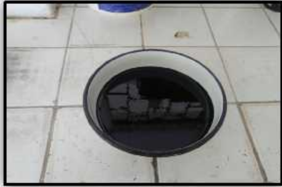
FOTOGRAFÍA N°9: En la imagen se observa el cemento asfáltico PEN 60-70 para ser mezclado.
