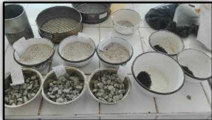
FOTOGRAFÍA N°8: En la imagen se observa las proporciones de agregado fino mezclado con cal para luego ser mezclado con el caucho granular.
