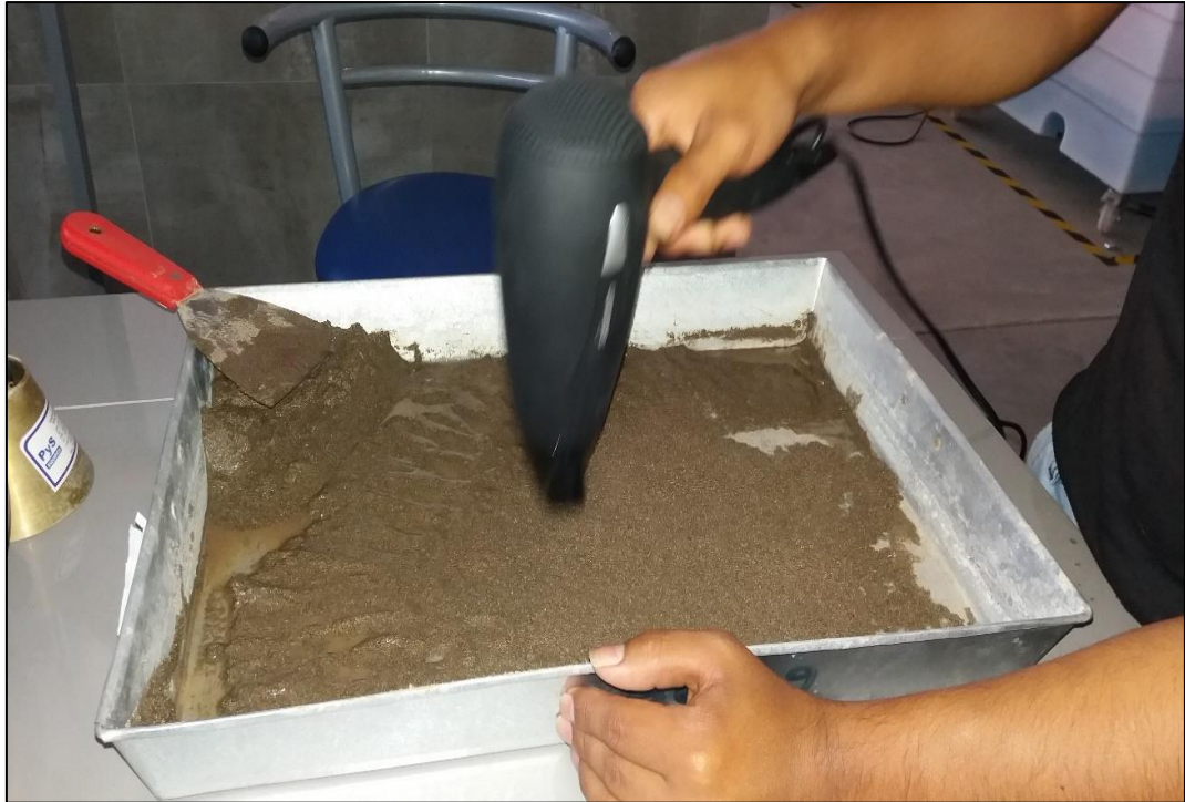
Figura 36. Secado de la muestra hasta su punto de desmoronamiento.
