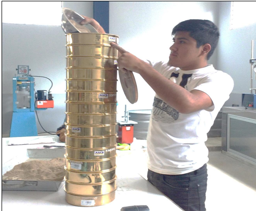
Figura 32. Colocación de la muestra a los tamices.
