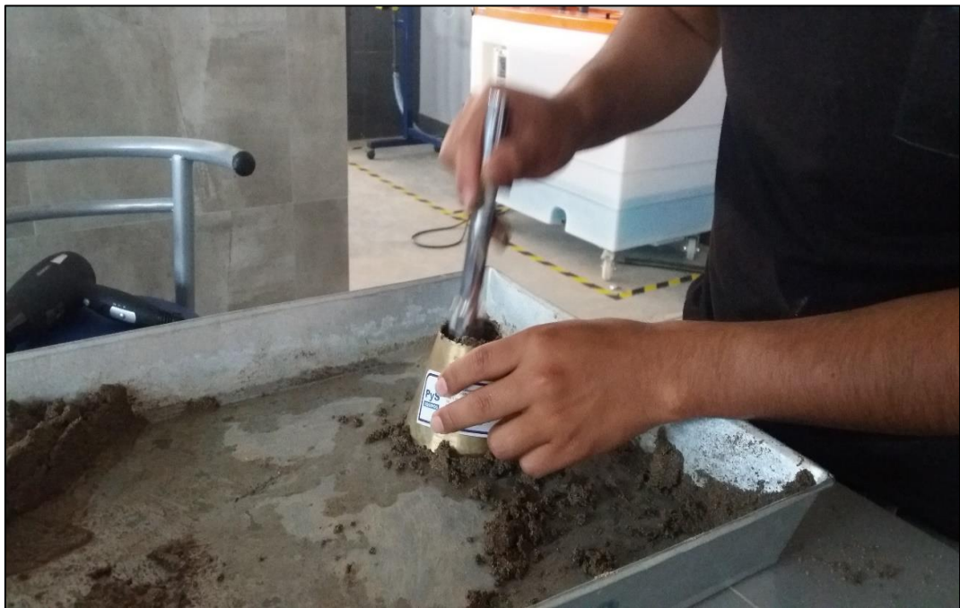
Figura 37. Apisonado del material con la barra de apriete dentro del cono de absorción de arena.
