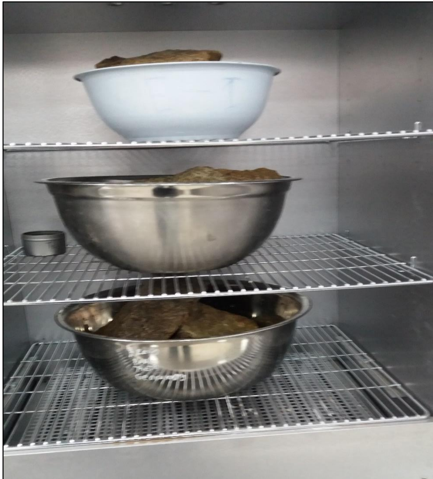
Figura 46. Muestras de rocas a secar en el horno por 24 horas.
