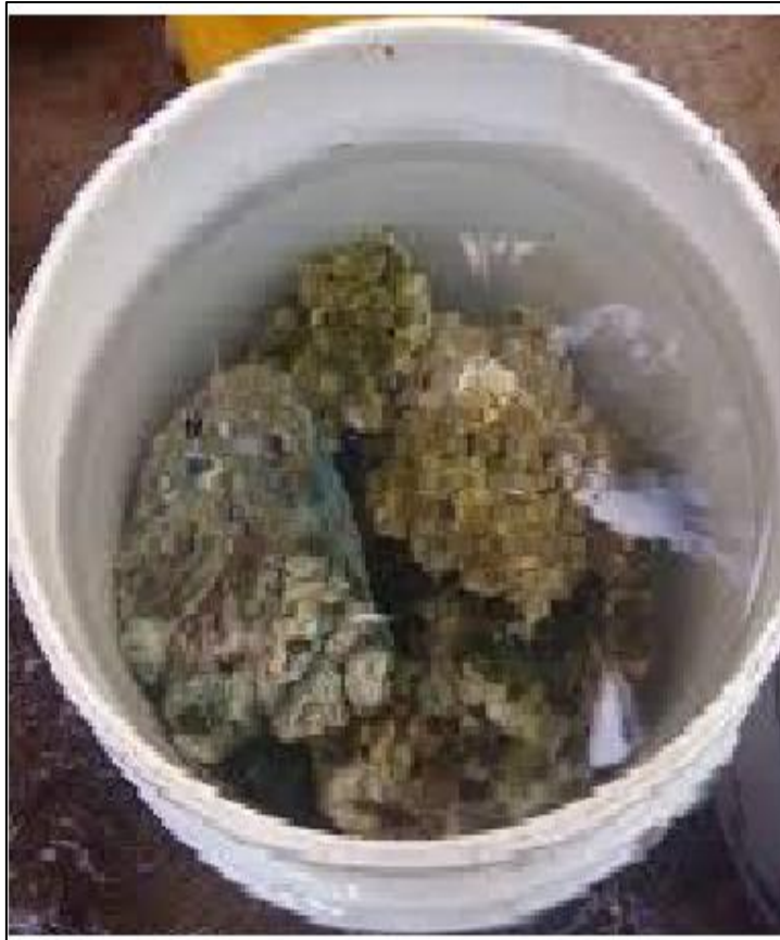
Figura 48. Saturación de las rocas por 24 horas.
