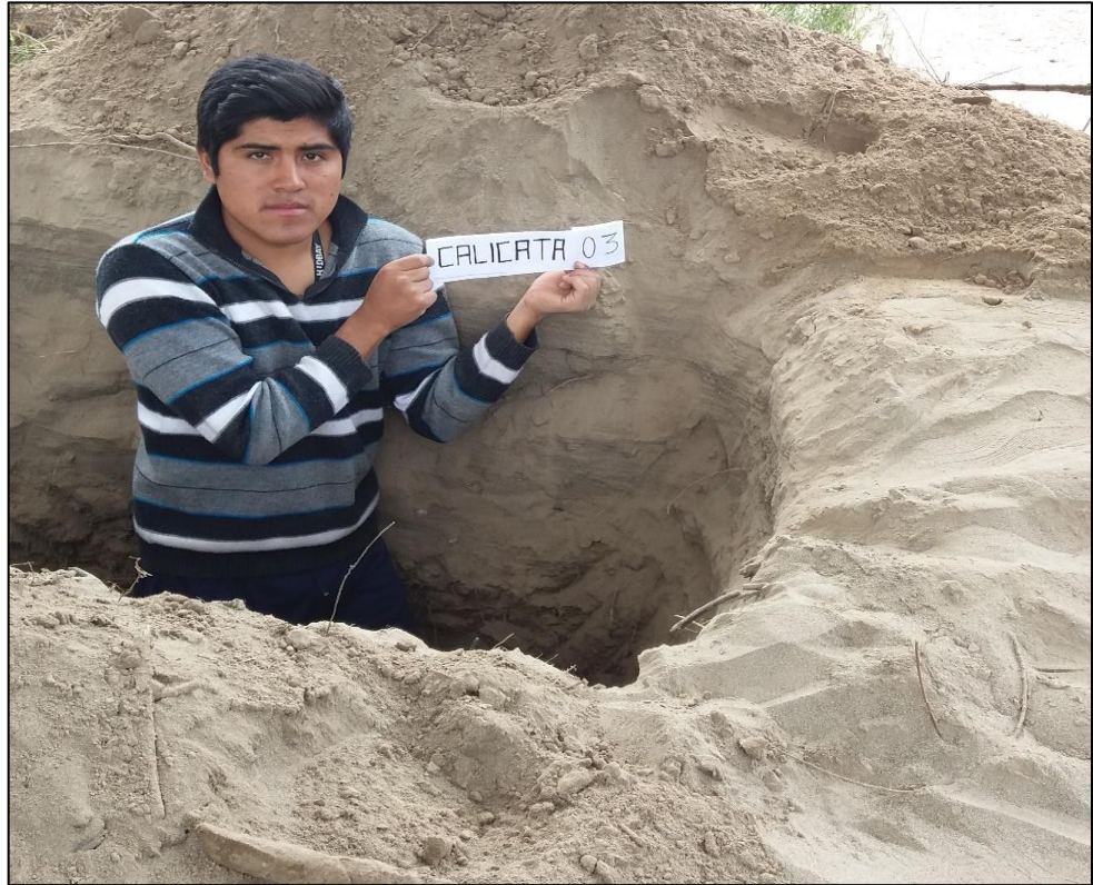
Figura 20. Verificación de trabajos de excavación de calicata N° 03.
