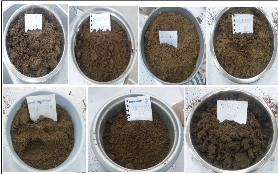
Figura 34. Muestras a secar al horno por 24 horas.
