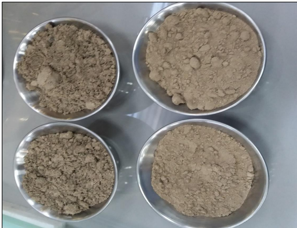
Figura 27. Muestras después del secado a 24 horas en el horno.
