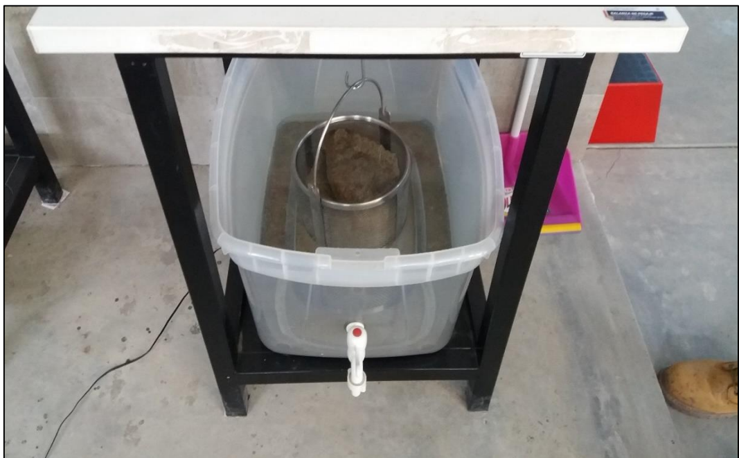
Figura 49. Muestras de rocas sumergidas en agua para toma de datos.
