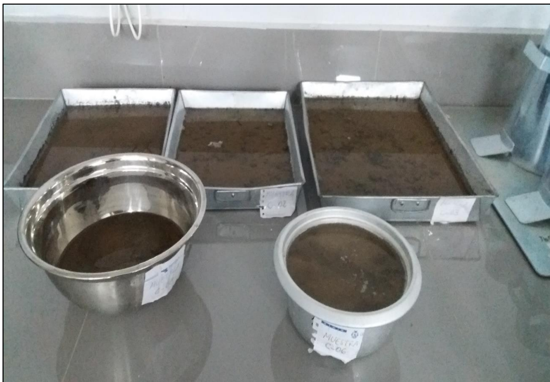
Figura 35. Saturación de las muestras secas por 24 horas.
