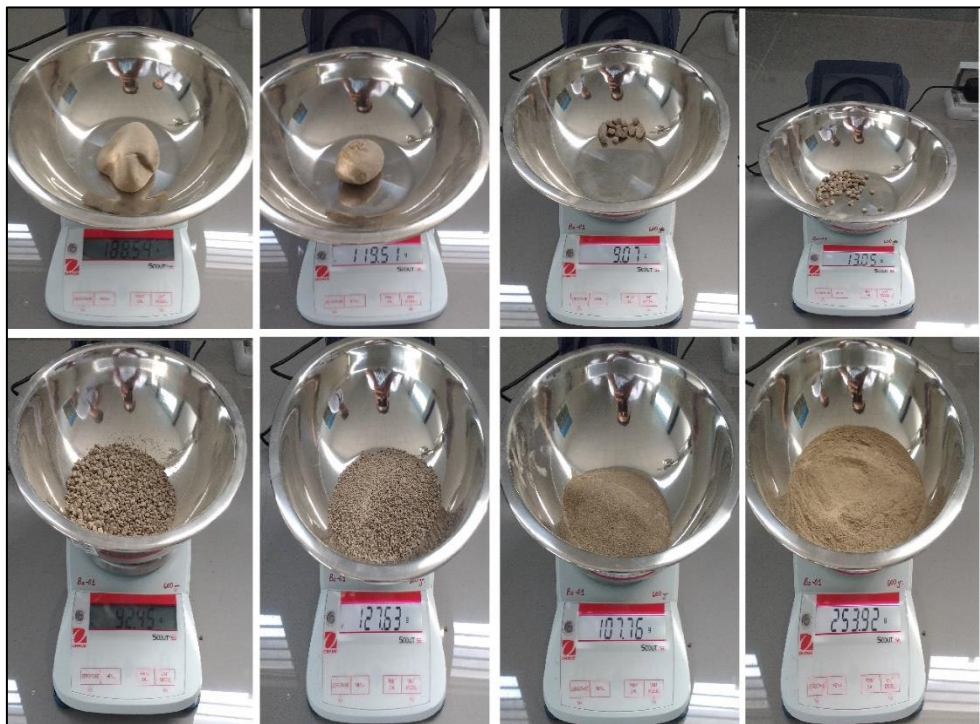
Figura 33. Toma de datos de pesos retenidos en las mallas de los tamices.
