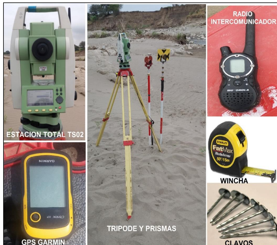
Figura 11. Equipos y herramientas utilizadas en el levantamiento topográfico.
