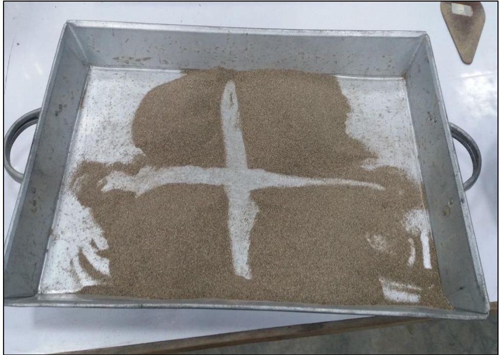
Figura 30. Cuarteo de la muestra seca.
