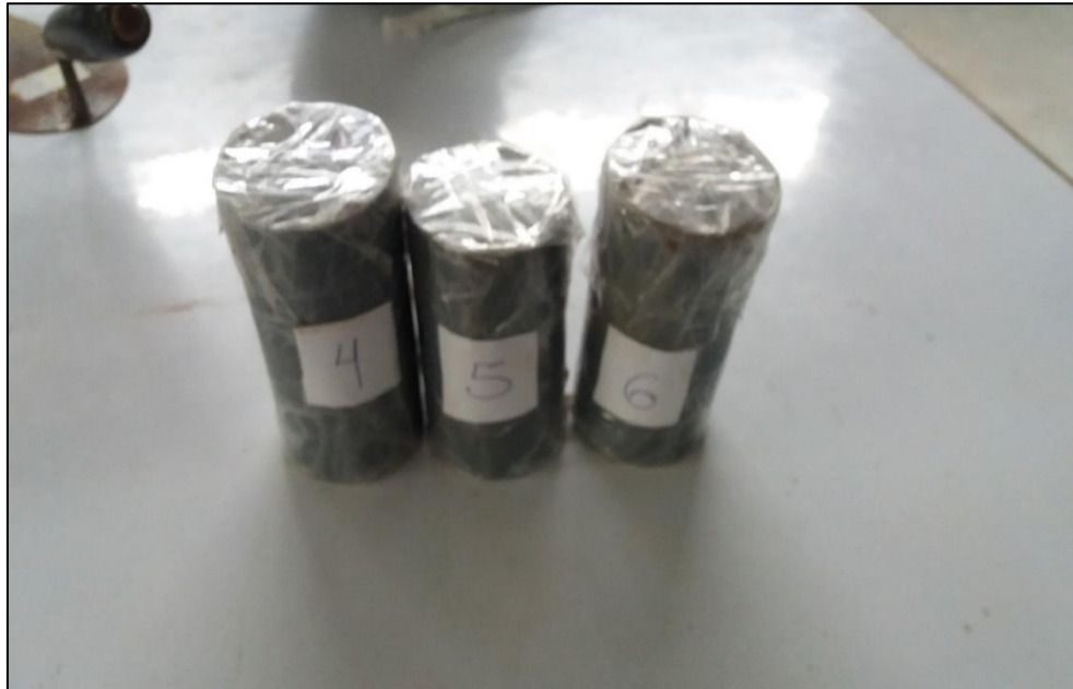
Figura 26. Muestras inalteradas extraídas de las calicatas para el ensayo de contenido de humedad.
