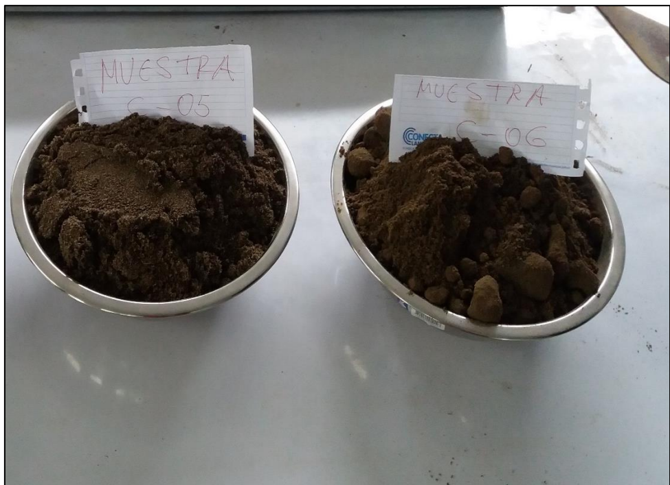
Figura 29. Muestras a secar para realizar el ensayo de granulometría por tamizado.
