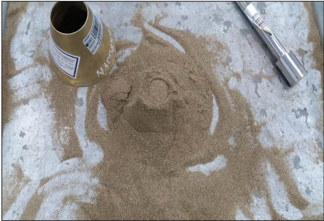
Figura 38. Desmoronamiento de la muestra.
