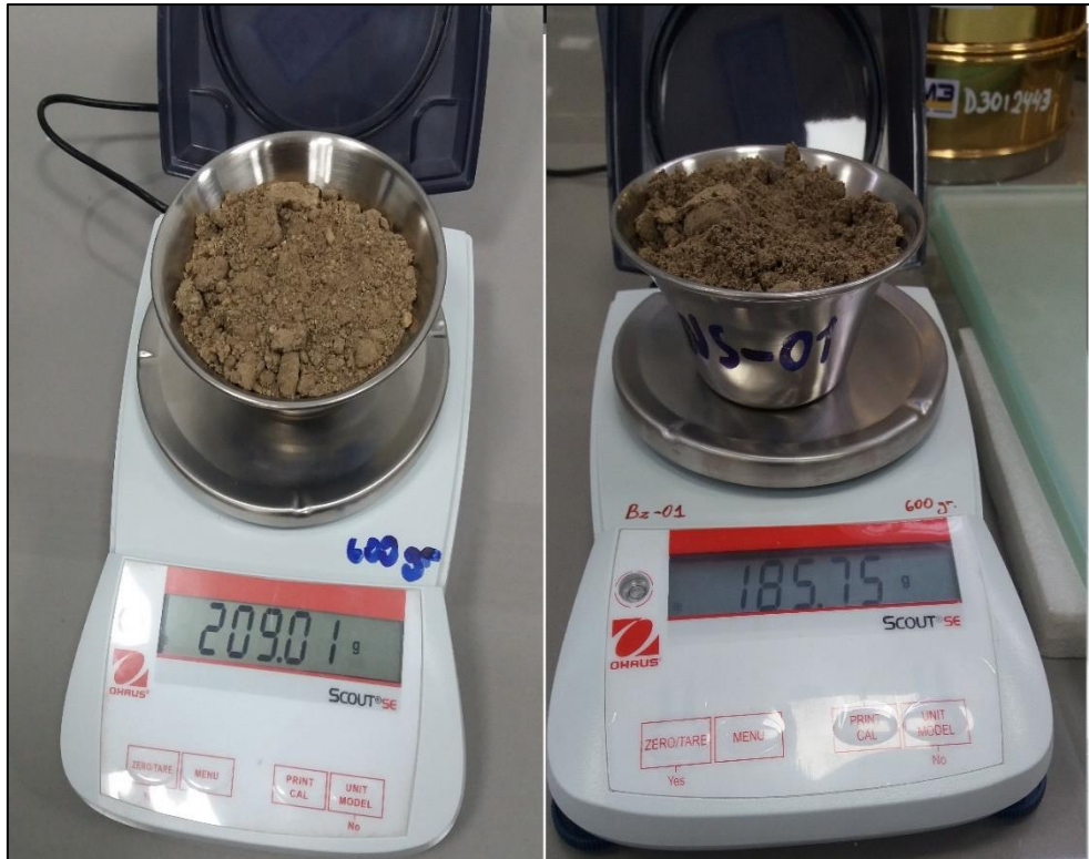
Figura 28. Toma de datos de las muestras a través de pesos.
