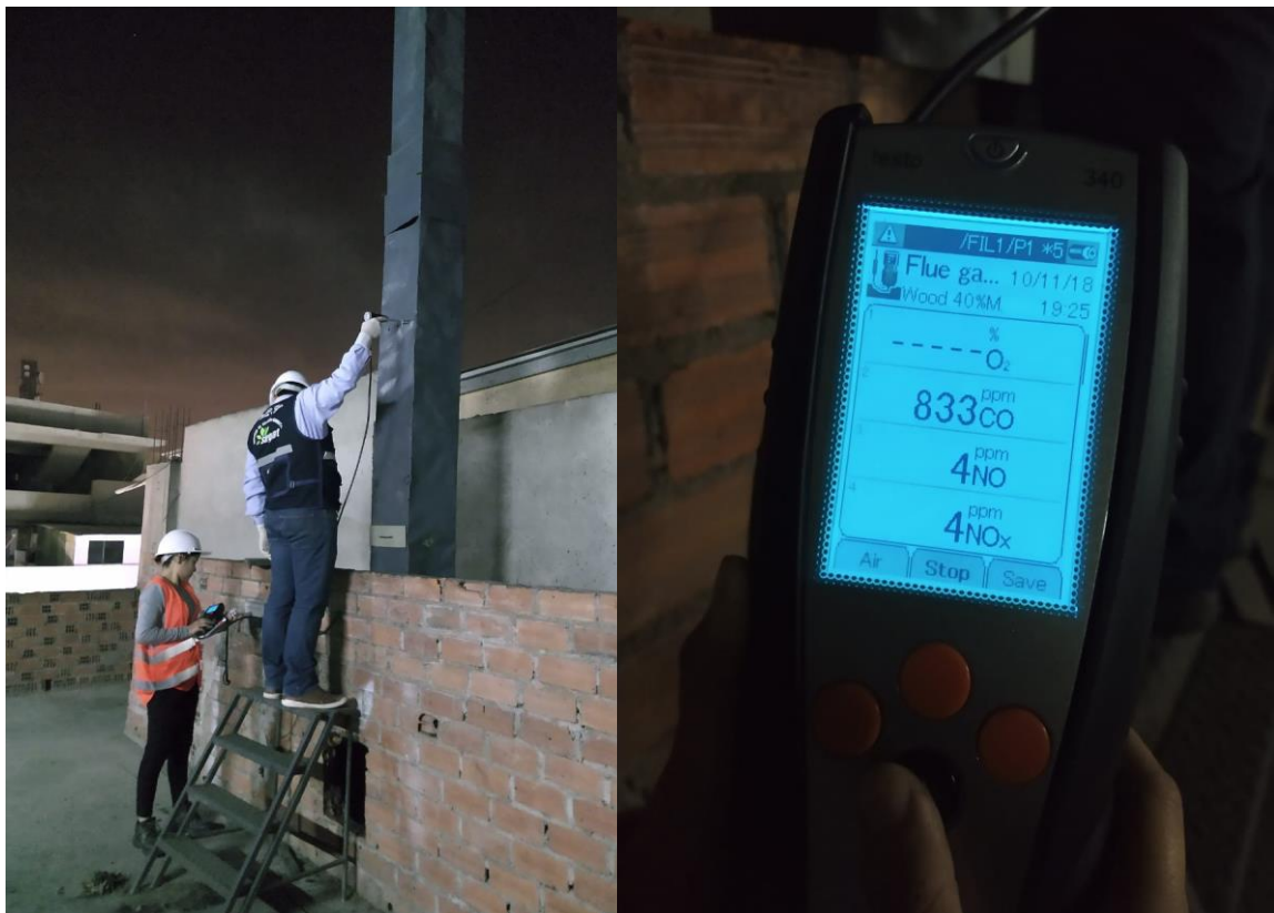
Fotografía N° 6.- Medición de las concentraciones de CO en la pollería evaluada
