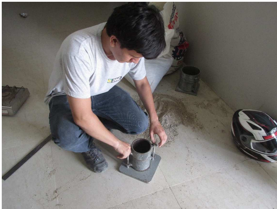
Figura 66. Colocación del anillo superior del molde.
