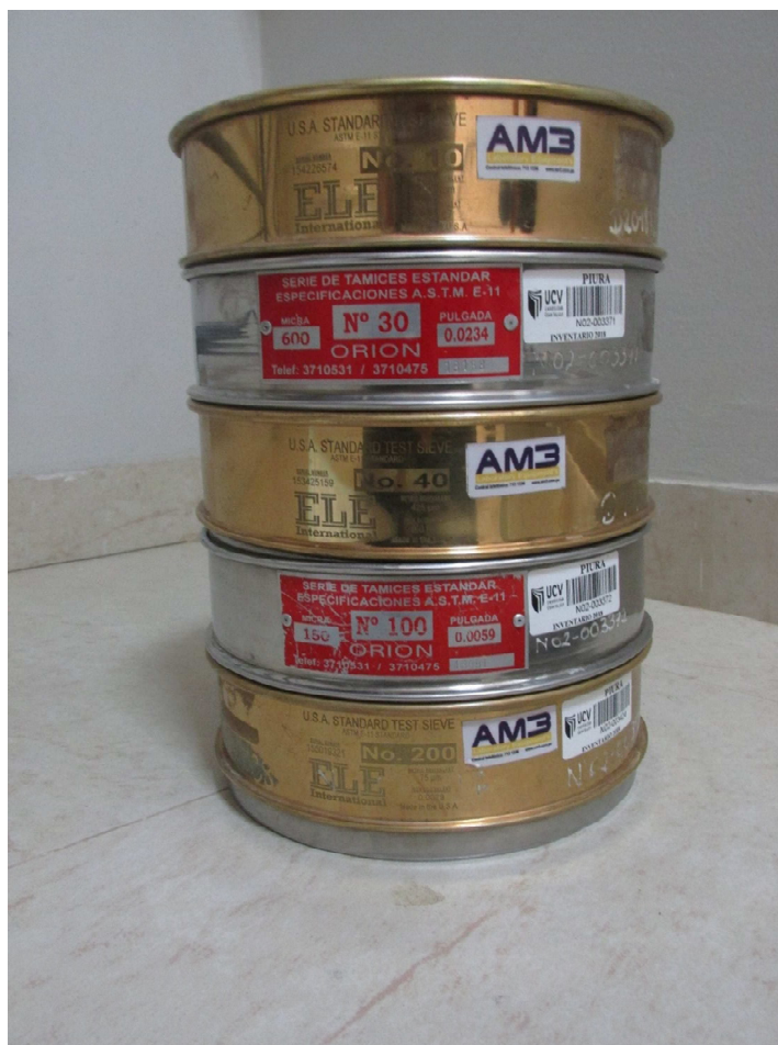
Figura 104. Serie de tamices estándar ASTM E-11 para el suelo.
