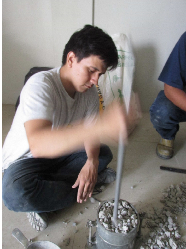
Figura 53. Varillado del agregado grueso.
