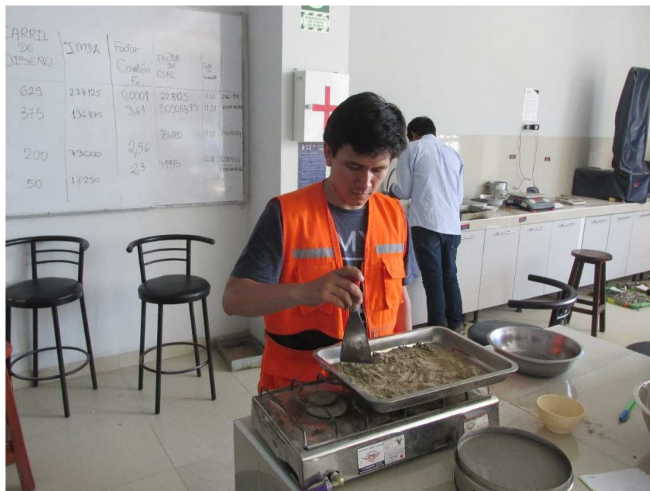
Figura 107. Secado del material con estufa para determinar el contenido de humedad.
