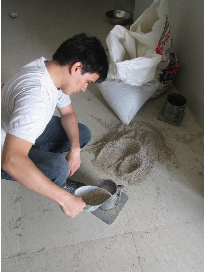
Figura 70. Llenado del molde con el agregado fino.
