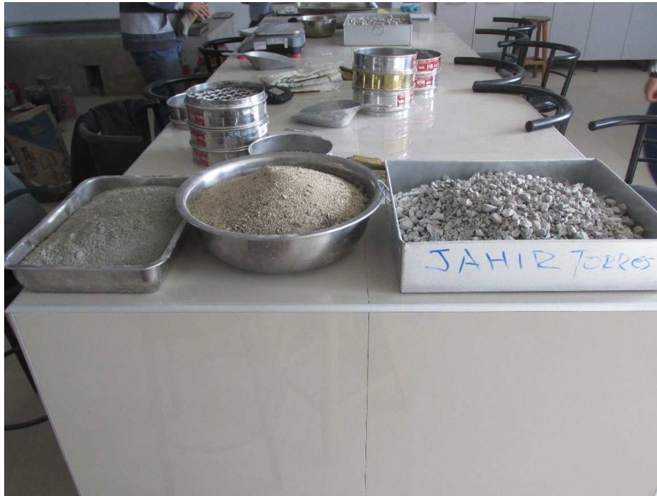
Figura 82. Dosificación de materiales.
