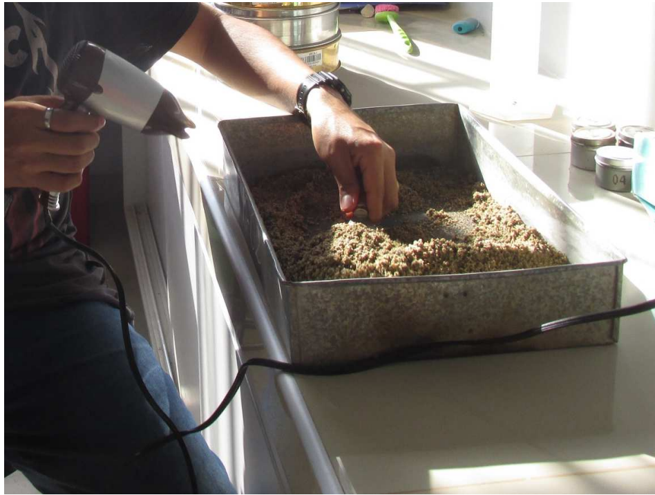
Figura 63. Secado superficial del material granular fino.
