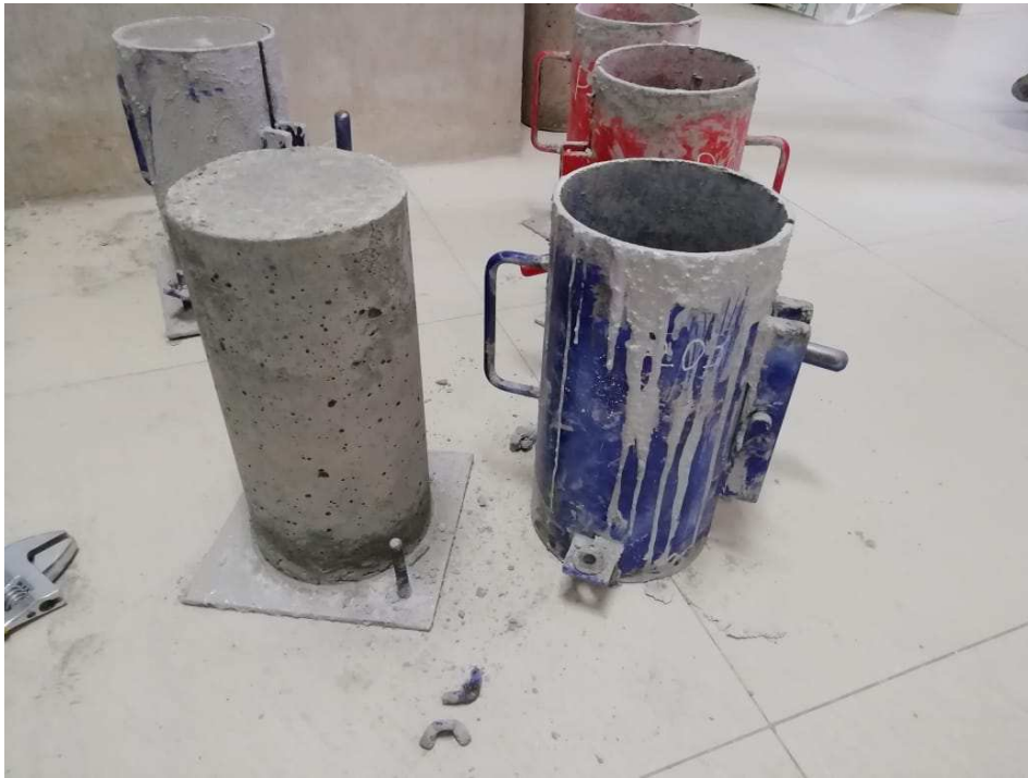
Figura 91. Desencofrado de probetas de concreto.
