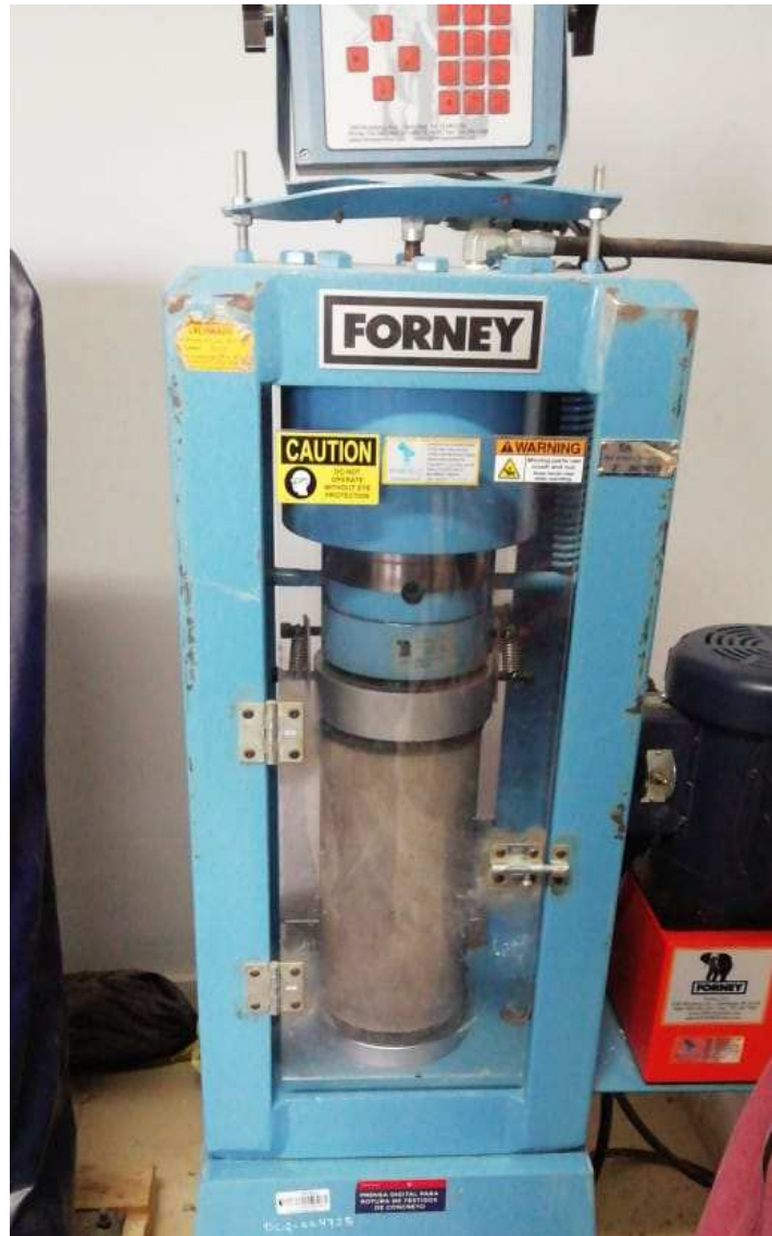
Figura 93. Ensayo a la compresión de las probetas de concreto.
