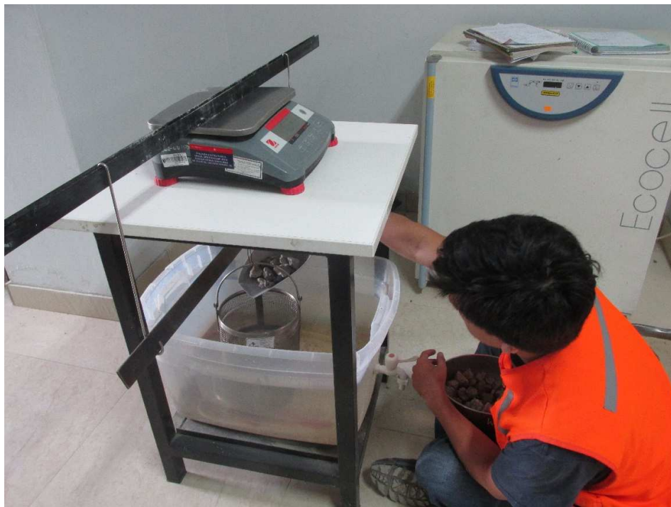
Figura 40. Colocación del agregado grueso, superficialmente seco, en la canastilla sumergida.
