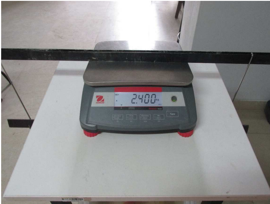
Figura 41. Peso de la canastilla sumergida más la primera fracción de agregado grueso.
