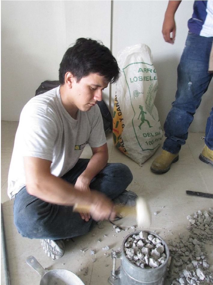
Figura 54. Golpes con martillo de goma alrededor del perímetro del molde.
