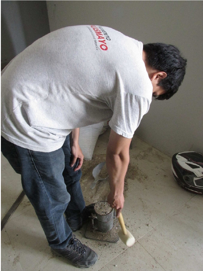
Figura 72. Aplicación de golpes con el martillo de goma.
