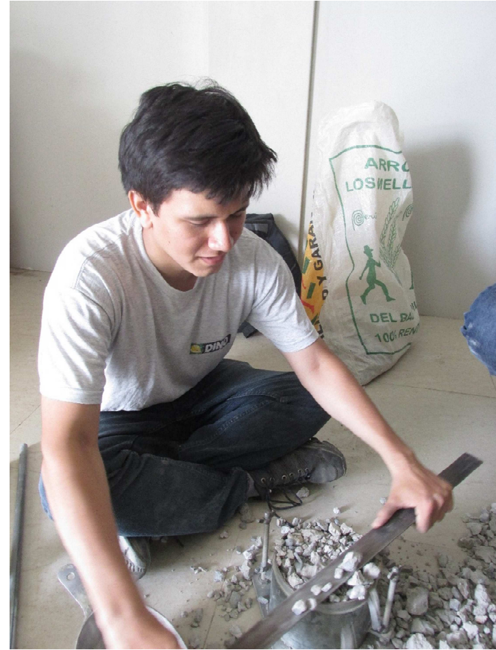
Figura 55. Enrase de la superficie del agregado grueso compactado o varillado.
