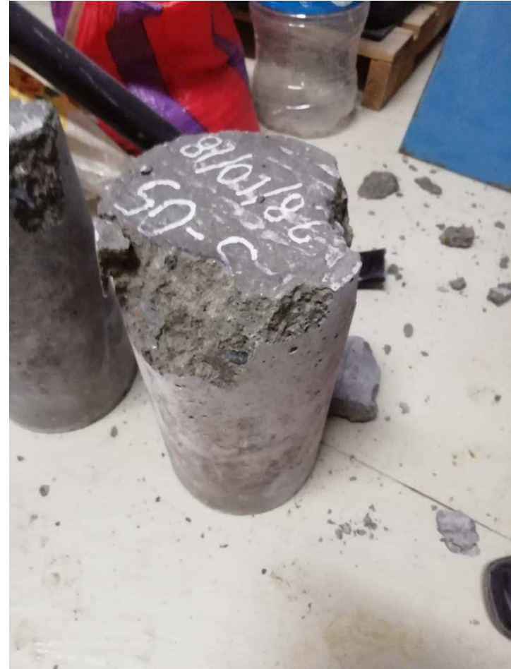
Figura 96. Fracturas en la parte superior presente en el grupo de probetas del segundo diseño.
