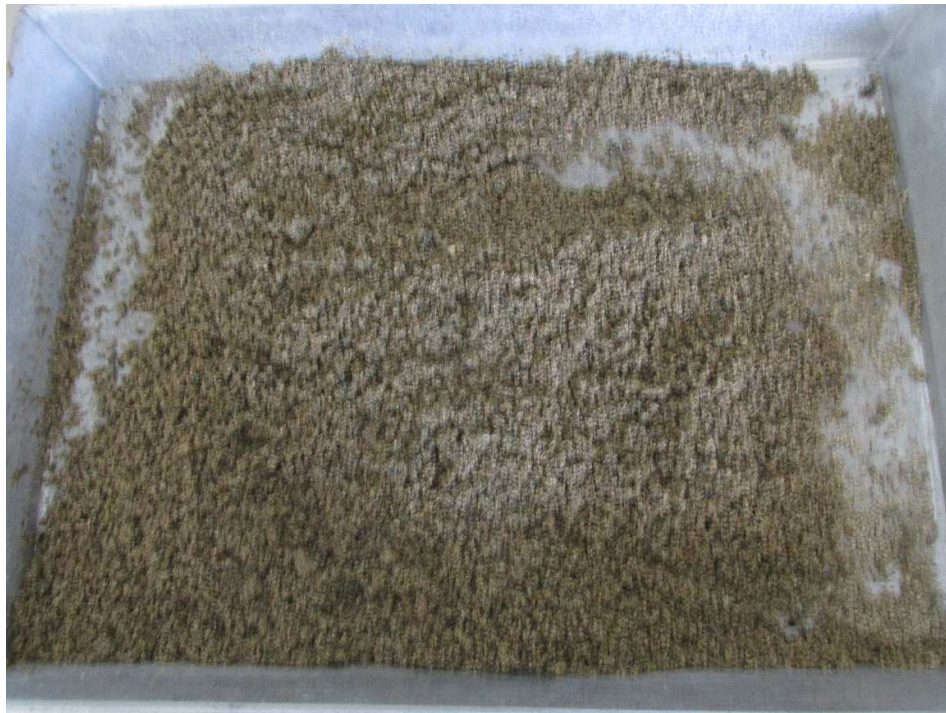
Figura 64. Agregado fino superficialmente seco.
