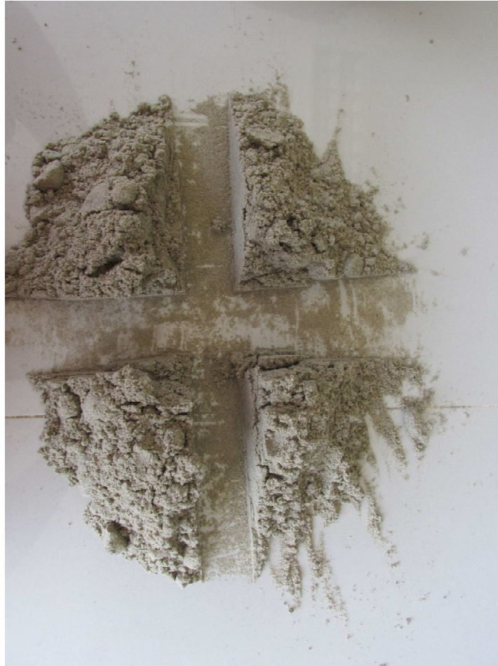
Figura 102. Cuarteo de la muestra de suelo.
