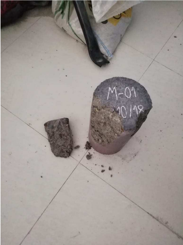
Figura 95. Fracturas en la parte superior presente en el grupo de probetas del primer diseño.
