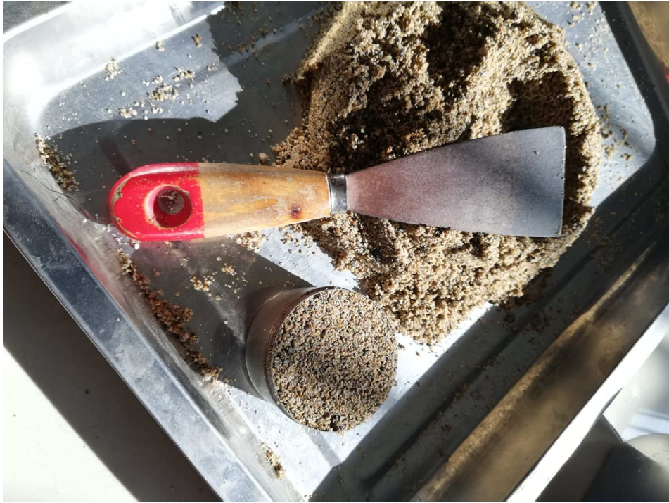
Figura 78. Fracción del material granular en recipiente metálico para equivalente arena.
