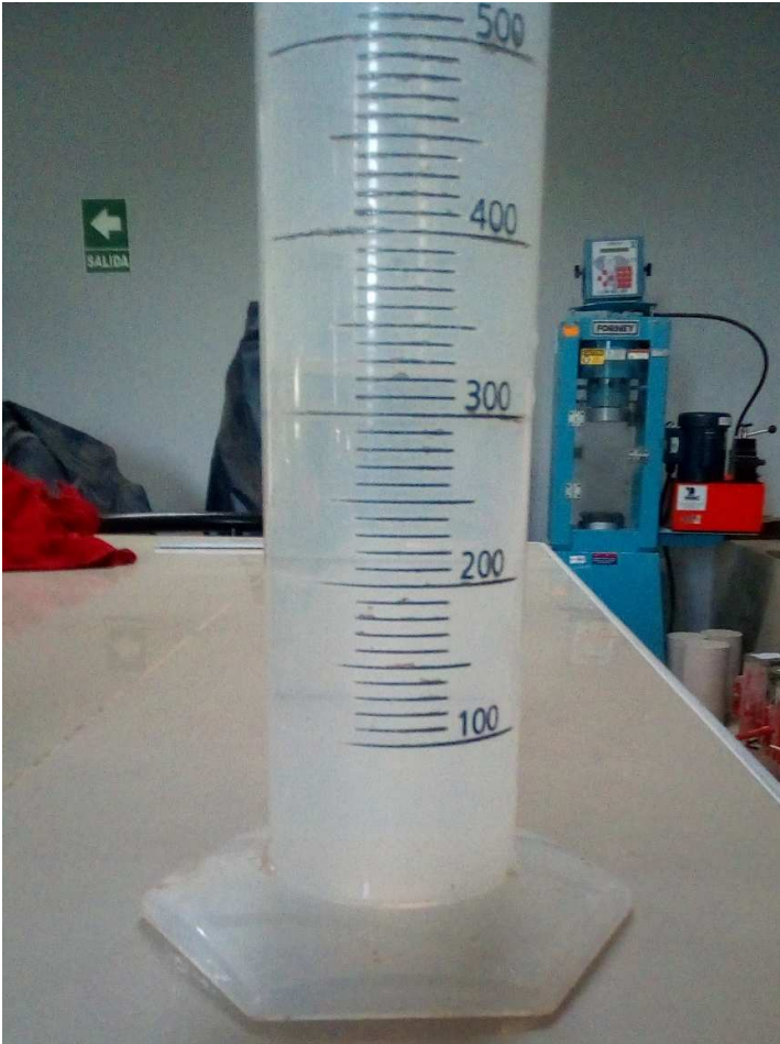
Figura 111. Cantidad de agua para la segunda fracción de la muestra de suelo para Proctor.
