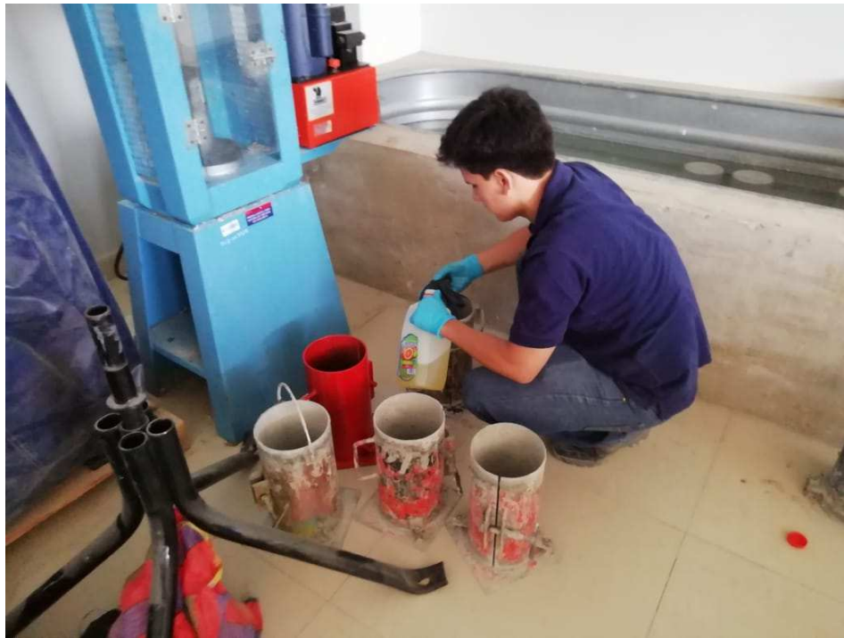
Figura 89. Preparación de los moldes de probetas de concreto.
