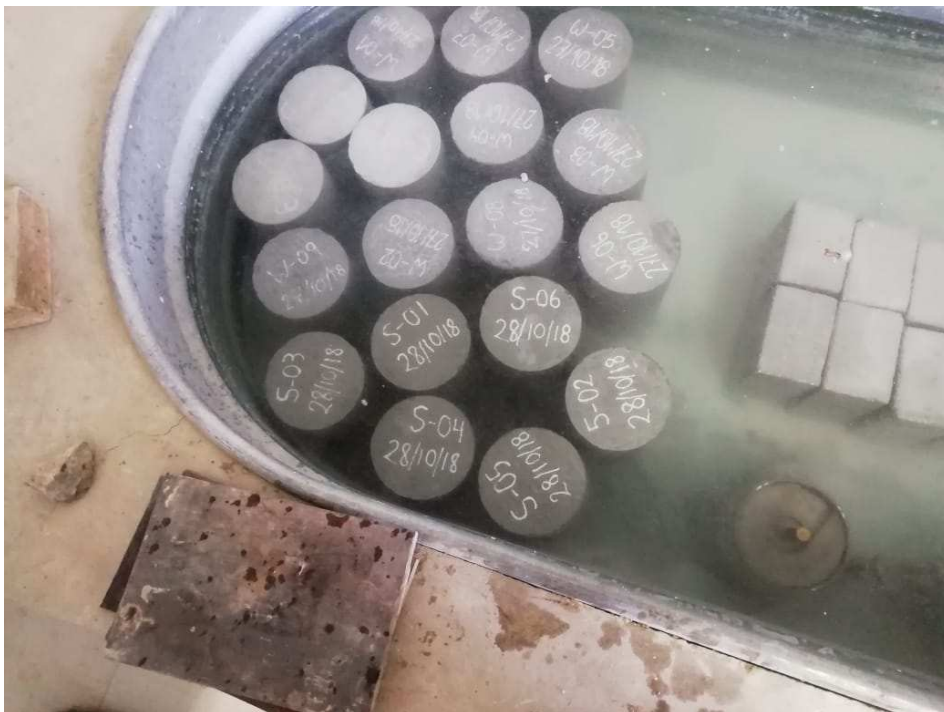
Figura 92. Curado de probetas de concreto.
