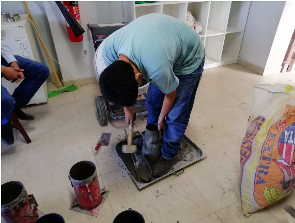
Figura 86. Eliminación de vacíos de aire con martillo de goma.
