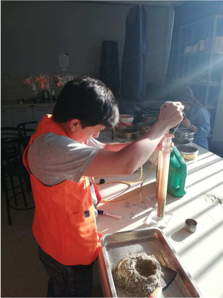
Figura 80. Llenado de la probeta con muestra del material granular para equivalente arena.
