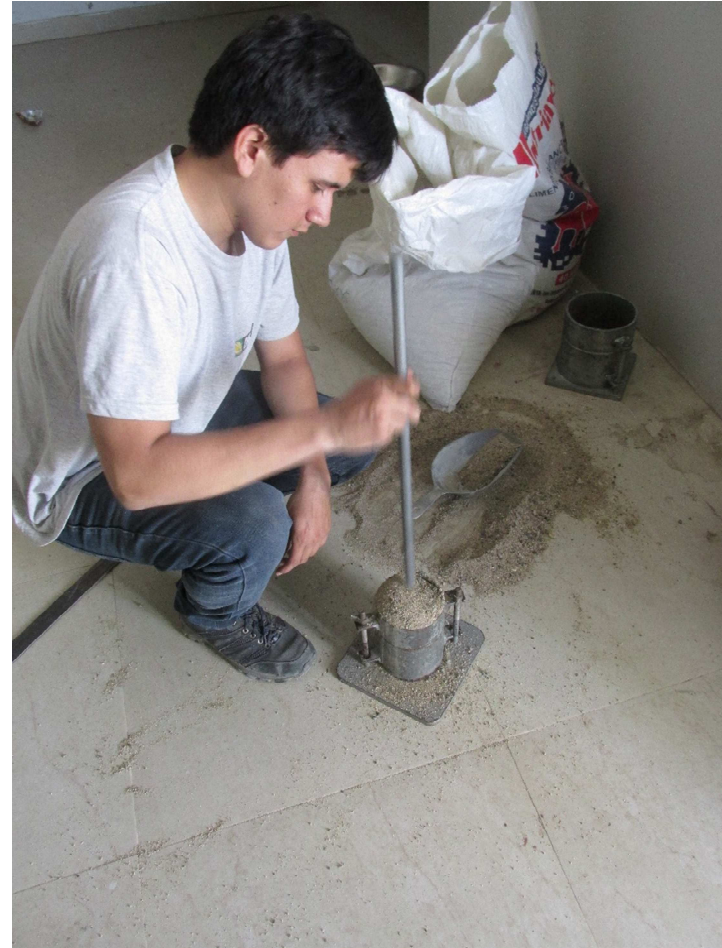
Figura 71. Compactación del agregado fino con agregado fino.
