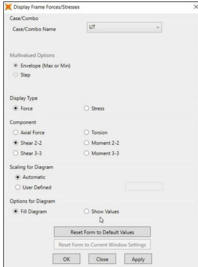
Figura 60 Proceso para verificar los esfuerzos de momentos y cortantes de cada punto
