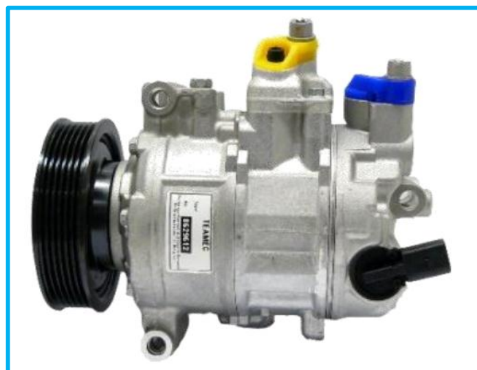
Compresor del sistema de aire acondicionado
