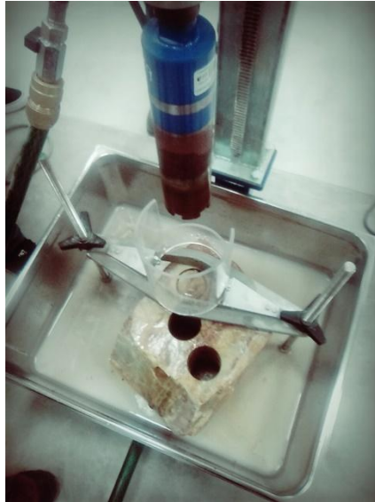
Figura 37. Roca perforada del portal de salida
