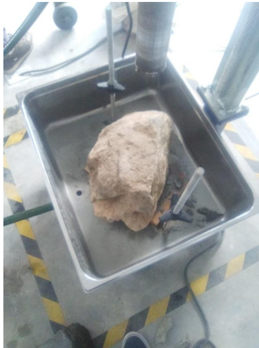
Figura 36. Roca puesta en la perforadora
