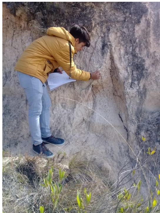
Figura 14. Obteniendo la rugosidad del macizo rocoso de la estación N° 2
