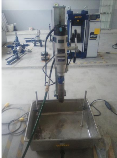
Figura 35. Perforadora de Rocas – Laboratorio UCV
