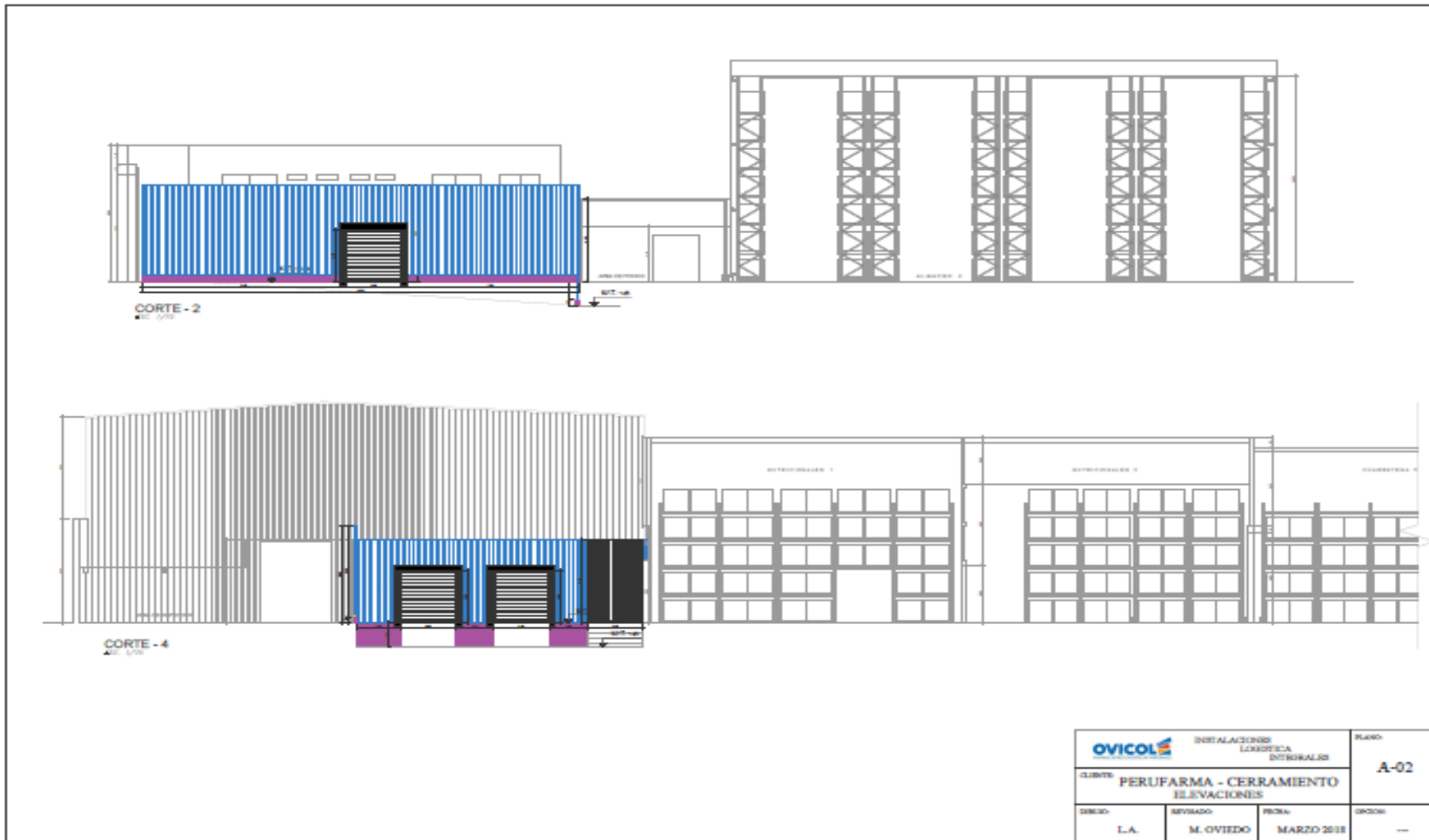
Figura 13. Cerramiento de Rampa - Elevaciones
