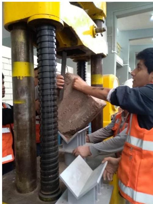
*Figura 178.* Alineación del murete y colocación de ángulos adicionales
