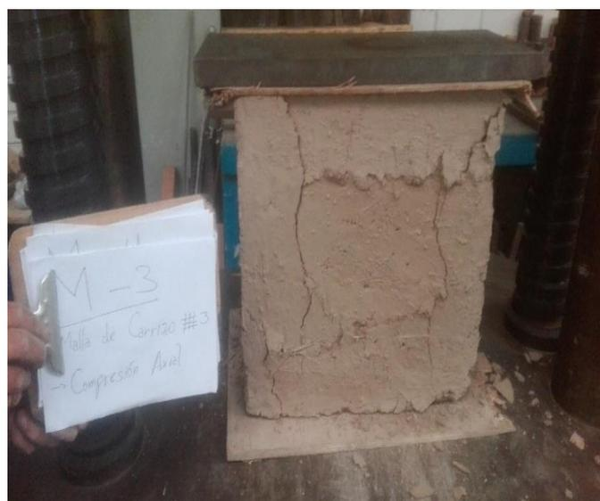
*Figura 134.* Muestra 3 con refuerzo de carrizo después de la rotura a compresión axial
