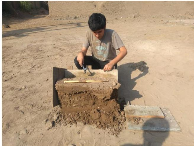
*Figura 80.* Retiro de encofrado de 1 prueba
