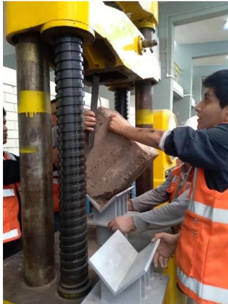
*Figura 185.* Colocación del murete en los ángulos con las piezas de triplay
