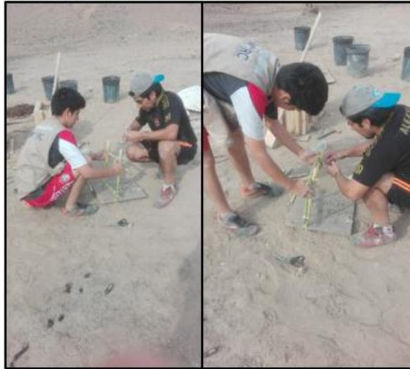
*Figura 86.* Elaboración de la malla de carrizo para la prueba 2
