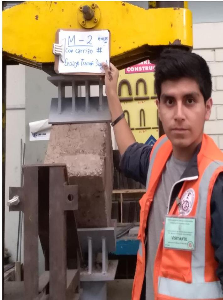
Figura 183. Segunda muestra de tapial de  $e=0.25m$  antes de la rotura por corte
