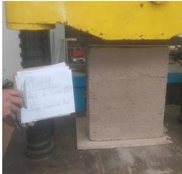
*Figura 135.* Muestra 4 con refuerzo de carrizo antes de la compresión axial
