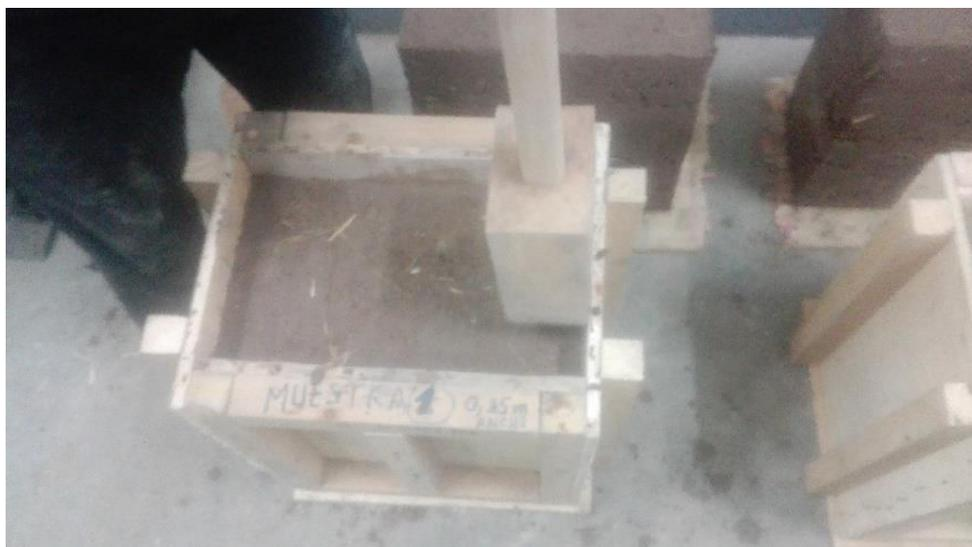
*Figura 156.* Apisonamiento en la primera muestra de tapial
