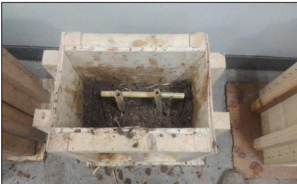
*Figura 110.* Colocación del carrizo en la segunda muestra de tapial
