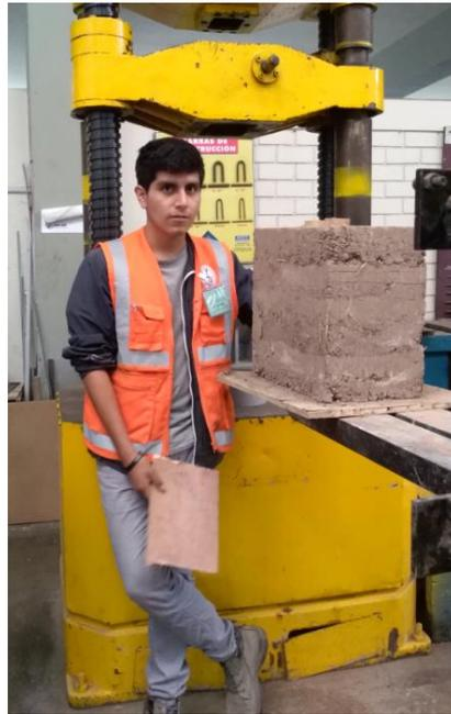
*Figura 189.* Colocación del murete en los ángulos con las piezas de triplay
