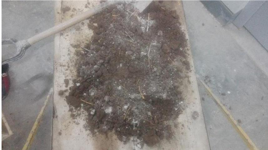
*Figura 149.* Aplicación del aditivo de cal un 5%
