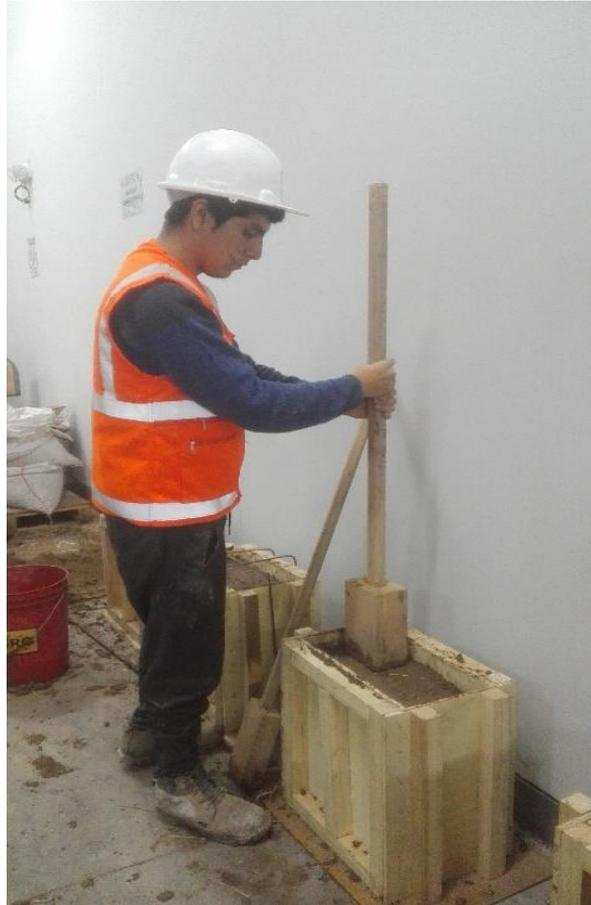
*Figura 115.* Mazón de 10 kg en la última camada de la 3 muestra de tapial
