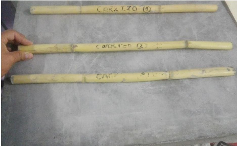
*Figura 49.* Proceso de secado del carrizo con epóxico y el diablo
