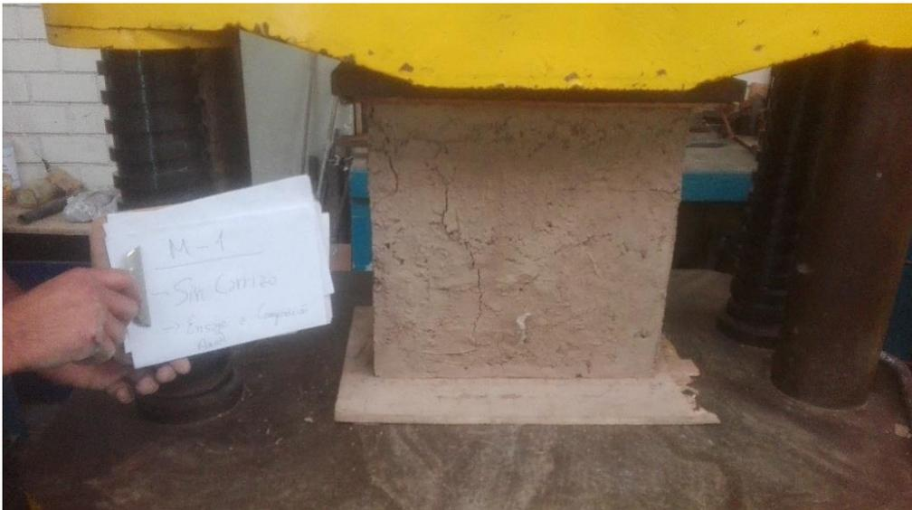
*Figura 130.* Muestra 1 sin refuerzo de carrizo después de la rotura a compresión axial
