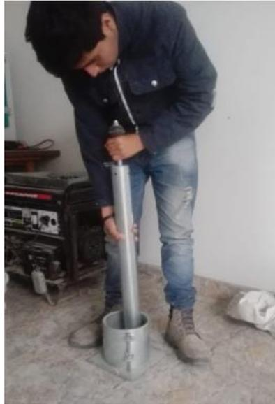
Figura 74. Golpes en molde de proctor modificado
