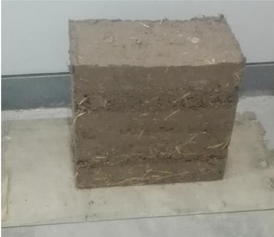
*Figura 125.* Se aprecia las capas del apisonamiento
