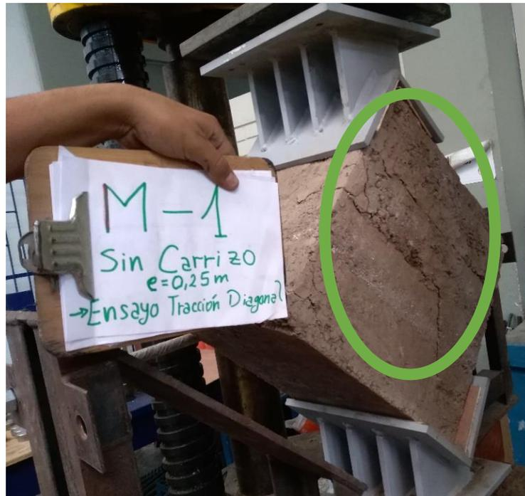
Figura 180. Primera muestra de tapial de  $e=0.25m$  después de la rotura por corte
