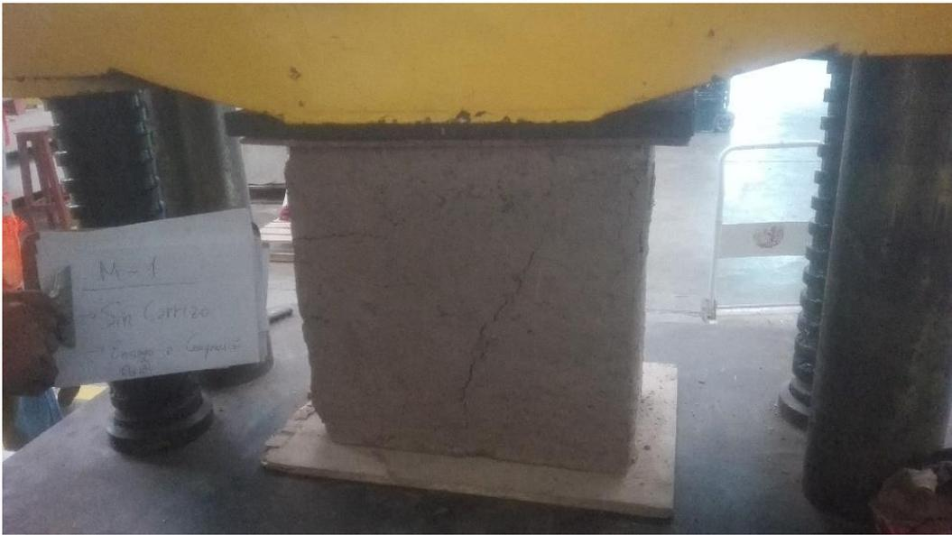
*Figura 129.* Muestra 1 sin refuerzo de carrizo antes de la compresión axial
