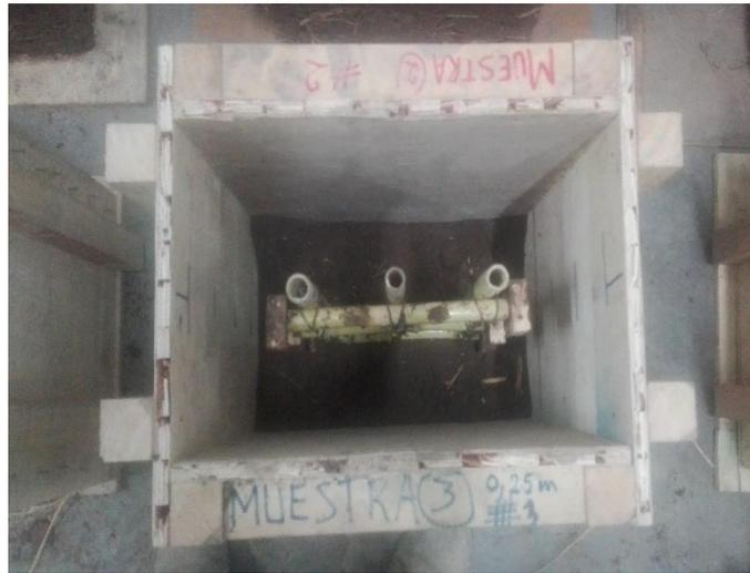
Figura 161. Introducción de malla N°3 en murete de  $e=0.25\text{m}$
