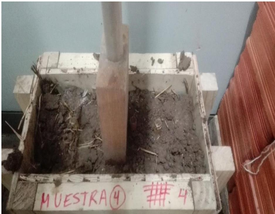
*Figura 120.* Se respeta el mínimo de espaciamento entre carrizos para el apisonamiento
