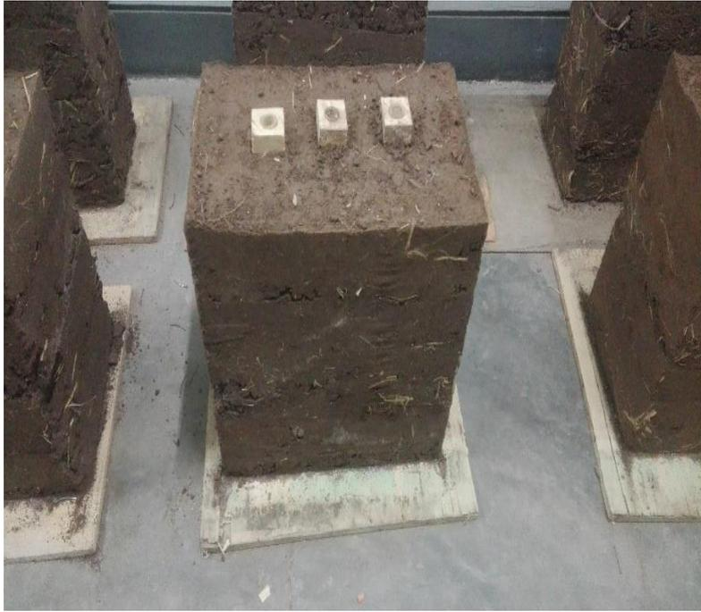
*Figura 169.* Se aprecia los tacones de madera de 20mm en la parte final del carrizo
