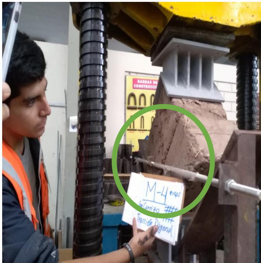
Figura 192. Cuarta muestra de tapial de  $e=0.25m$  después de la rotura por corte
