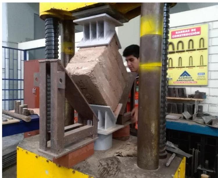
*Figura 186.* Alineación del murete y colocación de ángulos adicionales
