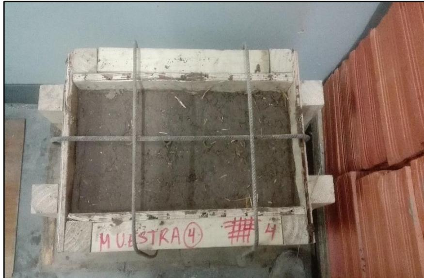
*Figura 121.* Colocación de acero de 3/8 para presionar el encofrado muestra 4
