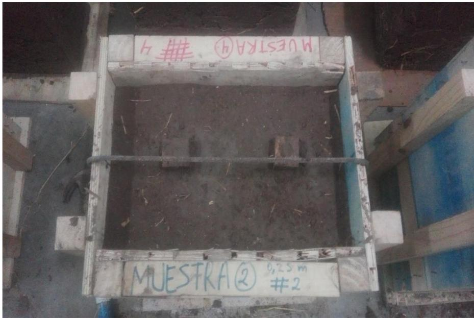
*Figura 160. Se aprecia los tacones de madera de 20mm en la parte final del carrizo*
