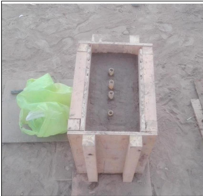
*Figura 88. Tapial con ancho de 20 cm con malla de #4 carrizos*
