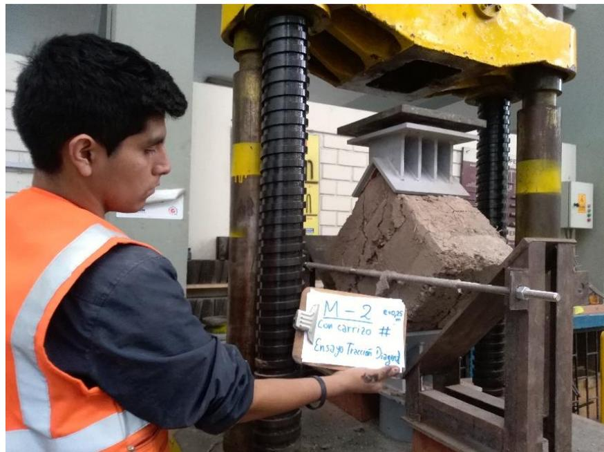
Figura 184. Segunda muestra de tapial de  $e=0.25m$  después de la rotura por corte
