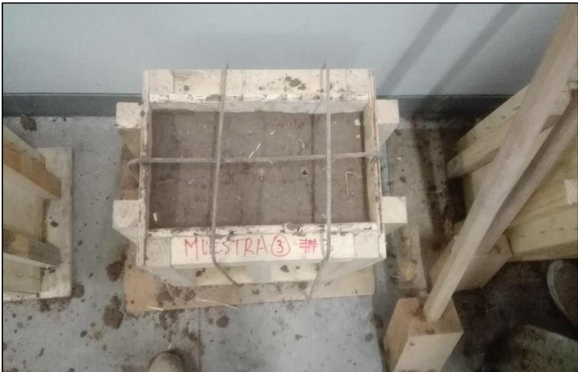
*Figura 116.* Colocación de acero de 3/8 para presionar el encofrado
