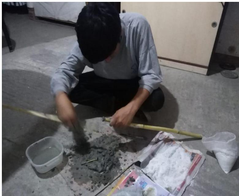
*Figura 44.* Introducción del cemento más yeso en el interior del carrizo
