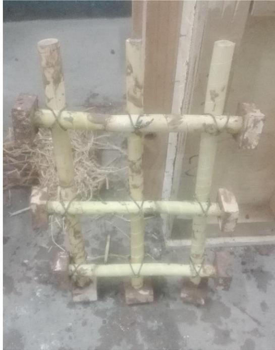
*Figura 153.* Malla de carrizo triple con tacones de madera
