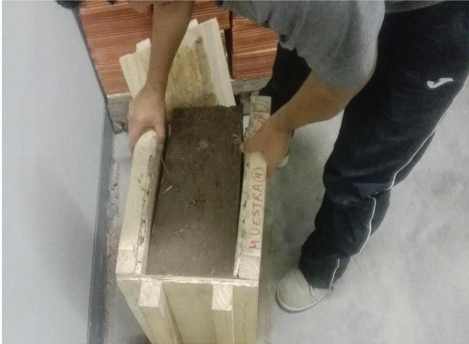
*Figura 123.* Retiro de las caras laterales del encofrado
