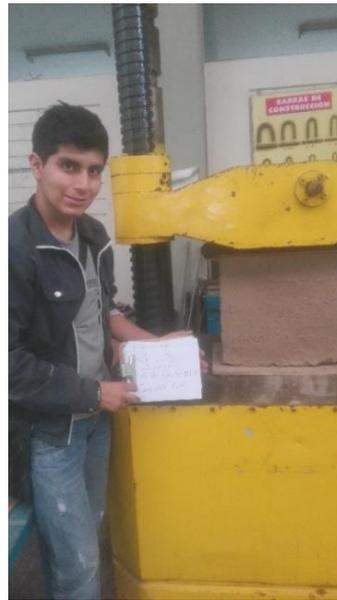
*Figura 133.* Muestra 3 con refuerzo de carrizo antes de la compresión axial
