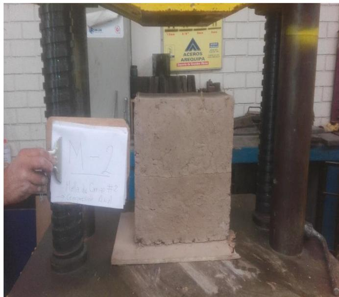
*Figura 131.* Muestra 2 con refuerzo de carrizo antes de la compresión axial
