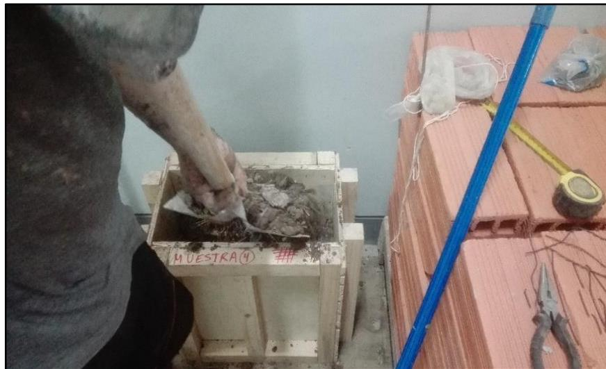
*Figura 117.* Vaciado de mezcla en el cuarto encofrado
