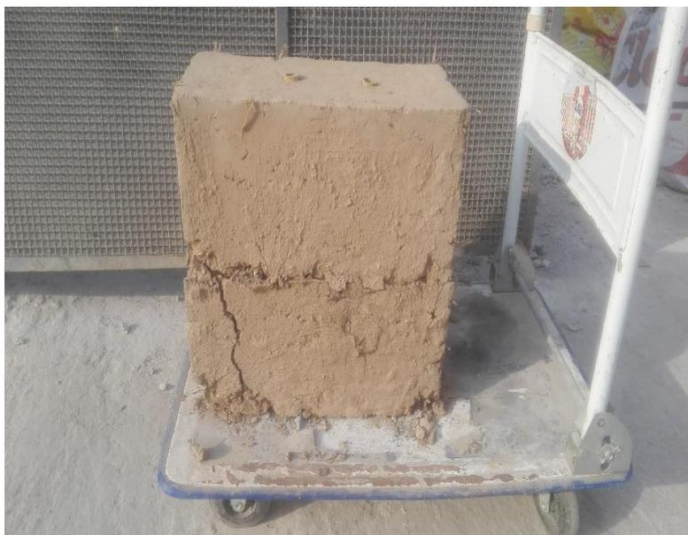
*Figura 138.* No colapso la muestra 2 de tapial por compresión axial
