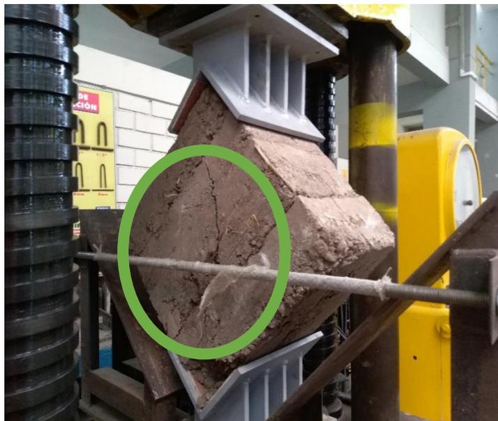
Figura 188. Tercera muestra de tapial de  $e=0.25m$  después de la rotura por corte
