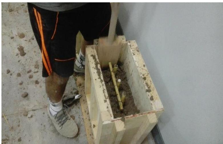
*Figura 114. Caída del mazo en 80 cm de la tercera muestra de tapial*
