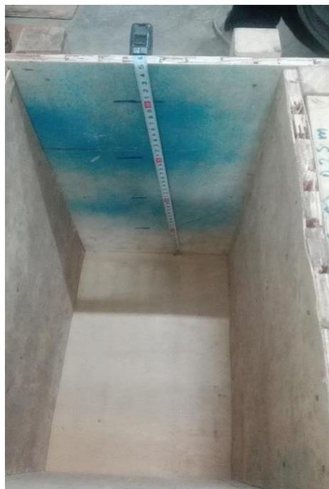
*Figura 142.* Señalización de las capas a compactar de cada 0.10m cada uno.
