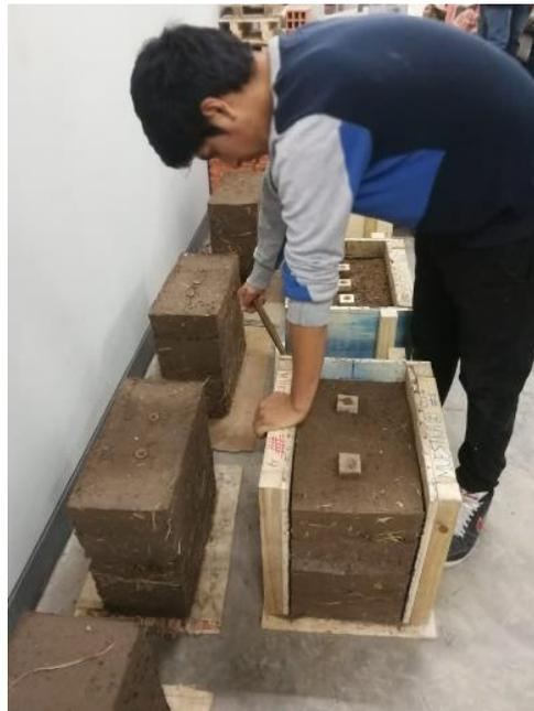
*Figura 167.* Se aprecia los tacones de madera de 20mm en la parte final del carrizo
