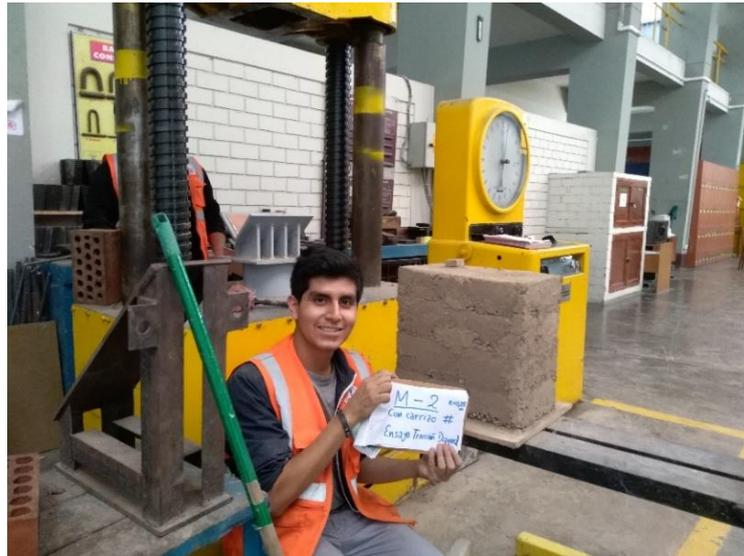
Figura 181. Colocación del murete en los ángulos con las piezas de triplay
