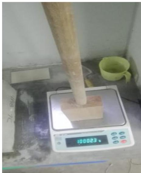
*Figura 38.* Mazón de 10 kg para la zona céntrica del murete de tapial
