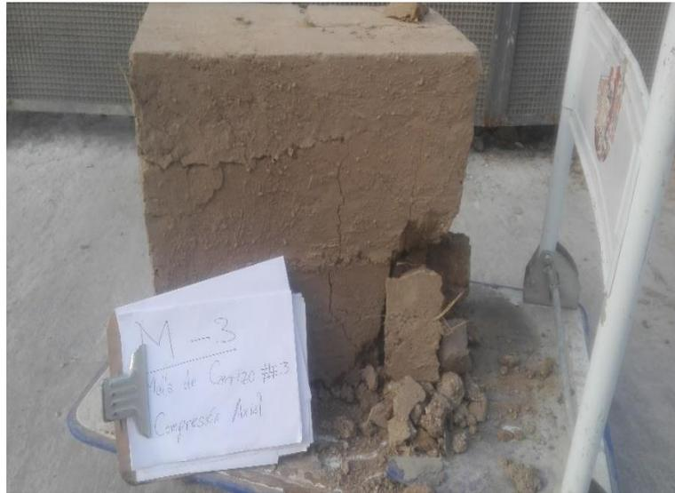
*Figura 137.* No colapso la muestra 3 de tapial por compresión axial
