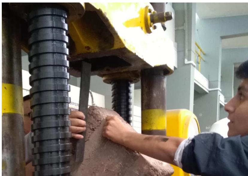
*Figura 190.* Alineación del murete y colocación de ángulos adicionales
