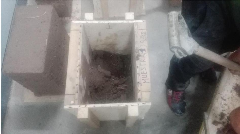
*Figura 155.* Vaciado de mezcla en la primera muestra de tapial
