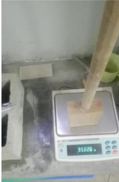
*Figura 39.* Mazón de 9,5 kg para la zona perimetral del murete de tapial
