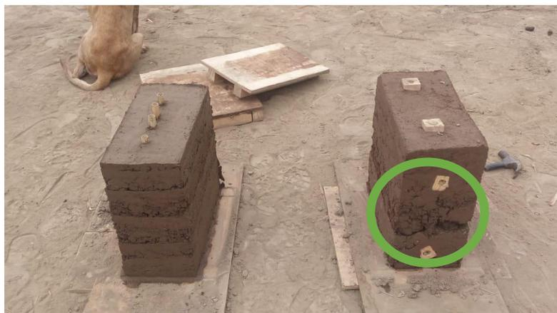
*Figura 94.* Falla presentada en la prueba 3
