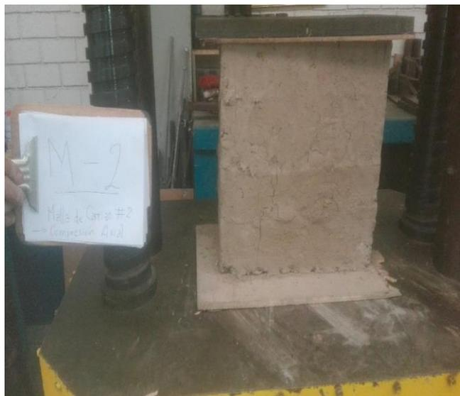
*Figura 132.* Muestra 2 con refuerzo de carrizo después de la rotura a compresión axial
