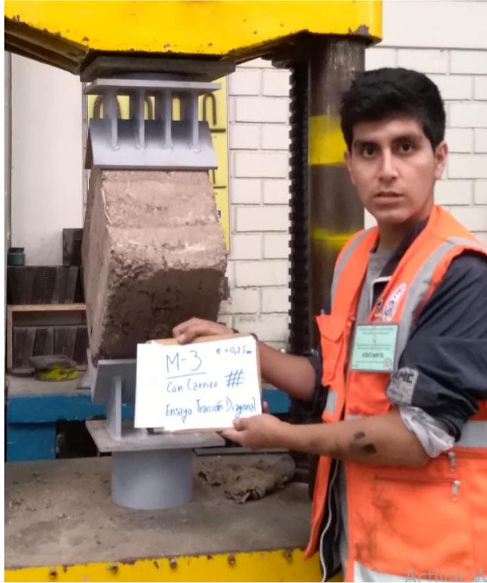
Figura 187. Tercera muestra de tapial de  $e=0.25m$  antes de la rotura por corte
