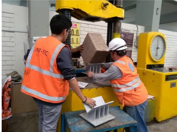
*Figura 177.* Colocación del murete en los ángulos con las piezas de triplay
