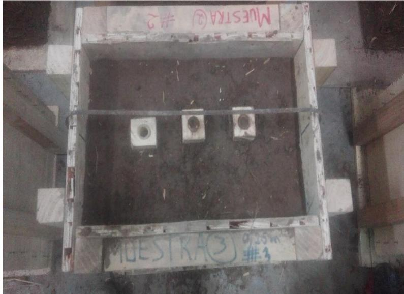
*Figura 163.* Se aprecia los tacones de madera de 20mm en la parte final del carrizo
