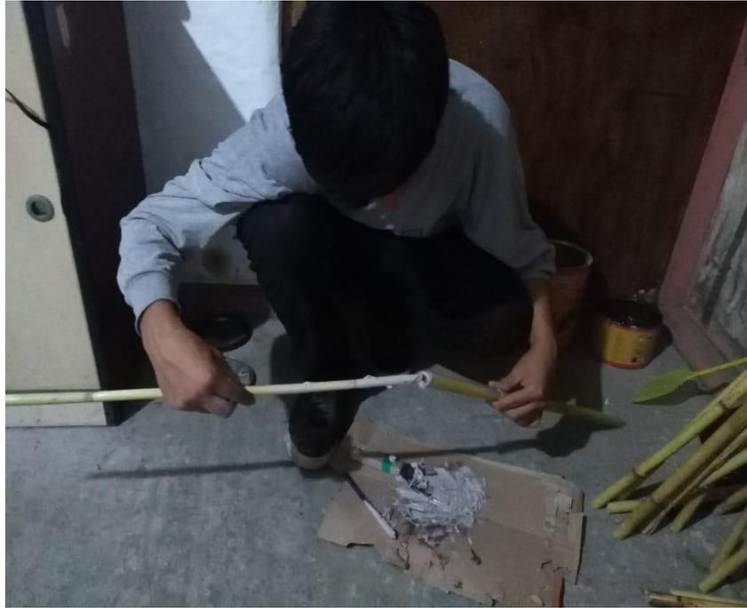
*Figura 43.* Introducción del epóxido en el interior del carrizo
