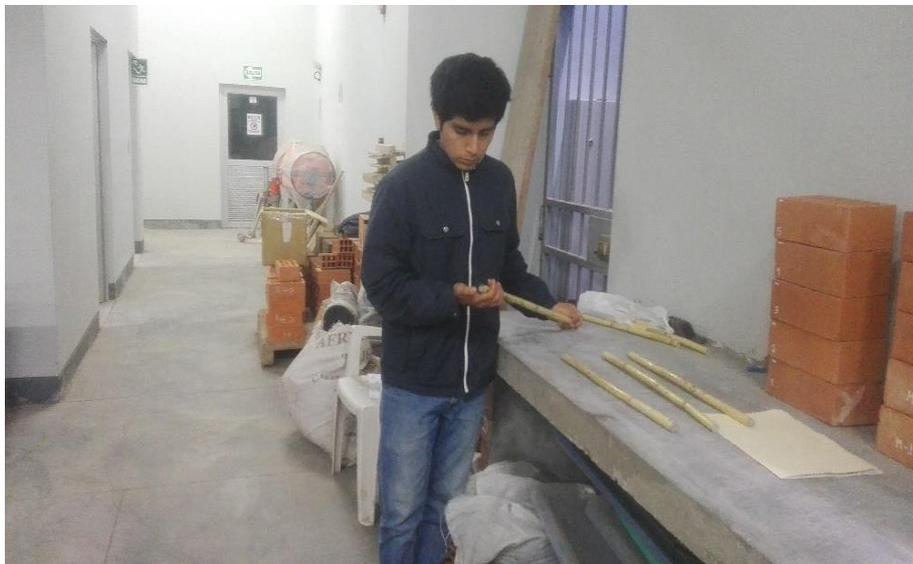
*Figura 50.* Verificación del secado de los carrizos después de las 48 horas.
