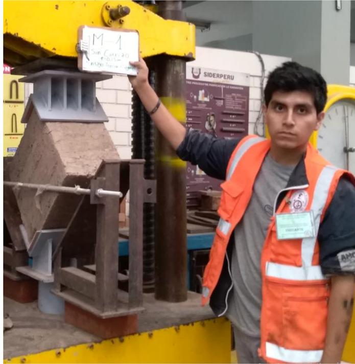
Figura 179. Primera muestra de tapial de  $e=0.25m$  antes de la rotura por corte
