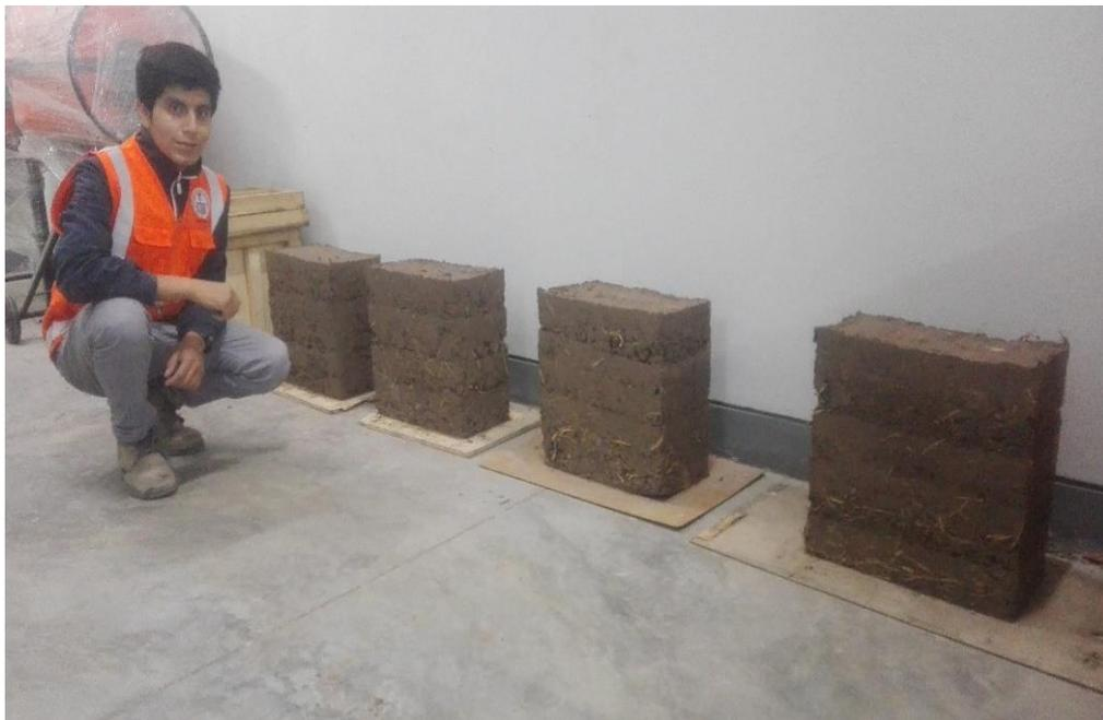
*Figura 126.* Desencofrado de muestras de tapial
