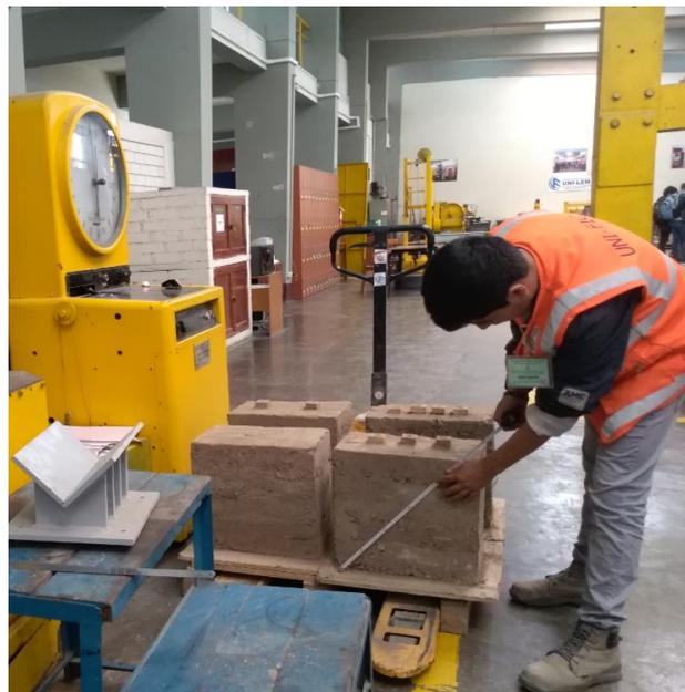
*Figura 174. Nivelación con sierra a la altura del tapial*
