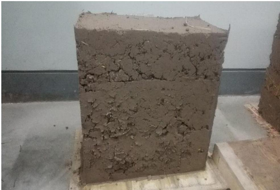
*Figura 124.* Se aprecia el tapial después del encofrado
