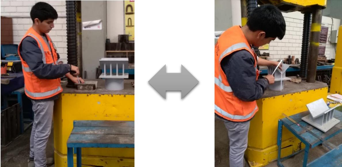
*Figura 175. Ángulos de apoyos para muretes en forma diagonal*
