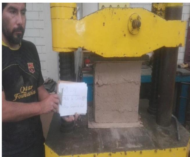
*Figura 136.* Muestra 4 con refuerzo de carrizo después de la rotura a compresión axial
