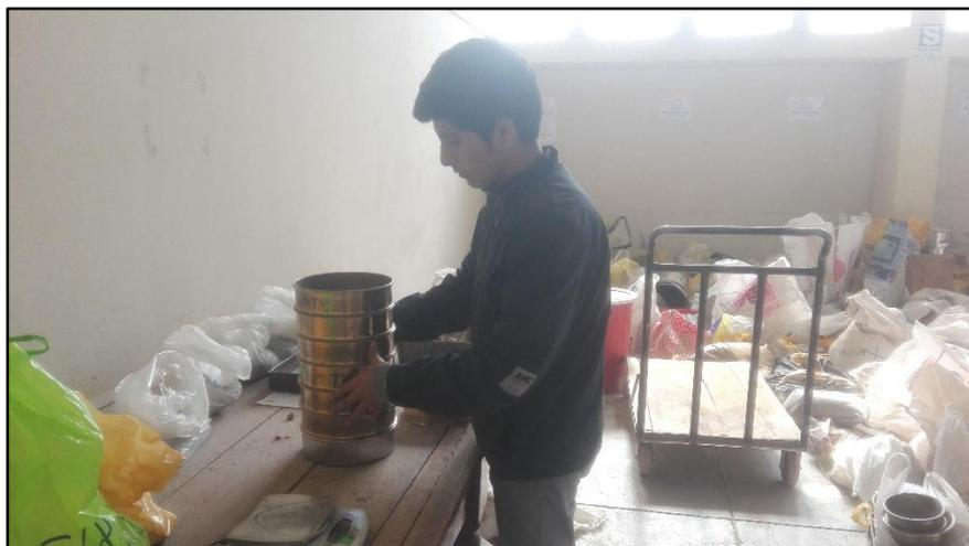
Figura 71. Ensayo de granulometría, Tamizando
