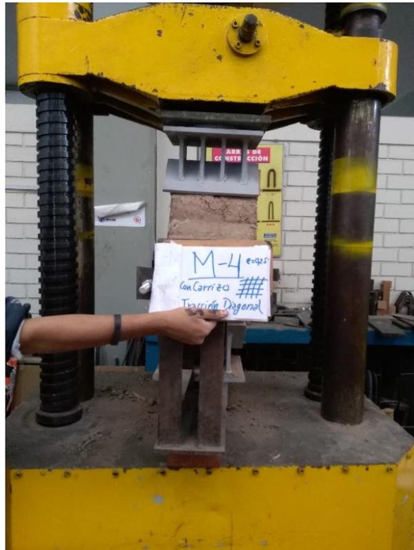
Figura 191. Cuarta muestra de tapial de  $e=0.25m$  antes de la rotura por corte
