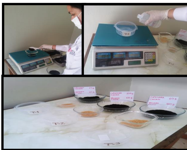
Figura 9. Pesaje cáscara de cacao, borra de café, elastómero de silicona y azúcar
