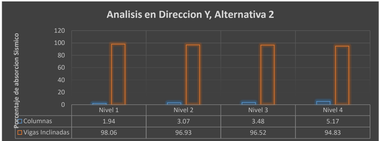
Figura 79: Análisis Comparativo - Porcentaje de absorción Sísmico dirección Y, Alternativa 2
