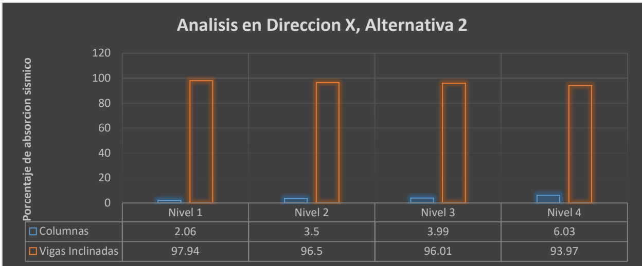
Figura 77: Análisis Comparativo - Porcentaje de absorción Sísmico dirección X, Alternativa 2
