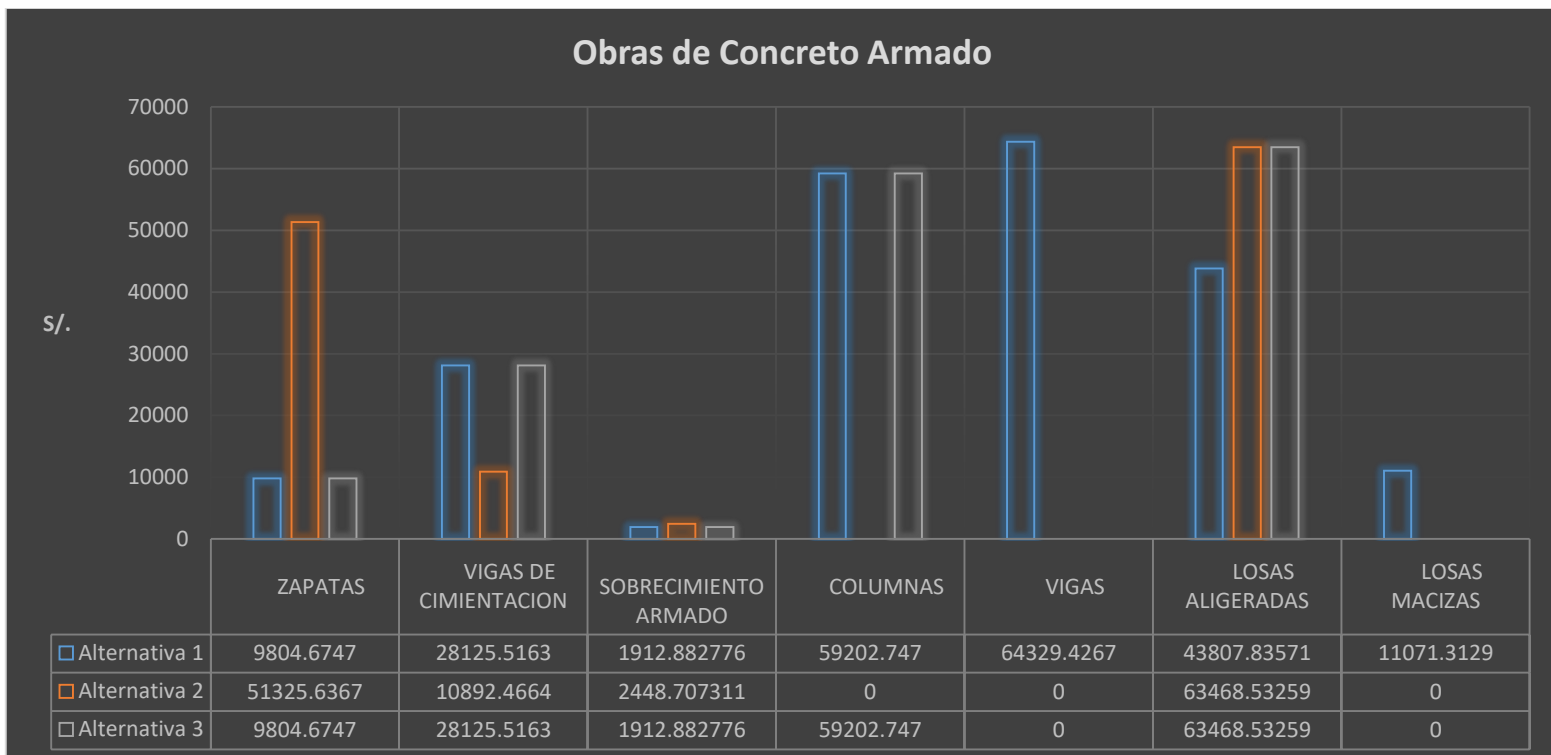
Figura 84: Analisis Comparativo - Obras de Concreto Armado
