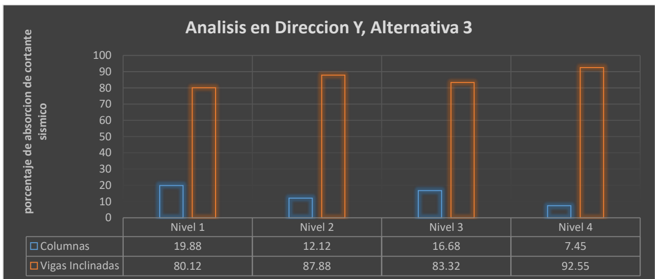
Figura 80: Análisis Comparativo - Porcentaje de absorción Sísmico dirección Y, Alternativa 3
