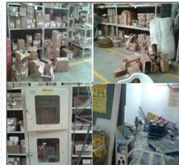
Figura 9: Antes de la aplicación de las 5s'. Almacén de lubricantes
