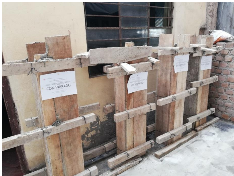
Fotografía 29.- Presentación de las columnas vibradas con su hoja de información Origen: Propio
