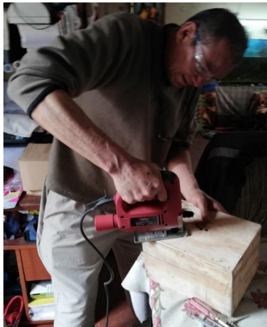
Fotografía 3.- Corte de caja para adaptación de la Toma eléctrica. Origen: Propio
