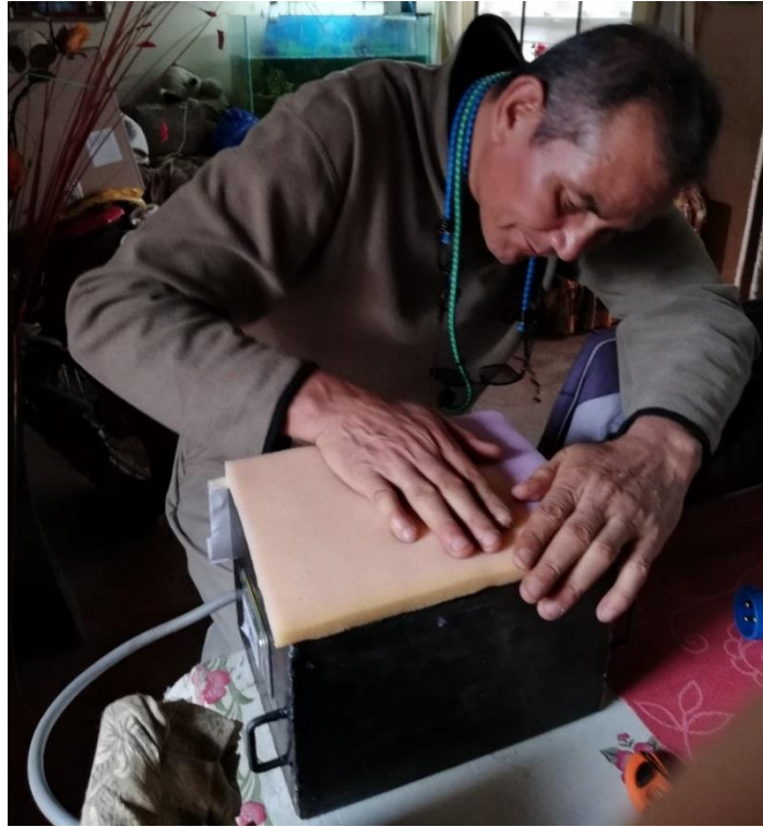
Fotografía 6.- Pegado de la Espuma absorbedor de vibración a la caja del motor vibrador Origen: Propio
