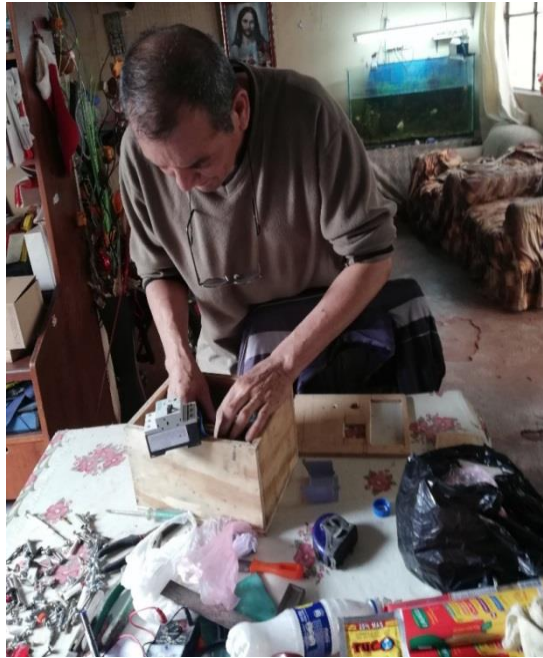
Fotografía 2.- Montaje de los Componentes Eléctricos y Electrónicos de la Caja de Comando. Origen: Propio
