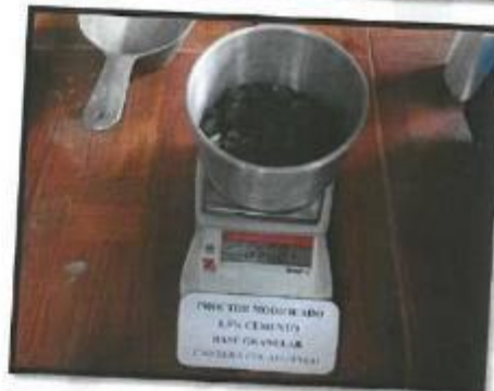
Proctor modificado (Base granular + 0.5% de cemento)
