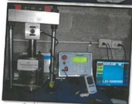
Equipo electrónico de ensayo a compresión (C.B.R.) – Sub base granular
