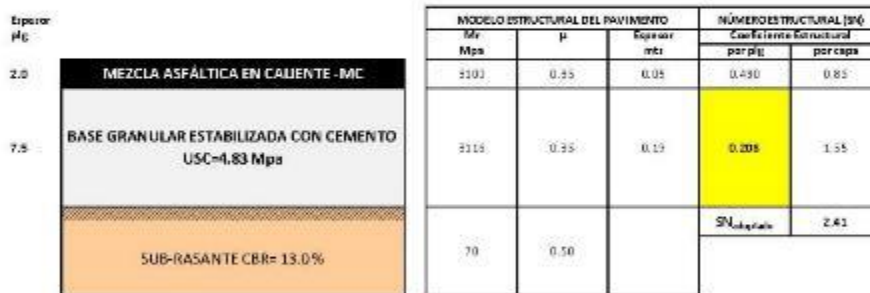
SECCIÓN TÍPICA DEL PAVIMENTO FLEXIBLE OPTIMIZADO CON SUB-BASE GRANULAR ESTABILIZADA CON CEMENTO ( C= 1.50 %)
