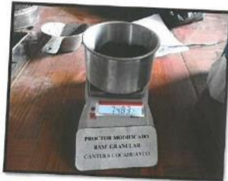
Proctor modificado (Base granular natural)
