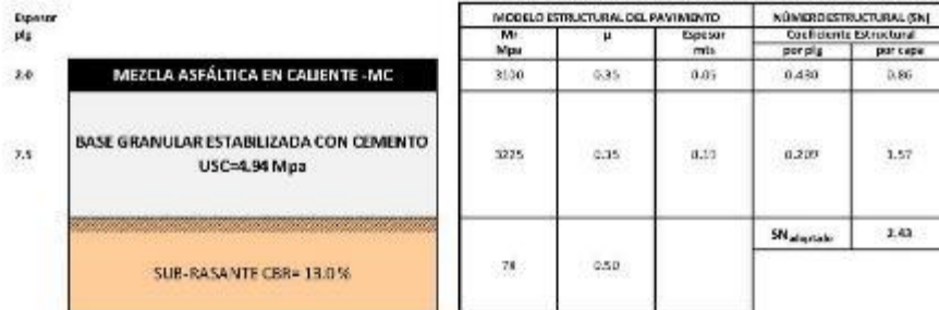
SECCIÓN TÍPICA DEL PAVIMENTO FLEXIBLE OPTIMIZADO CON BASE ESTABILIZADA CON CEMENTO ( C= 0.50 %)
