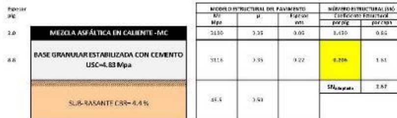
SECCIÓN TÍPICA DEL PAVIMENTO FLEXIBLE OPTIMIZADO CON SUB-BASE GRANULAR ESTABILIZADA CON CEMENTO ( C= 1.50 %)
