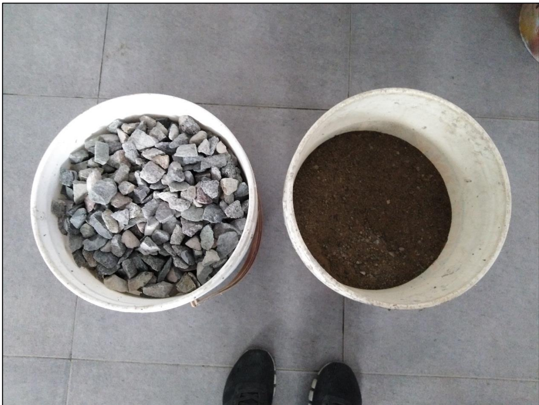
Figura. 39 Preparación piedra chancada y arena gruesa
