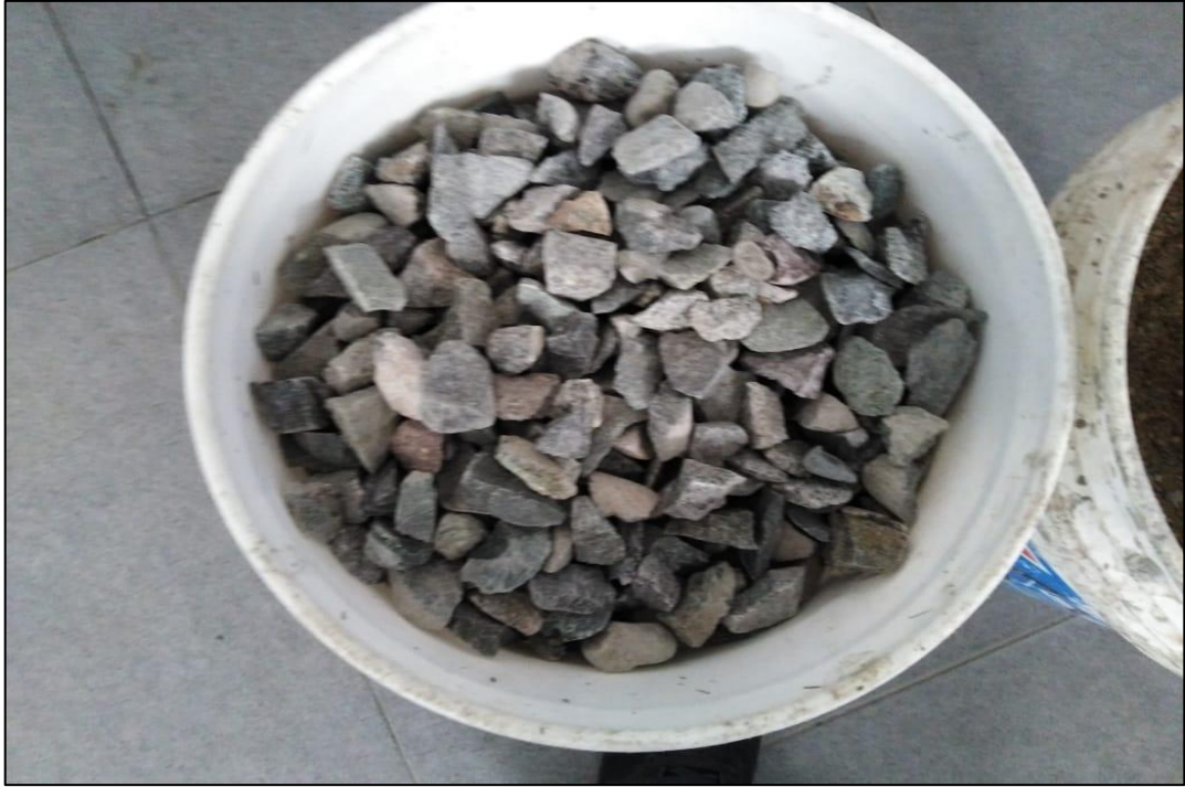
Figura. 38 Preparación de Agregado
