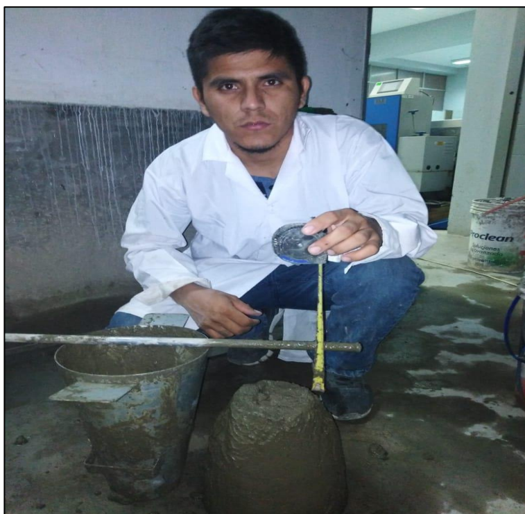
Figura. 5 Medición de Slump
