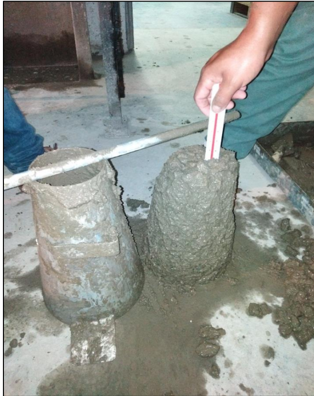
Figura. 44 Medición de asentamiento de concreto
