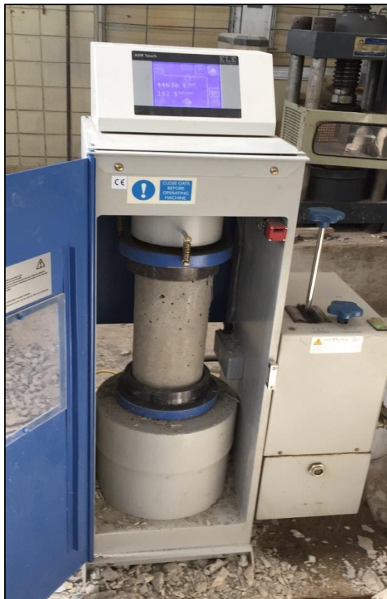
Figura. 51 probetas sometidas a compresión
