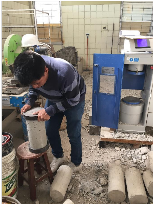
Figura. 53 Colocación de probetas para ensayo de compresión
