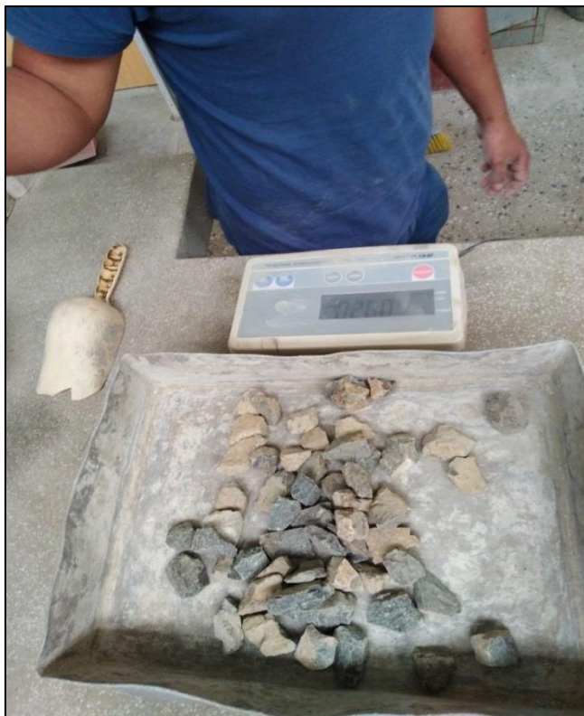
Figura. 31 pesado de piedra chancada
