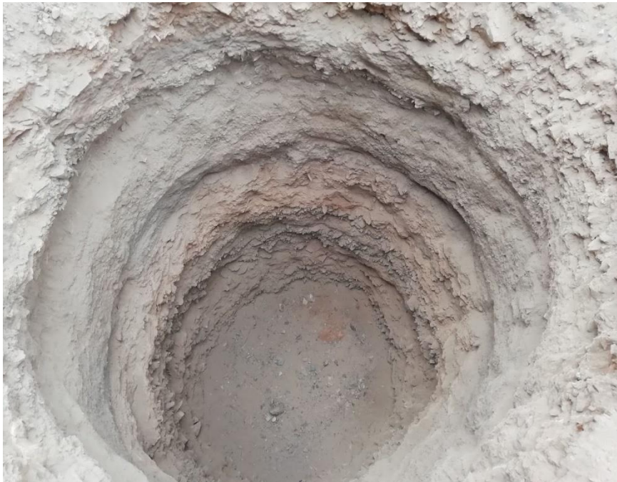
Figura13: Perfil Estratigráfico de la calicata a una H=3.00 m
