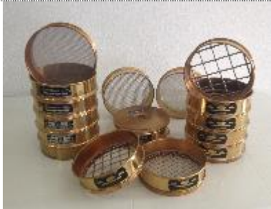
Imagen 4: Tamiz (determinar granulometría).
