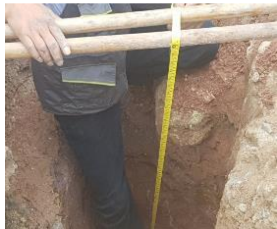
Imagen 23: Altura de la calicata 1.50 m.
