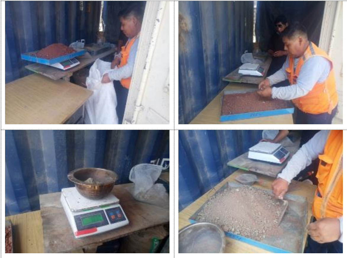
Imagen 29: Proceso de homogenización de la muestra (suelo - cemento)
