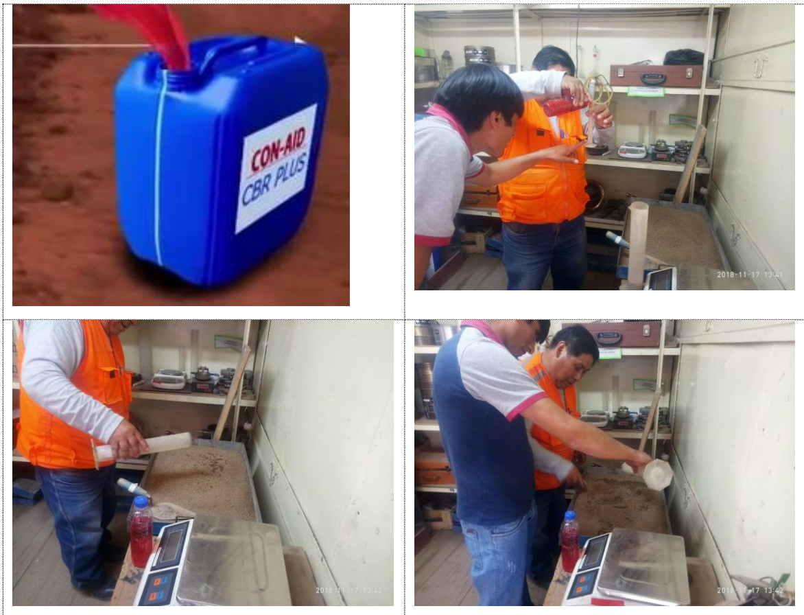
Imagen 31: Proceso de aplicación del CONA-ID al suelo – cemento.
