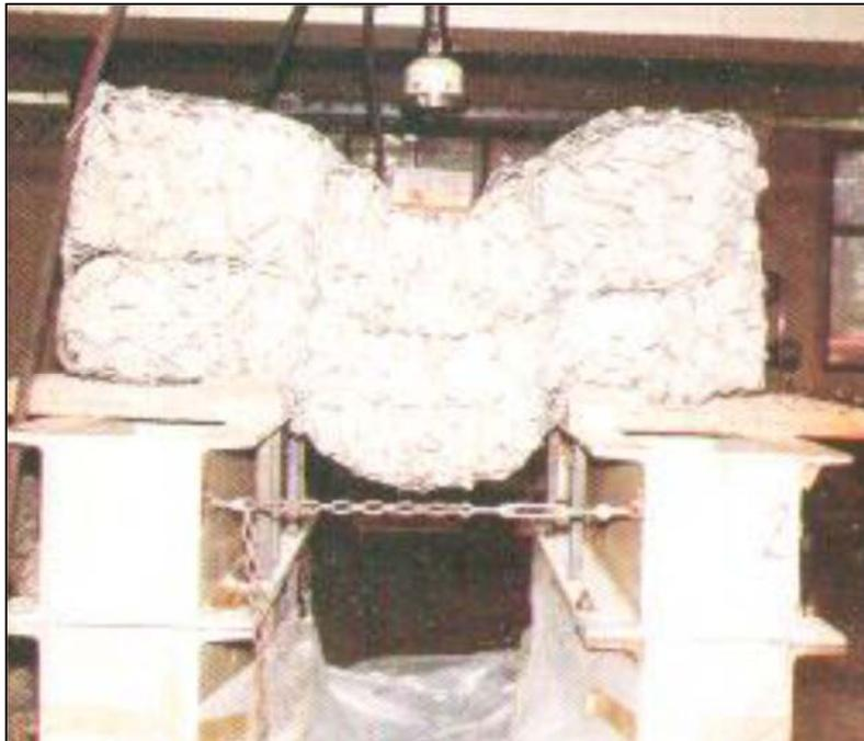
*Figura 29. Prueba de resistencia de los gaviones en la máquina de Los Ángeles. Maccaferri (2008).*
