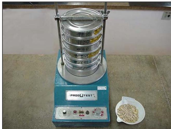
Figura. 12: Columna de tamices sobre la máquina de ensayo
