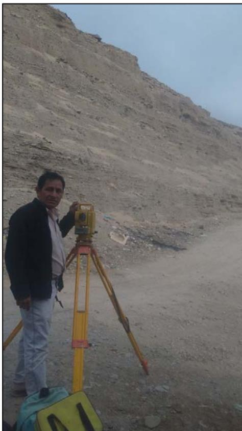
**Figura. 13:** Trabajos de campo. Levantamiento topográfico del talud en un tramo de 104.00 m. del margen derecho de la Avenida Víctor Malasquez Chacaltana, realizado el 27 de Octubre de 2018 cuya duración fue de 03 horas de trabajo.
