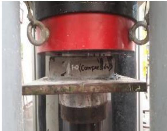
*Figura 3.* Ensayo de compresión para adoquines de concreto.
