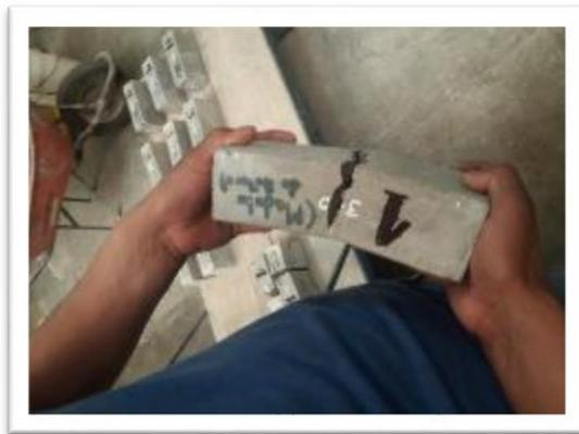
Imagen de adoquín expuesto a la resistencia del módulo de rotura (flexión)
