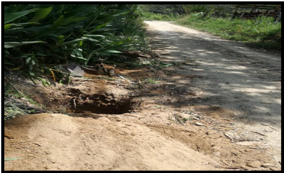
Figura 41. Calicata para la exploración de suelos
