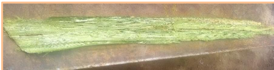
Figura 12. Extracción de fibra textil de residuos de hojas de piña de la variedad de Samba
