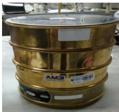
Imagen N o 3: TAMIZAJE DEL BAGAZO CON CONJUNTO DE TAMICES PARA OBTENER UNA GRANULOMETRIA DE 150 \mu m
