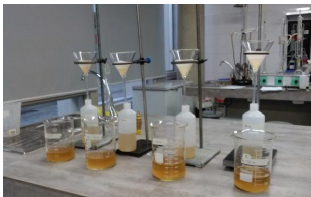
Imagen Nª 12: AGUAS FILTRADAS DESPUES DEL TRATAMIENTO (1 g) PARA SU POST ANALISIS POR METODO DE ESPECTROFOMETRIA DE ABSORCION ATOMICA (mg/L)
