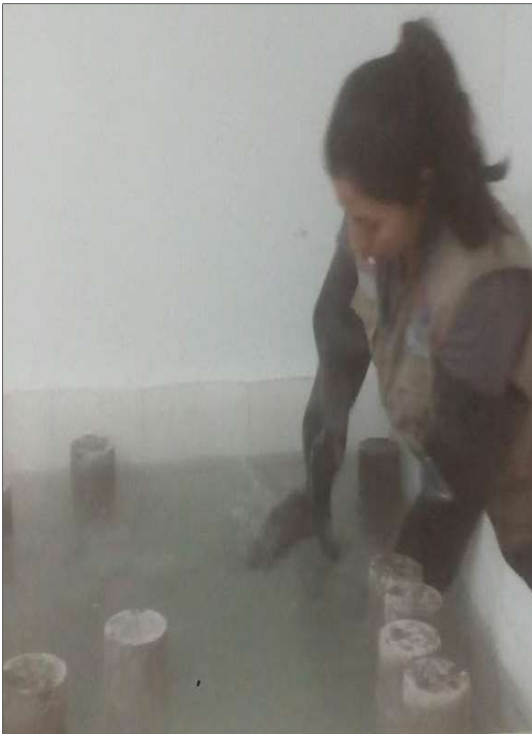
Foto 3. Colocación de probetas en la poza de curado Foto
