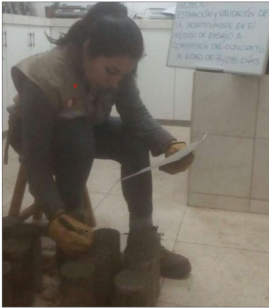
Foto 1. Desmolde de probetas
