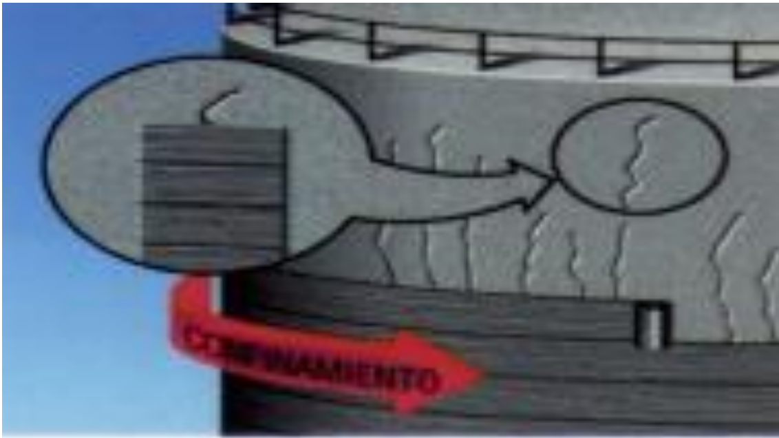
Figura 9. Reforzamiento estructural especial con láminas de fibra de carbono. Fuente: Youtube.
