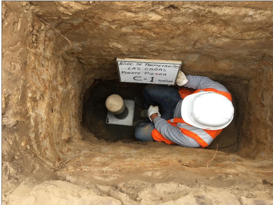
Foto 6. Cálculo de la densidad en el sitio con el método del cono de arena.
