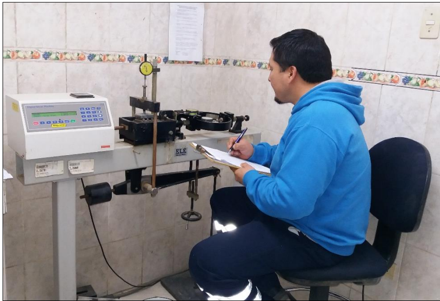
Foto 12. Ensayo de corte directo
