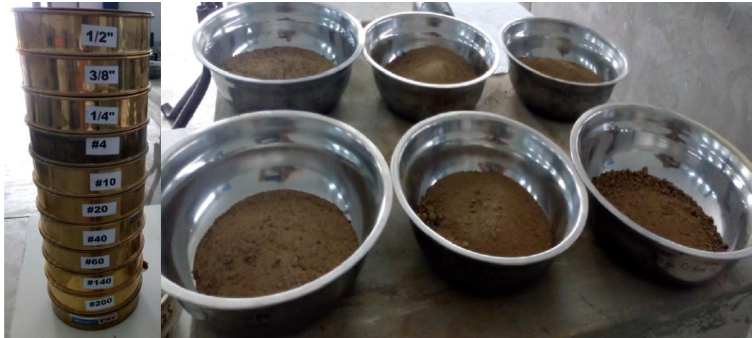
Figura 14: Ensayo de granulometría.
