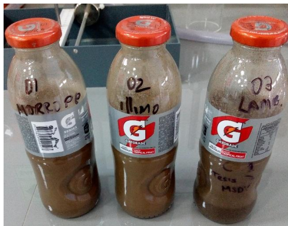
Figura 24: muestras para ensayos de sales solubles Fuente: elaborado por el investigador.
