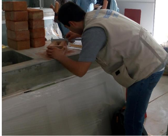
Figura 22: ensayo de variación dimensional Fuente: elaborado por el investigador.
