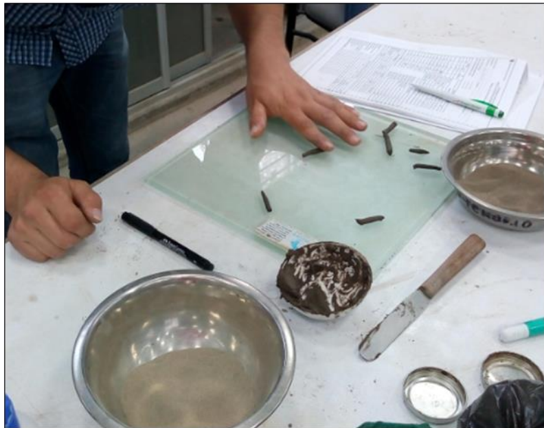
Figura 16: Ensayo de limite plástico.
