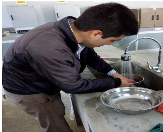
Figura 23: lavado de muestras para ensayo granulométrico Fuente: elaborado por el investigador.
