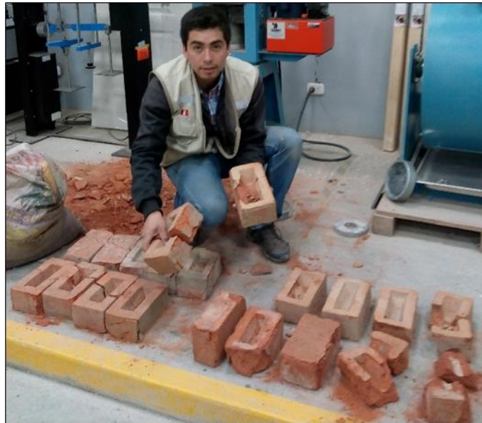
Figura 2: Ensayo de resistencia a compresión de unidades de albañilería.
