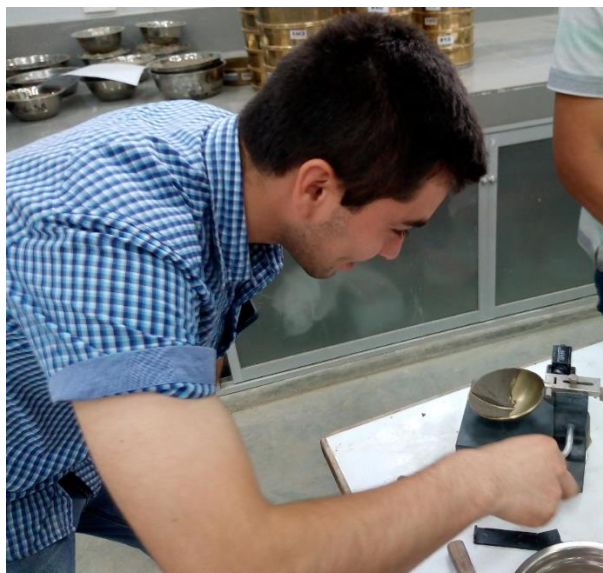
Figura 15: Ensayo de limite líquido.
