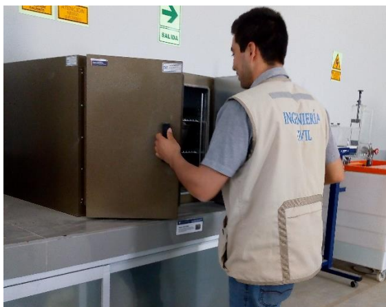
Figura 21: secado de las muestras en horno. Fuente: elaborado por el investigador.
