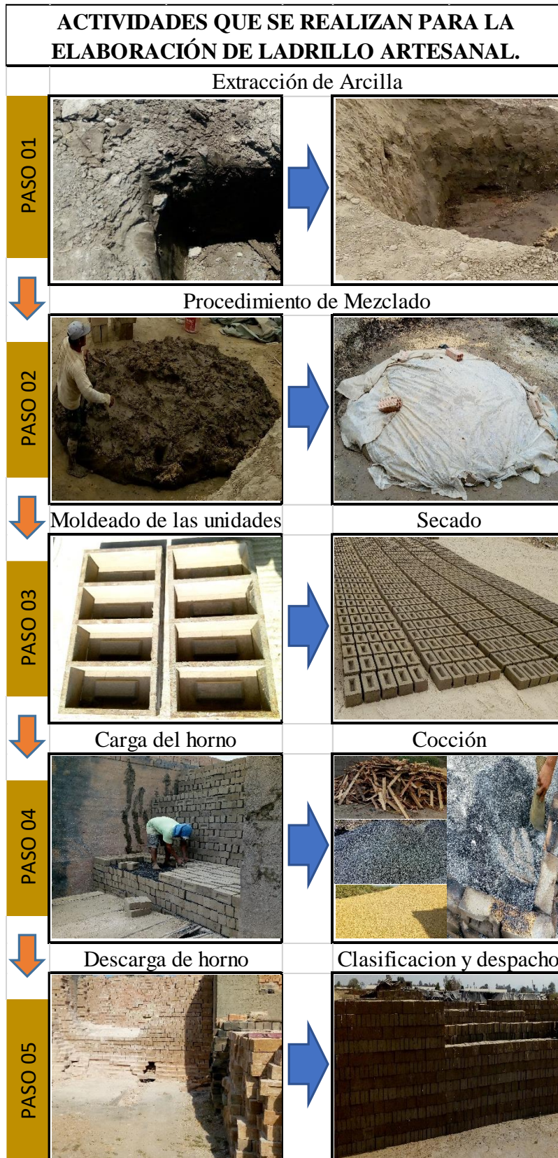
Figura 18: Producción de unidades de Albañilería artesanal.
