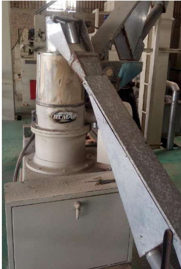
Figura 15. Pulidora abrillantadora de la empresa Agromolinos Industriales Anderson E.I.R.L.
